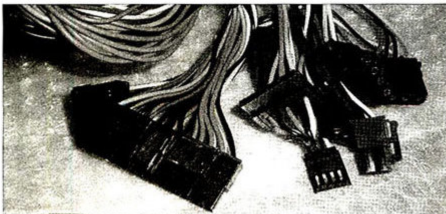
ATX12V 2.2版电源的输出接口，注意主电源接口，它实际上是由原来的20Pin加上一个4Pin接口组成的。
