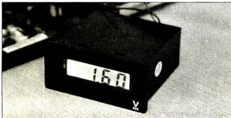
▲ 电压测试设备显示，内存实际工作电压只有1.6V。
