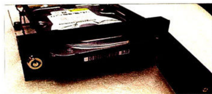
可拆卸式的托盘结构,让支持热插拔的SATA硬盘更加节能,即插即用不影响用户访问数据。
