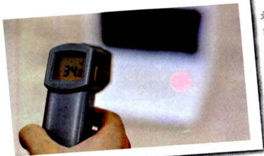
用测温枪测试机身7处温度,以求尽量全面展示机器散热效果。
