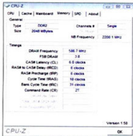
▲ 超频至DDR2 1172后的延迟时序 ▲ elixir DDR2超频王的SPD信息
