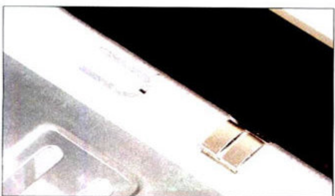
▲ 遍布机箱两侧面板内部的EMI弹点在一定程度上使得机箱的密合度大大提高, 减小了电磁辐射外泄的可能。
