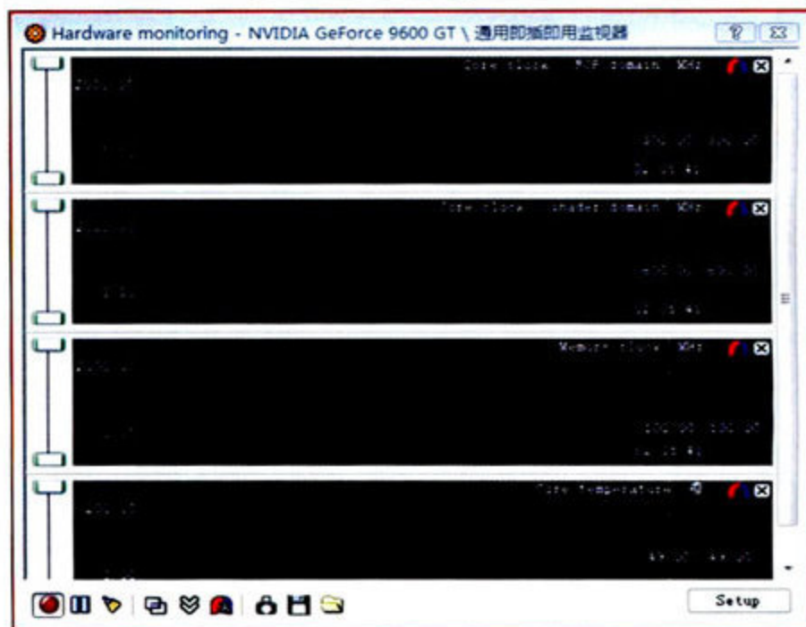
▲部分 GeForce 9600 GT绿色节能版显卡在待机状态时,频率会下调至300MHz/200MHz/600MHz
