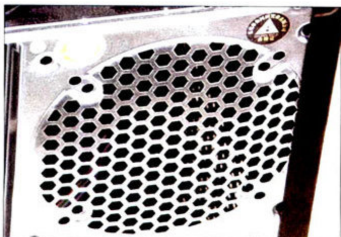
▲ 机箱风扇等位置都采用了蜂窝状开口设计, 直径远小于7mm, 因此不会引起电磁外泄。
