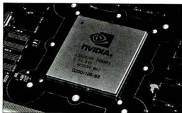
GeForce GTX 275的核心代号为“G200-105-B3”
