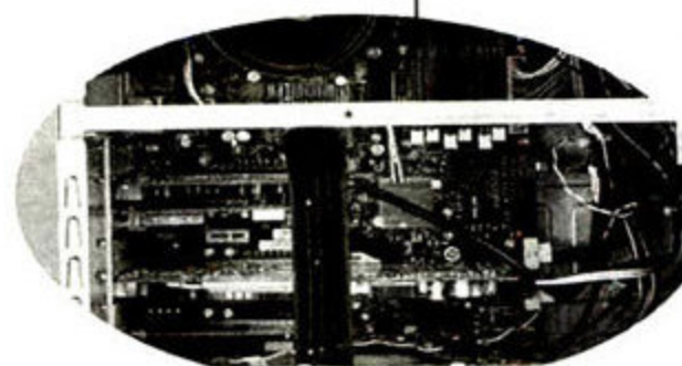
> 机箱内部的防撞条在戴尔的产品上广泛运用,横贯前后的防撞条不仅可以抵御来自侧面的撞击,还有效地增强了机箱的刚度,使箱体更加稳固。防撞条的中间部位还设置了一个塑料支撑构件,可防止显卡PCB板的形变。
