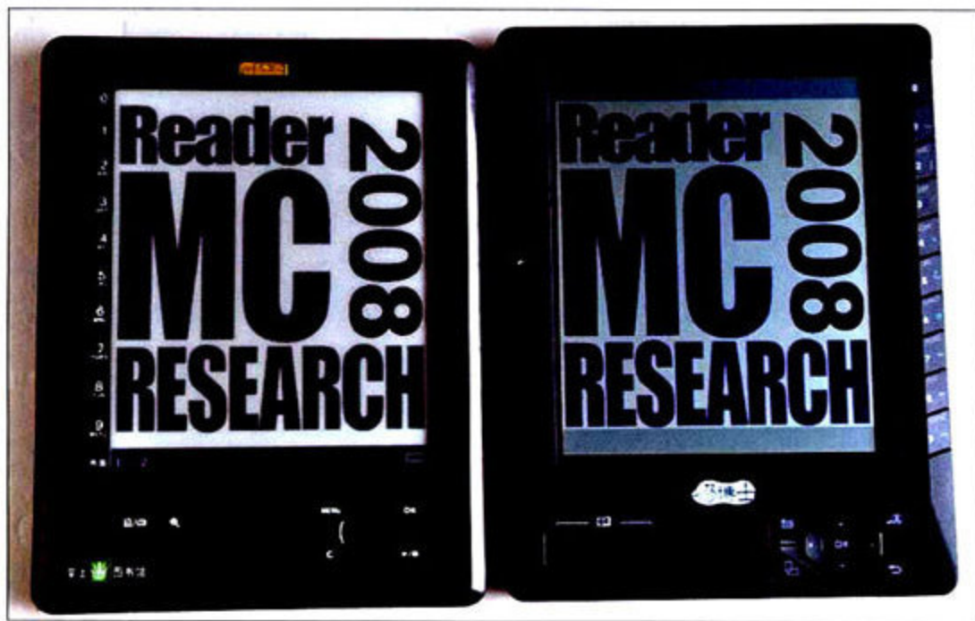
汉王N516与易博士M218B的屏幕对比(白底E-Ink屏幕与灰色E-Ink屏幕)
