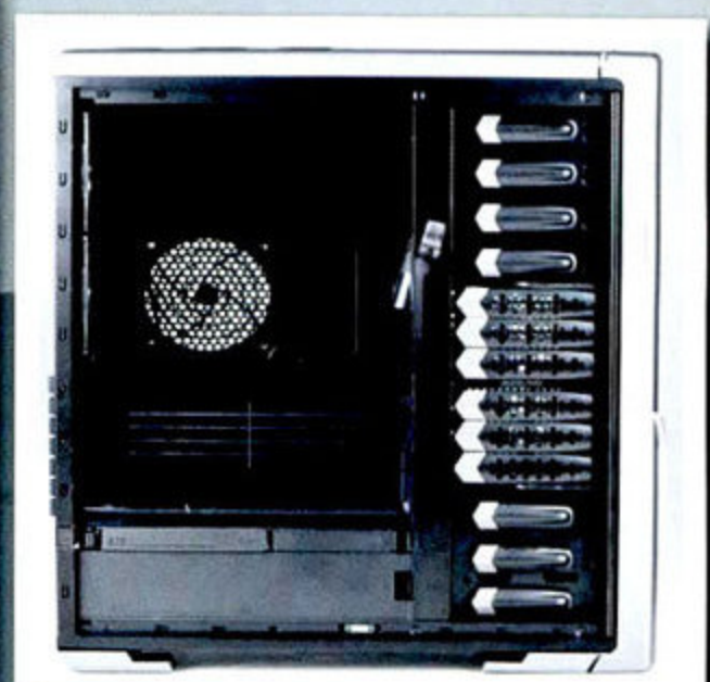
■ 从图中我们可以看到, 通过一个隔断, 主板和CPU部分被单独隔离出来。为了保证散热, 该机箱还在正对CPU位置设计了一个风扇。
