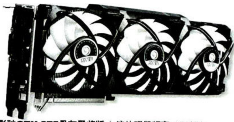
影驰GTX 275骨灰黑将版 流处理器频率: 1475MHz 核心频率: 648MHz 3DMark Vantage High得分: H8734 显存频率: 2400MHz 价格: 1899元
