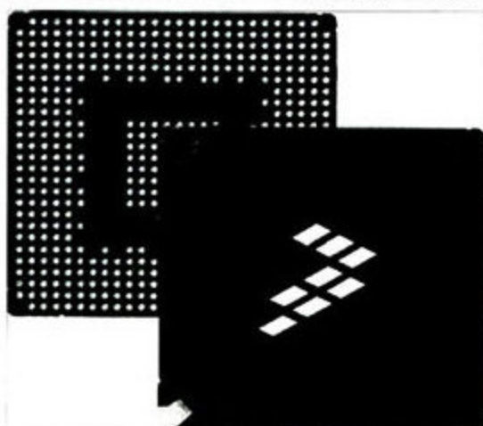
图8 i.MX51处理器芯片，它整合了完整的计算功能，且具有低成本的优势。
