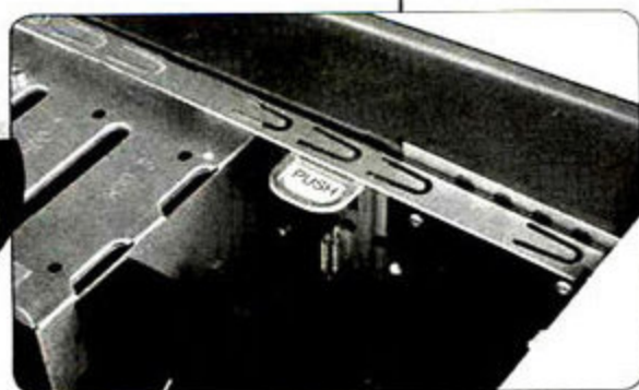
> 此外,前面板的拆卸非常简单,按下机箱与塑料前面板交接处的“PUSH”按钮即可将前面板与机箱分离,玩家想要对光驱、硬盘等配件进行升级和调整十分方便。
