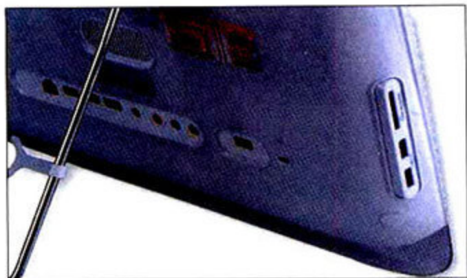
▲ 后部和侧面提供了丰富的USB 2.0接口、读卡器、网卡接口和音频接口。
