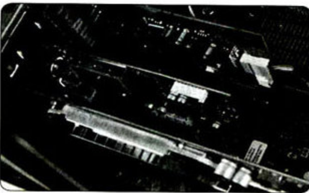
> 声卡、电视卡和显卡占据了大量的扩展插槽
