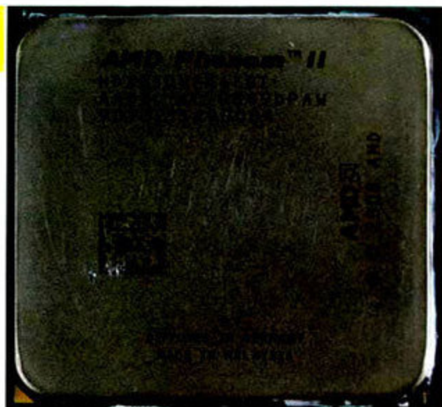
该处理器支持由SSE4.1而来的SSE4A指令集, 同时二级缓存采用16条链路连接。
