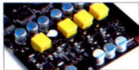
3+1相供电设计,每相核心搭配3个一进两出的MOSFET,显存供电搭配3个MOSFET。
