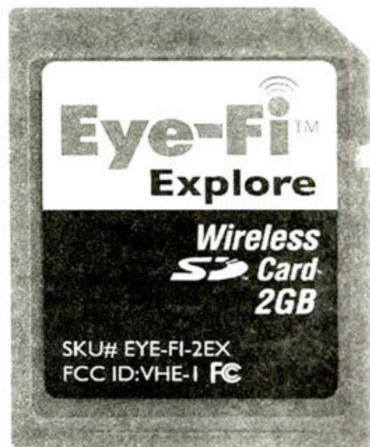
图2 EYE-Fi卡让SD卡也实现了无线传输功能
