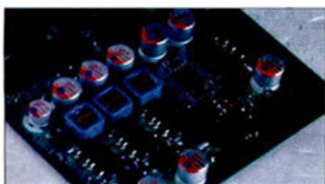
➤ 3+1相供电设计, 每相核心供电搭配了3个MOSFET。
