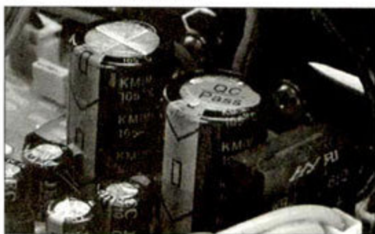
▲ 两颗4700uF容量的滤波电容
