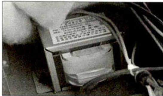
▲ 输出功率为60W的方形变压器
