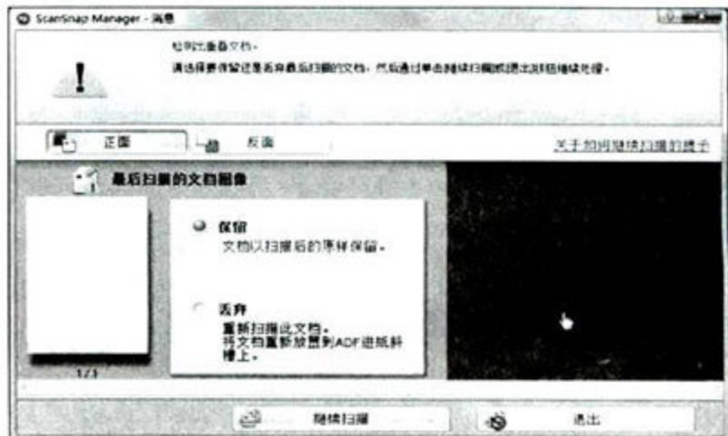
实际测试中, S1500可以准确检测出被胶水粘在一起的两页A4文档, 并且提供了保留已扫描页面的选项。
