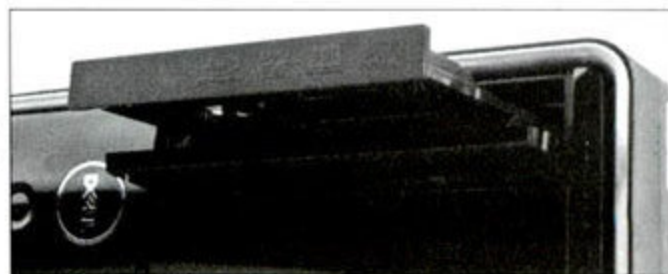
▲ 送测的戴尔INSPIRON 546s电脑搭配了BD COMBO光驱，支持2X BD读取和16X DVD刻录。
