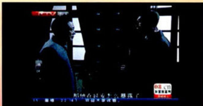
DVB-T信号电视画面, 由于信号是4:3的格式, 因此在全屏模式下显示屏画面两边有黑边。
