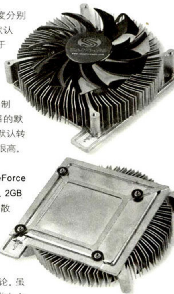
▲ 散热器的结构,其中和GPU相接触的真空腔均热板底座是散热器具备高散热性能的关键元件。
