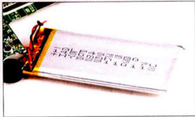
样机的电池容量为1450mAh,可持续播放视频约4小时左右,正式上市的产品将采用容量为1800mAh的电池
