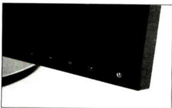
隐藏在边框内的感应式按钮,只有在操作的时候亮起
