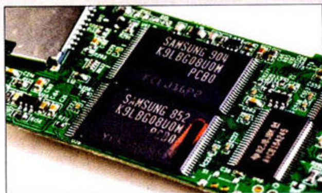
内置两颗编号为K9L BG08U0M的三星NAND闪存颗粒,总容量为8GB。T10的外围芯片相对较多,如果都用传统封装的话很难集成进这么小的空间内,BGA封装相对占用空间少,而且发热量低,可以实现更高频率
