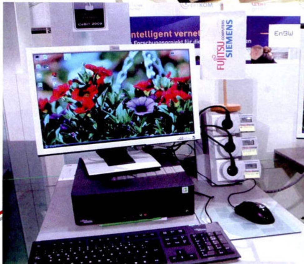
↑ 富士通西门子的工业型节能电脑，在待机状态下的功耗为0W，支持能源之星5.0标准，电源转换效率高达89%，而且通过ECO功能可以节省最高50%的电能。
