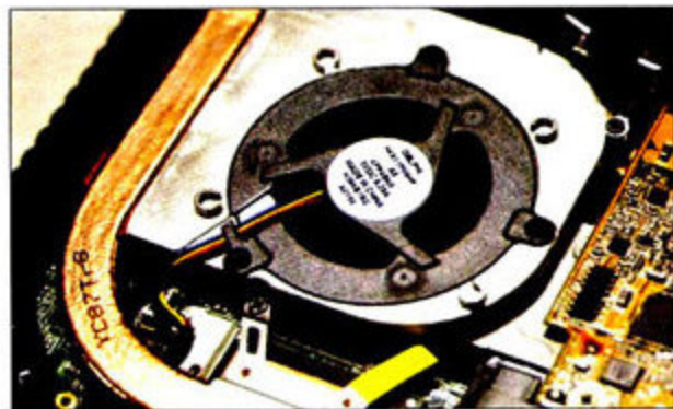
采用涡轮散风扇的散热器, 性能还是非常不错, 当然这跟底部的优秀风道设计也不无关系。
