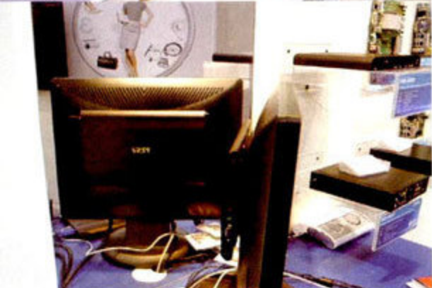
↑ 定位偏向于工业用途的微星迷你电脑，相当纤薄，整个机身外壳就是一个大散热片，而且可以挂在显示器背部，完全不占用地方。
