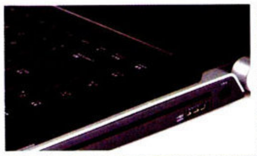
■ 采用吸入式光驱设计, 因此不能读取小尺寸光盘。
