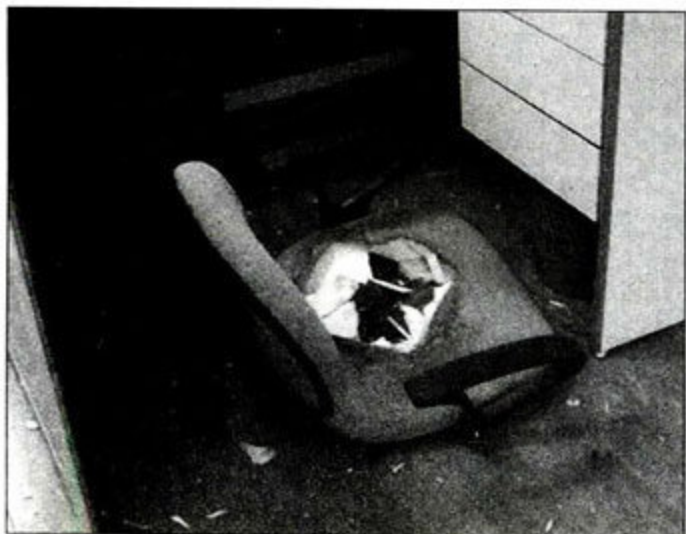
网络上关于“杀人椅”的图片，从纷飞的木屑，我们不难想象出气撑杆爆炸时的威力有多大。
