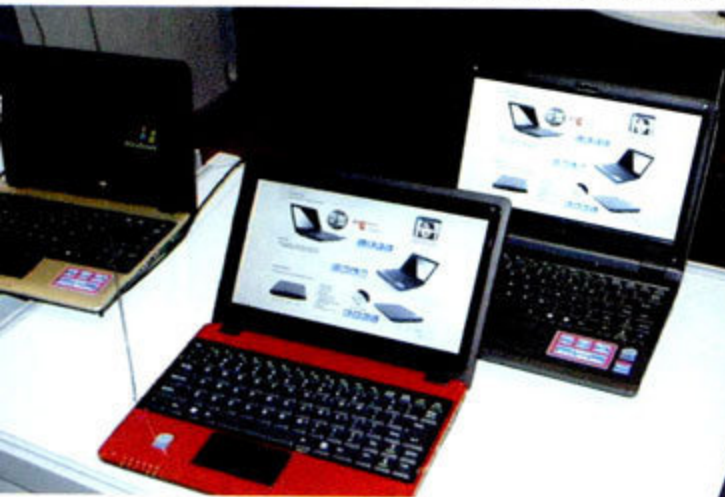
这三款内置拉杆伸缩天线的超便携电脑，与其它同类产品相比最大的特点在于内置了泰景信息科技有限公司 TLG2300电视接收芯片。该芯片是全球首款DVB-T和模拟电视二合一的接收单芯片，因此不论身处正在向DVB-T过渡的国家，还是近期内不会进行电视数字化转换的国家，采用了该芯片的NetBook都能真正做到随时随地免费看电视，对国内很多还没有条件接收移动数字电视信号的用户来说尤其值得期待。
