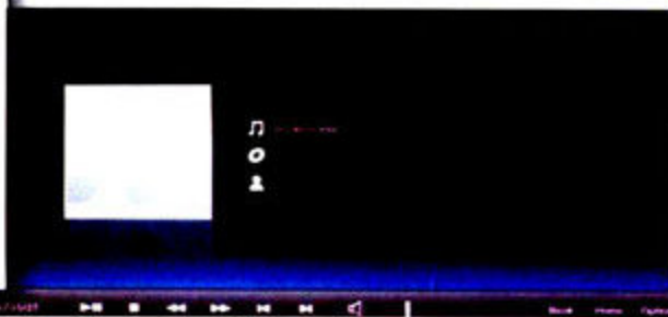
音乐播放界面, 只能够进行播放控制调节与播放模式调节, 没有EQ调节选项与曲目管理
