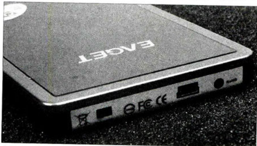
在提供了USB接口的基础上,好的移动硬盘一般都提供有额外的电源接口,以防供电不足的情况发生。
