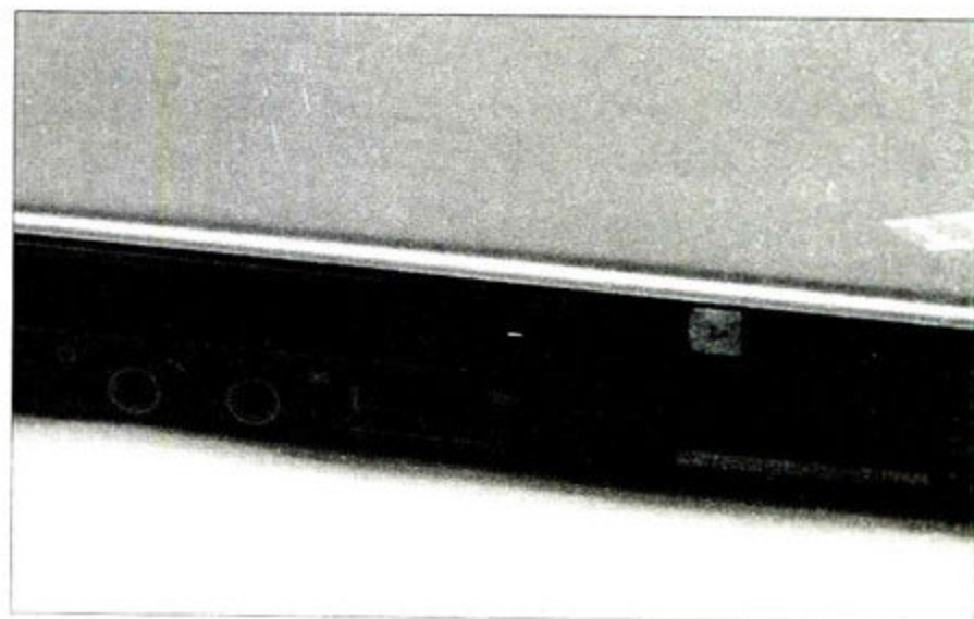
图3 Thinkpad的高端Z系列和T系列几乎都使用了钛合金材质顶盖
