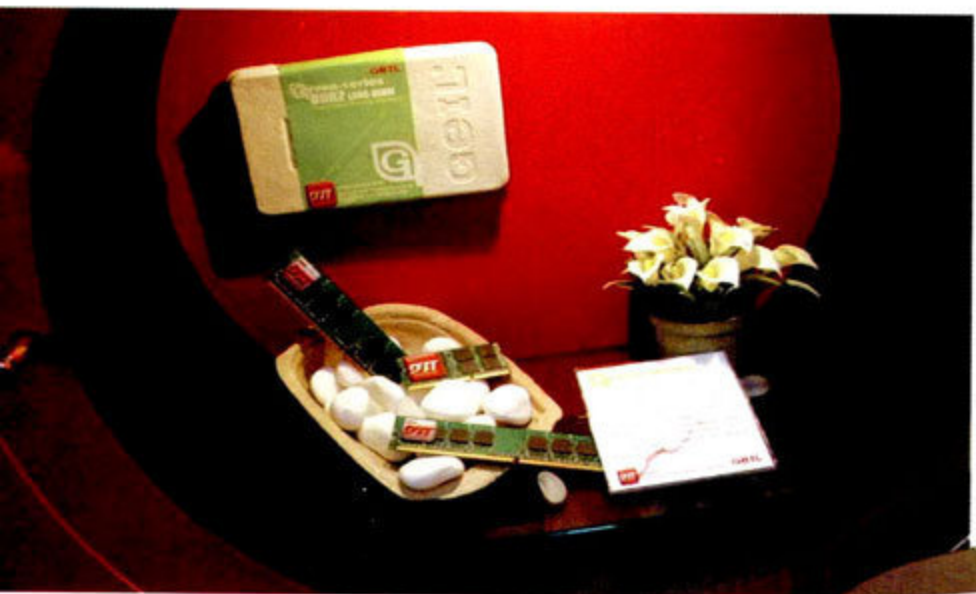
↑ 环保概念确实已经深入人心，金邦就推出了绿色（Green）系列DDR2内存，包括台式电脑和笔记本电脑两个平台，电压从标准的1.8V下降到1.5V，配套的主板据说正在研发之中，相信不久之后就能看到实物。
