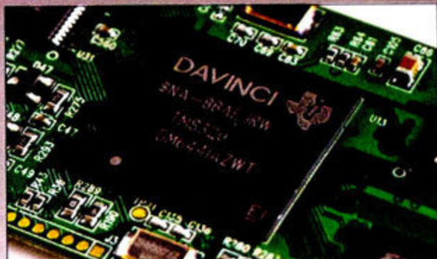
TI达芬奇DM6441芯片无疑是整个播放器的“心脏”,良好的视频兼容性和解码能力给我们留下了深刻印象
