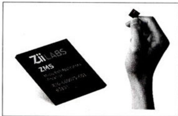
图4 Zii ZMS处理器尺寸极小, A4大小的空间内可组成TFlops级别计算机。
