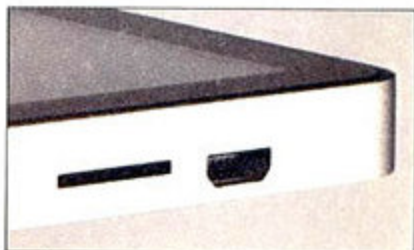
TF卡和USB接口都是直接从铝合金机身上切割出来的,这对生产工艺要求较高
