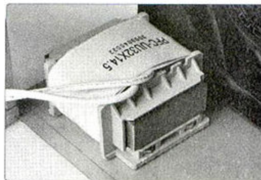
图4 酷腾双核430电源采用了被动式PFC。
