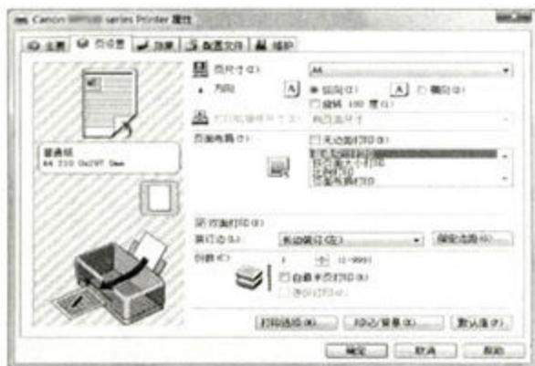
2.在制作成图片后,就可以输出至打印机进行打印。进行打印时要对打印机的选项设置进行调整,主要是将材质设置为A4幅面照片纸,然后根据图像的版式来设定选用纵向和横向方式。另外为了在精度和打印速度上得到平衡,打印精度可以设定为第二档的照片模式。设定完成后即可进行打印。
