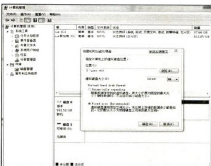
VHD虚拟硬盘可在磁盘管理中进行创建，并可自定义硬盘存在位置，虚拟硬盘的大小
