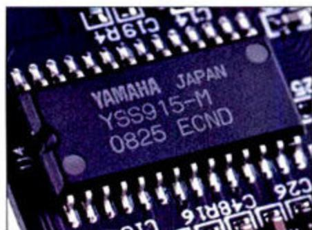
雅马哈YSS915M可实现硬件级卡拉OK混响效果。
