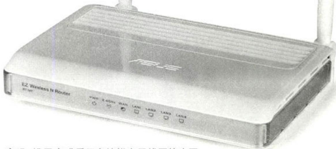
密码。设置完成后用户就能在无线网络中同时发现上述四个不同SSID。利用这款无线路由器, 企业管理员可以最多划分出四种用户类型, 每种用户依靠密码登陆各自的无线网络。
