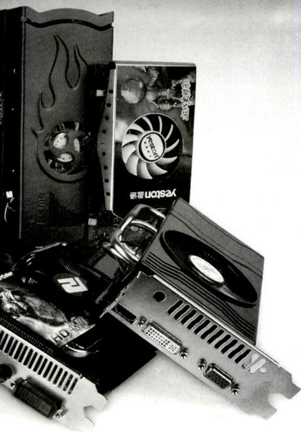
不难看出,在128MB GDDR3版本和256MB GDDR2版本的GeForce 7600 GT (GS)时代下,不同版本的显存规格明显不同,但它们的价格却基本一致。而如今的大容量显存显卡的市场已经悄然发生变化,第一,不同显存容量的版本的都采用了相同的显存类型,因此它们的频率相差很小,主要区别在于显存容量;第二,1GB显存容量的显卡的价格明显更高;第三,配备了256MB显存的中端显卡处于成本控制的考虑,采用了128-bit的显存位宽;第四,256MB显存容量已经是目前DirectX 10显卡的标配。于是,我们可以设下这样的疑问,对目前不同档次的显卡而言,在显存类型相同、频率基本一致的情况下,究竟配备多大的显存容量能够满足目前DirectX 10游戏的需求,1GB显存有没有实际意义?
