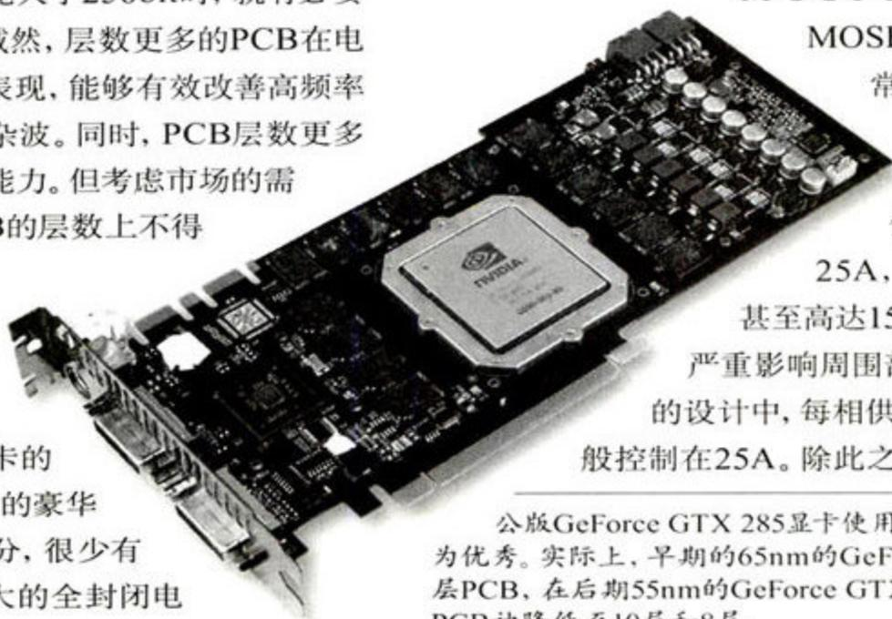
公版GeForce GTX 285显卡使用14层PCB打造,电气性能极为优秀。实际上,早期的65nm的GeForce GTX 260也是使用14层PCB,在后期55nm的GeForce GTX 260+降低了供电需求后,PCB被降低至10层和8层。
