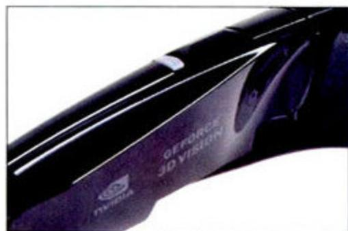
▶ 左框架处的开关及状态指示灯,下面还有USB接口,用来充电
