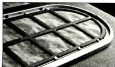
▲ 侧面板与12cm风扇的防尘过滤网可以有效防止灰尘的进入。
