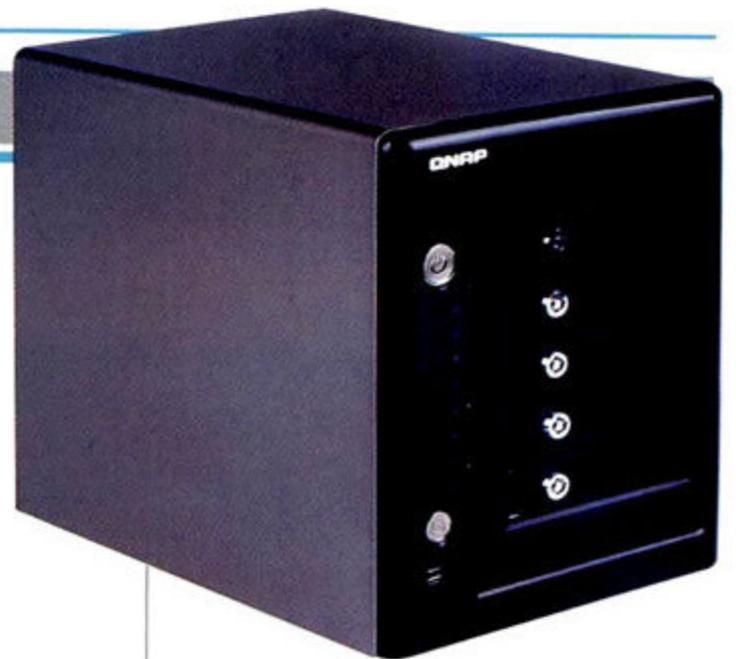
QNAP TS-509 Pro采用Intel Celeron 1.6GHz处理器,1GB DDR2内存和128MB闪存,这在中端NAS设备中属于一流配置。由于NAS的任务比较单一,不像PC那样非常需要高频处理器处理多样化的任务,因此NAS对高频处理器的需求并不是特别明显,用了也不能获得非常明显的性能提升,反而会增大功耗。
