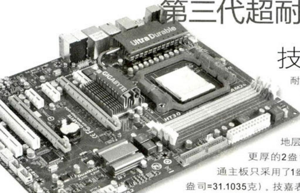
技嘉最近推出的第三代超耐久技术在主板印刷电路板内的电源层与接地层采用了更重、
