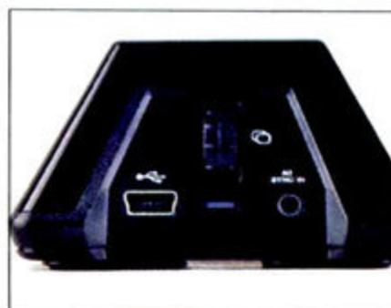
▶ 接收器背部一览,滚轮用来调节3D画面的深度,左边USB接口连接电脑,右边接口连接投影机、电视
