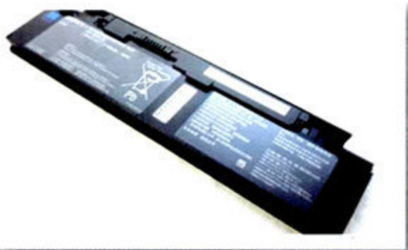
拆下的电池，7.4V/2100mAh，那么它的续航能力如何呢？这也让我们对后续的评测充满了期待。
