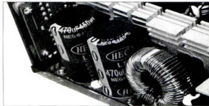
▲ HEC 470 \mu F高压滤波电容
