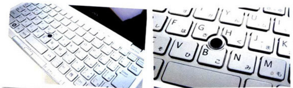
键盘的键距很大，类似VAIO TT的悬浮键盘设计，使用起来应该会比较舒适。键盘中央是一个类似Thinkpad小红帽设计的指点杆。
