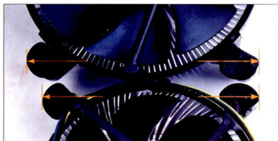
Intel LGA 1366原装散热器(上)的孔距比LGA 775原装散热器(下)更长
