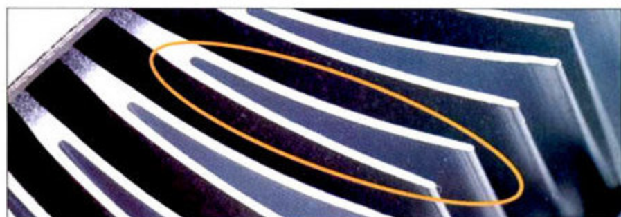
LGA 1366原装散热器(上)散热鳍片的散发CPU热量的能力比LGA 775原装散热器(下)更强
