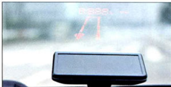
前风挡导航投影成像示意
