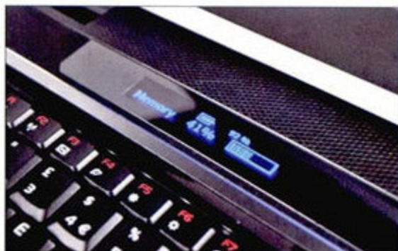
能显示多种信息的单色LED显示屏
