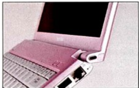
转轴是与R500非常相似的L形下沉式转轴, 防盗锁孔被设计在了转轴上
