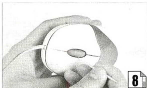
图8: 鼠标上的结合处往往会形成许多细小缝隙,包括滚轮和按键部分,这些缝隙中的污垢可以用牙签来剔除。
