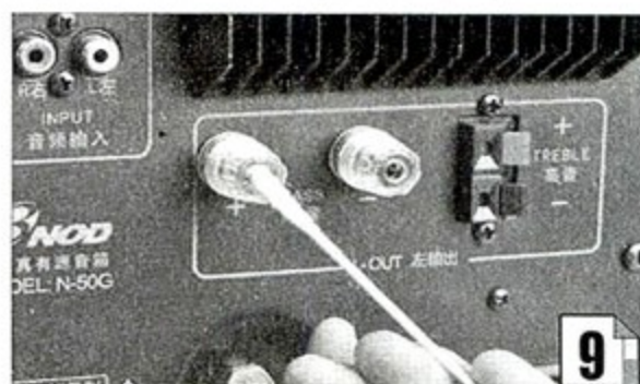
图9: 用沾上清洁剂的软布擦拭端口及附近的污垢，缝隙处用棉花签处理。
