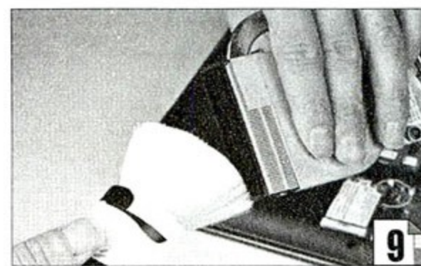
图9:最后就是关键的清理散热片的灰尘。可以看到,和热管相连接的散热器鳍片比较密集,这样做是为了加强散热效果。越是密集散热效果越好,但是也越容易积累灰尘。其实清理起来也是非常简单的,用前面我们准备的小刷子将外面的灰尘刷出去。再用皮老虎将鳍片内部的灰尘吹出去,就宣告完成。最后再反方向安装回去即可。
