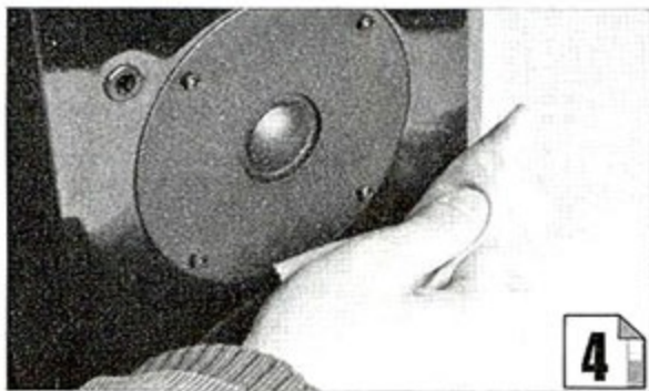
图4: 音箱箱体表面的灰尘可用干的软布擦掉。亚光或木纹表面的箱体比较耐脏，但一旦有污渍附着则可在软布上沾少量清洁家具用的清洁剂进行处理。高亮表面的箱体不耐脏，但无论是灰尘、指纹还是其它污渍，用干的软布一般都能擦拭干净。
