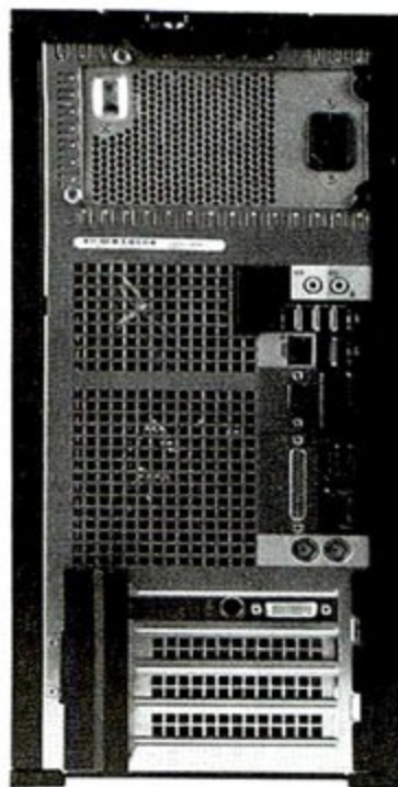
后部接口提供6个USB、1个e-SATA和一个DisplayPort接口, 为系统扩展做好准备。
