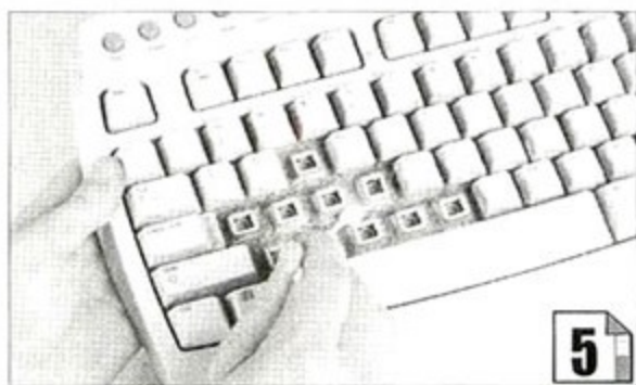
图5: 撬起键帽后,键盘内部的缝隙很多,这时用沾有清洁剂的棉花签进行清理,另外用废旧的牙刷来替代棉花签也可以。
