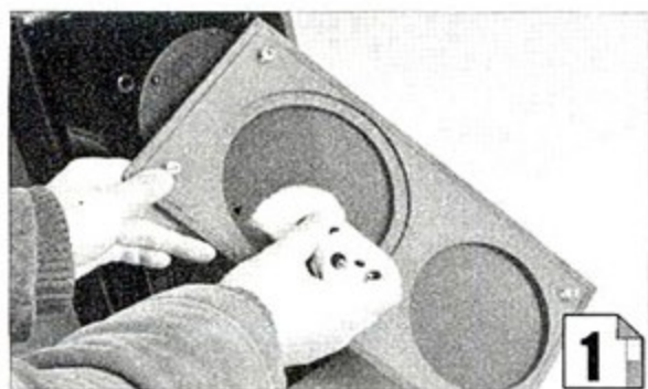
图1: 扬声器上有网罩的要先取下它，网罩非常容易沾染灰尘，可用软毛刷对附着在它上面的灰尘进行清理。
