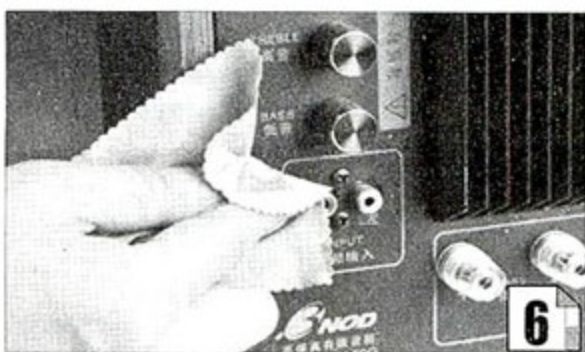
图6: 清洁完端口表面的灰尘，下面就应该用软布沾上清洁剂擦拭端口的周围。
