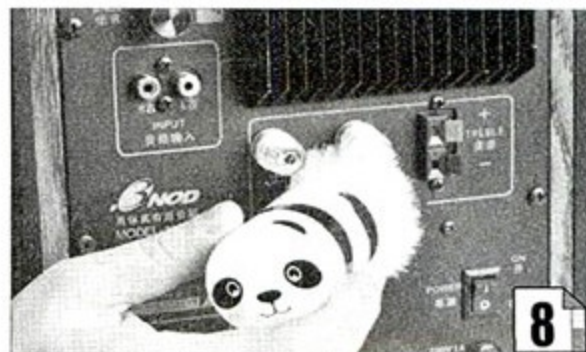
图8: 下面我们对音箱线端口部分进行清理。先用软毛刷清除表面的灰尘。
