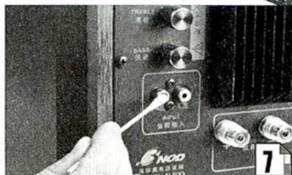
图7: 用沾有清洁剂的棉花签擦拭端口的中间部分。如果端口氧化，还需用驱除氧化层的清洁剂再清洁一遍，方法同图6、7。
