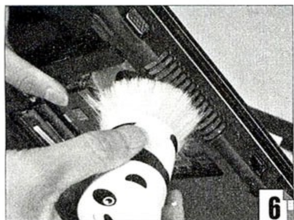
图6:取下散热器后,首先用防静电刷将笔记本电脑出风口附近堆积的灰尘清扫干净。注意不要让灰尘跌落到CPU或主板芯片上了。
