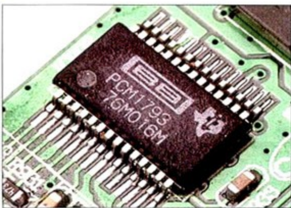
DAC芯片采用了PCM1793, 这是一颗相当高级的PCM解码芯片, 常见于中高档CD机中。
