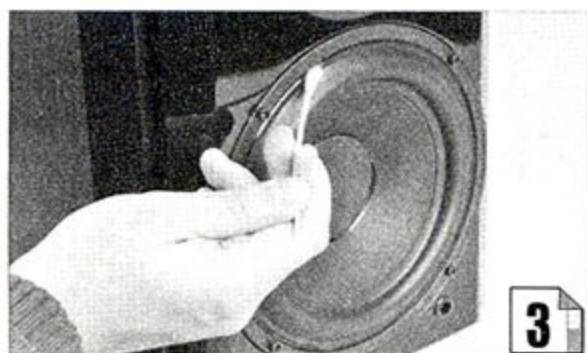
图3: 中、低音单元同样用软毛刷进行清洁，在边角处堆积较厚的灰尘可用棉花签做细节清理。如果没有软毛刷，用电吹风开冷风档在离单元较远的地方吹也可以。
