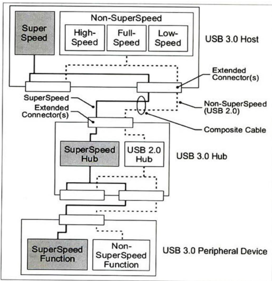
图3 USB 3.0标准的双总线架构设计
