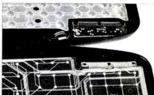
罗技G1只支持防溅水，仅在键盘中加入了一些导水孔。在键盘底部，罗技G1的导水孔大概是13个。
