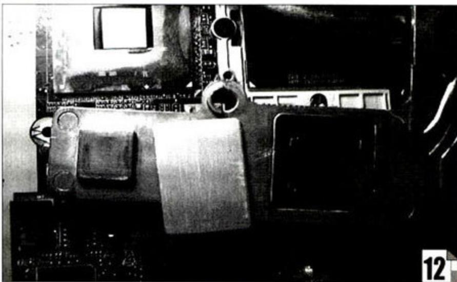
选择垫片的要求很简单,厚度恰当、导热好、平整光滑即可。从这点来说,如果有厚度适当的小铜片就更完美了。如果不好找,可以去考虑问问买全铝机箱的朋友,一般机箱上的光驱和软驱位置的铝挡板,厚度都在1mm之内,而且光滑平整。这个还非常好裁剪,用美工刀沿着直线划几下,在划线两边轻轻掰几次就断开了。然后打磨一下,就够我们用了。铝片面积不要太大,以盖住芯片DIE,不影响安装为原则。
