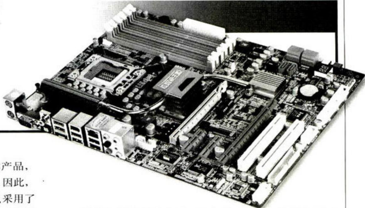
该产品是第一款由内地主板厂商推出的X58产品，1999元的价格显示该主板也是一款高性价比产品。因此，主板在处理器内核供电系统的设计上并不突出，只采用了四相供电设计，而其Uncore与内存供电也均为1相供电设计。不过，该主板采用了全板全固态的电容配置方式，全部使用日系NICHICON(尼吉康)LF系列固态电容，有效保证了主板工作的稳定运行。同时，主板还采用了连接南、北桥、MOSFET的一体式热管散热系统。
