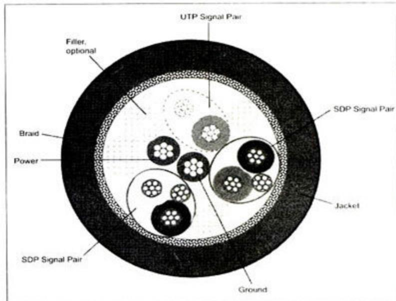
图6 USB 3.0线缆内采用彩色信号线,有助于识别。
