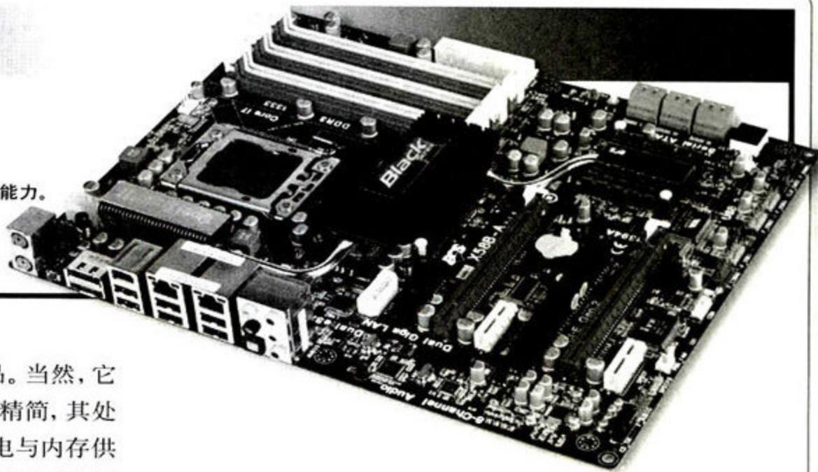
这款主板也是一款以性价比为卖点的产品。当然, 它的供电系统相对前面几款主板也有一定程度的精简, 其处理器内核只采用了5相供电设计, 而Uncore供电与内存供电均采用1相供电设计。不过在用料上, 它仍然使用了全封闭电感、台系OCR固态电容、三洋SEPC固态电容, 具有一定卖相。同时主板采用了代号“QoolTech”的一体式热管散热系统, 其北桥、MOSFET散热片均具备较大的散热面积。
