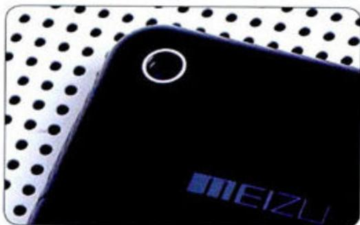
■ 折边处理使得电池后盖与机身接缝较为显眼，破坏了背面的整体感
