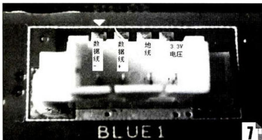
一般的4Pin的接口定义就是供电针脚3.3V, 接地针脚GND, USB数据针脚+, USB数据针脚-。只是我们有时候无法确定主板的Pin的定义是从哪头开始排列的。看起来要确定这个很专业, 其实很简单。用万用表按照相反的顺序两次测量第二个针脚, 一个表笔和地连接(主板上接地的地方非常多, 比如螺丝孔位置一般就是接地点), 一个表笔测第二个针脚。这两次相反顺序测的第二个针脚, 肯定有一次电阻为零, 证明是GND。地线测量出来了, 那么该顺序的第一个位置就是电压针脚3.3V。自然剩下的两个就是USB+和USB-了, 这个顺序是不会变的。对于复杂一点的8Pin的来说, 这个方法同样适用(图8)。
