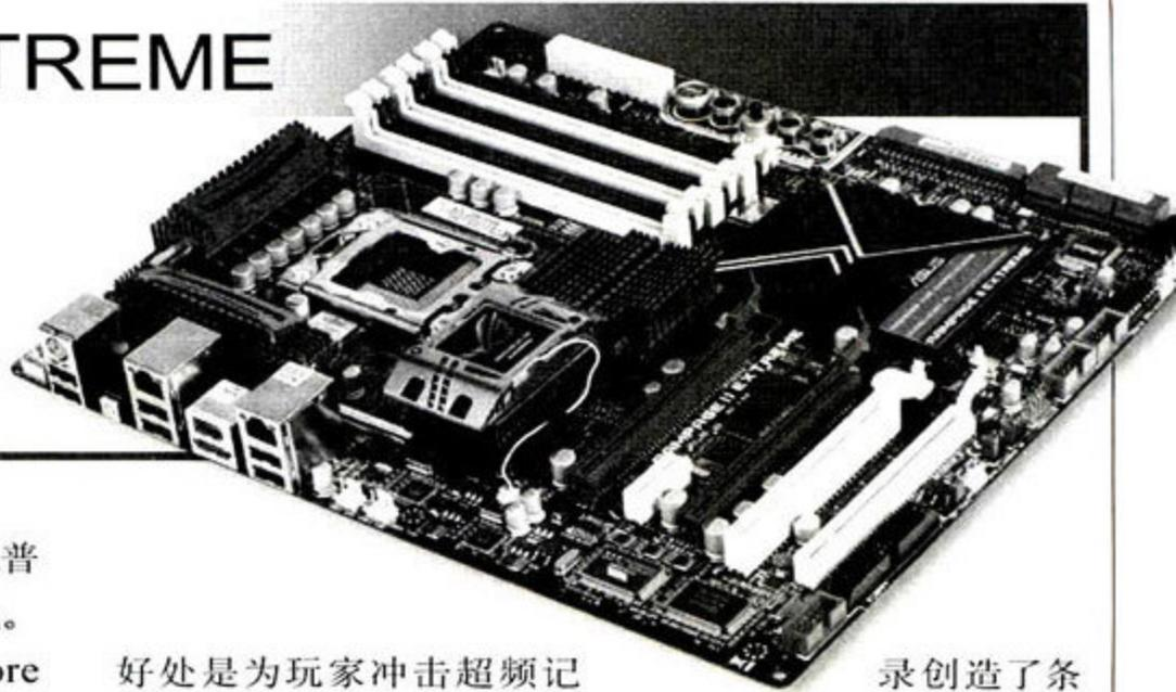
该主板采用8层黑色超宽板型PCB设计, 其宽度比普通ATX主板超出将近2.5cm, 能让设计师更合理地布线。主板采用等效16相处理器内核供电系统、3相独立Uncore供电模块 (在玩家国度LOGO灯的下方), 用料上极其奢华。除了富士通的固态电容外, 供电系统还采用了多颗日本化工的钽电容与富士通ML-3高分子金属电容。
