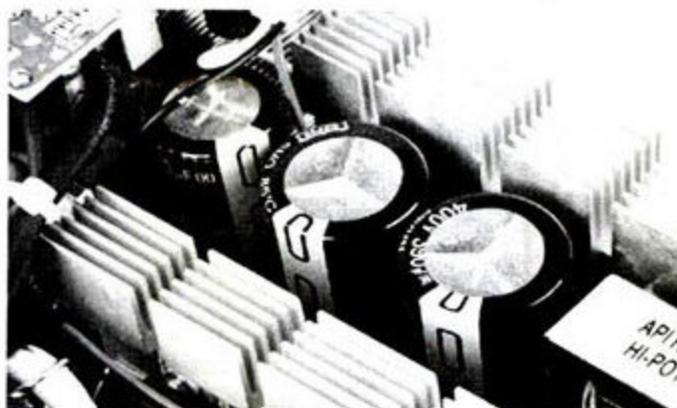
▲ 电流经过整流桥来到一次侧，通过Champion的CM6800AG PFC-PWM控制芯片来得到更好的波形。一次侧有三颗滤波电容，其中一颗型号为400V 270uF，另外两颗是Nippon Chemicon的400V 390uF，耐温值为85°C。
