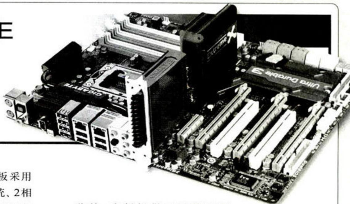
这也是一款做工、用料相当讲究的产品。主板采用8层蓝色PCB设计, 等效12相处理器内核供电系统、2相Uncore供电, 3相内存供电, 全部使用日本化工PSE与三洋SEPC固态电容。特别的是, 这款X58主板采用了技嘉最新的第三代超耐久技术, 在PCB里使用了2盎司纯铜, 可以进一步增强主板的导电能力, 并降低电阻值, 有效地减少主板的发热量。同时, 主板不仅在MOSFET、北桥、南桥芯片上安装了高密度散热片, 还配备了“Hybrid Silent-pipe”(混合静音热管) 散热模块, 该散热模块只需四颗螺丝便可固定在北桥导热头上, 以利用来自机箱内各个方向的气流带走北桥热量。同时主板北桥散热器还配有水冷头, 有需要的用户可以采用水冷散热器加强北桥的散热。
