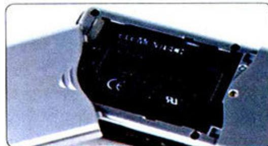
PK-101采用锂电池供电,样机电池容量为1100mAh。
