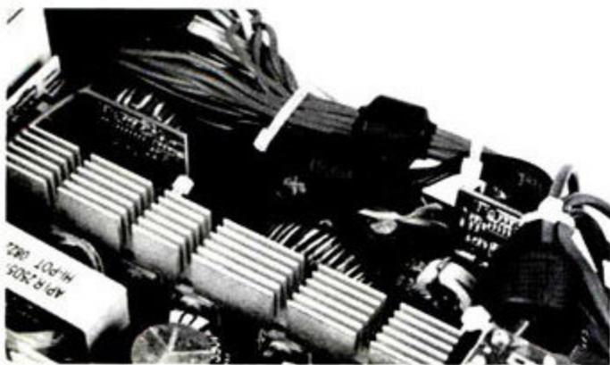
▲ 直流部分的输出采用了DC-to-DC设计，由两个独立的PCB实现，靠近二次侧散热片的是输入滤波电容和扼流线圈，输出一侧的是输出电感和输出滤波电容，两路生成独立的+3.3V与+5V。
