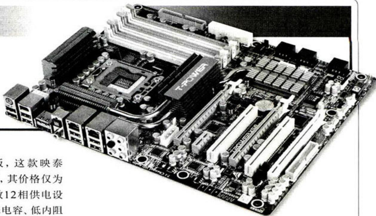
相对于前两款价格昂贵的X58主板, 这款映泰TPower X58是一款性价比非常高的产品, 其价格仅为1999元, 而且它为处理器内核采用了等效12相供电设计, 并配备全封闭电感、日本化工PSC固态电容、低内阻MOSFET。同时处理器Uncore供电与内存供电也分别采用1相与2相设计, 可满足一般超频玩家的使用。此外, 主板采用北桥、南桥、MOSFET一体式热管散热系统, 在发热量较大的MOSFET与北桥之间采用两根热管连接, 加强热量交换效能。同时主板背板配备了大量锡条, 可进一步加强主板的散热。
