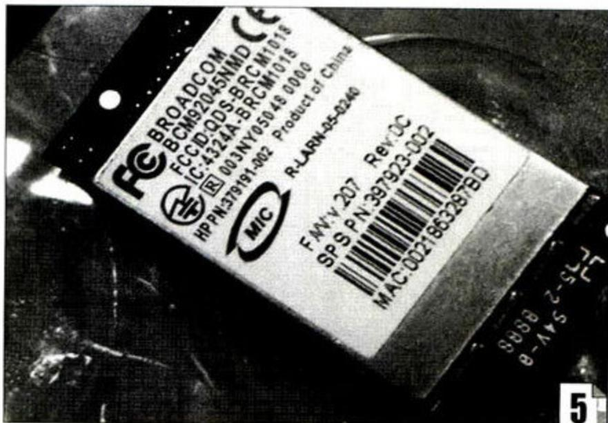
BCM92045支持蓝牙2.0+EDR,是现在笔记本电脑采用最多的蓝牙模块。这个蓝牙模块的价格在30元左右。最重要的特点就是信号强度好,功耗低。我们不提倡买USB接口的蓝牙模块自己改装。因为USB接口的蓝牙模块电压为5V,笔记本电脑内的蓝牙模块接口为3.3V,降压使用时,模块稳定性容易受影响。
