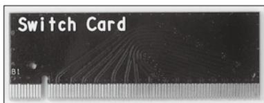
(Switch Card) 常见于部分支持交叉火力的PCI-E主板附件中,它的作用是当你只使用一块独立显卡时,便将其插在另一个PCI-E插槽上,用来禁止该插槽占用带宽。否则,显卡将只工作在默认的x8模式下,而非x16。
