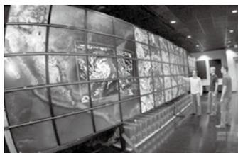
位于美国奥斯汀市德克萨斯大学的德克萨斯高级计算中心(TACC)近日部署了全球分辨率最大的拼接显示墙,这套名为“Stallion”的虚拟化集群系统使用了75台戴尔30英寸显示器,合计分辨率高达38400×8000,总像素3.072亿个。
