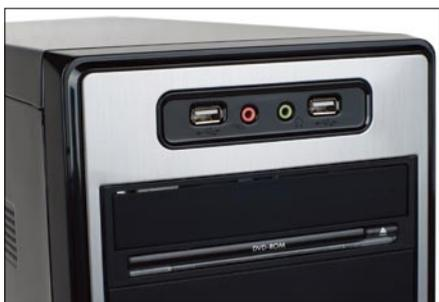
▲ 前置接口, 包括两个USB、麦克风、耳机, 都采用了高频线材, 确保了传输质量
