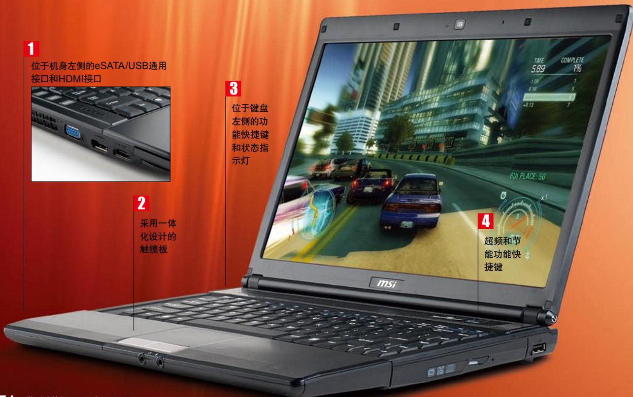
“Turbo”按键就能对处理器进行超频，超频幅度在出厂时已经设定，能将处理器的外频提升20%；在使用电池时，按下“Turbo”键则是让处理器的外频降低20%。相信大家都已经看出来，你可以通过这个功能来很方便地选择加强性能还是控制功耗。
