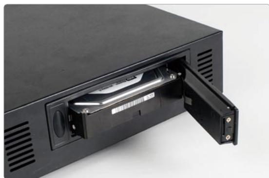
❖ 侧面的3.5英寸SATA硬盘架，安装和拆卸硬盘非常方便。
