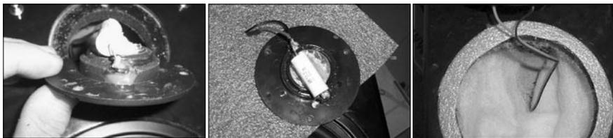
图2 用热熔胶堵上高音喇叭接线柱 图3 装回高音喇叭, 并加装垫片。 图4 装回低音喇叭并同时加入吸音箱和垫片。
