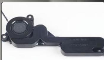
■ 拆解下来的倒相式设计的低音扬声器
