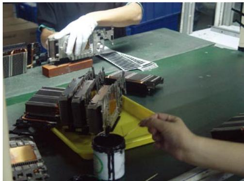
↑ 酷冷至尊代工的NVIDIA高端显卡散热器装配线
