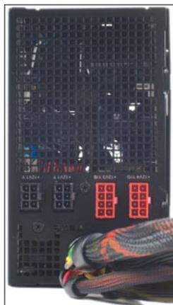
▲ 和其它高端电源一样,在电源接口部分, Signature SG-850也毫无例外地采用了模块化输出设计。用户需要时才连接相应的输出接口,避免线材过多造成机箱凌乱,影响散热,同时也有效地降低了电磁干扰。另外,该电源的外接显卡接口也被设计成6+2的形式,以更好地应对目前的中高端显卡的需求。
