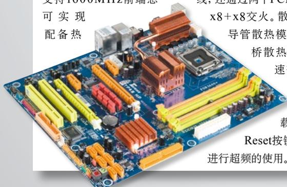
可实现x8+x8交火。散热方面,主板配备了热导管散热模块,连接南北桥散热片,将热量迅速带走。主板采用四相固电设计,还板载了Power和Reset按键,方便了用户进行超频的使用。
