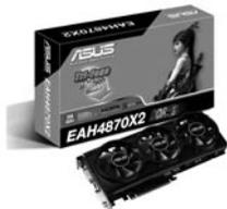
华硕近日发布的一款非公版 Radeon HD 4870 X2配备了三个散热风扇,号称可以将两颗RV770的核心温度较公版产品再降低24℃。
