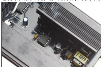
▲ 低压直流部分由UC3845B(脉宽调制)和LM393N(电压比较器)芯片和相关电路组成的DC-to-DC电压调节电路,使得其瞬态响应速度大大提高,输出波形得到明显改善,输出电压更加稳定。
