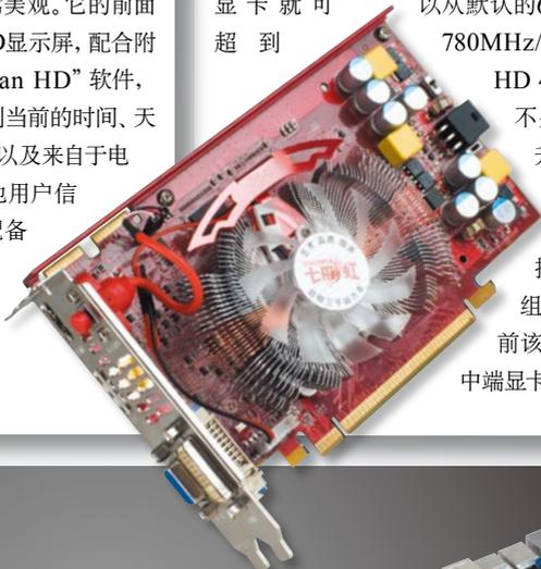
以从默认的600MHz/1800MHz猛超到780MHz/2050MHz,比Radeon HD 4670的默认频率还高出不少,带来了性能大幅提升。该款显卡还配备了DisplayPort+HDMI+DVI+VGA全视频接口,很好地胜任玩家组建高清设备的需求。目前该显卡售价为549元,是中端显卡中的不错选择。
