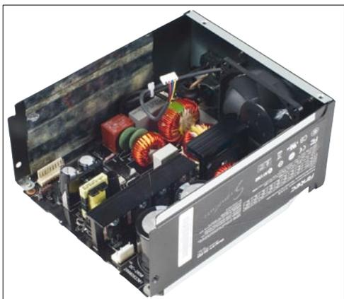
▲ 双层PCB架构,大大改善了电源的内部散热。这是交流部分,我们还可以看到两个日本Rubycon公司的高品质390μF滤波电容,用料相当扎实。
