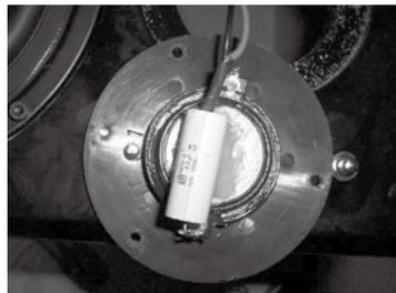
图1 拆下高音和低音，将原来6.8UF的电容换成2.2UF的电容。
