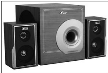
三诺新品H-261音箱的表面采用棕黑木纹PVC贴皮,低音炮的前置倒相孔周围镶嵌着亮银色大圆环,主音量、高、低音调节则侧置其上,调控便捷。两个副箱略矮于低音炮,同样采用了亮银色边框加黑色面罩设计。H-261的喇叭单元均为防磁设计,其5.25英寸低音单元的输出功率为13W,频率响应为25Hz~140Hz;卫星箱则为3.0英寸中音单元及0.5英寸高音单元,输出功率为12W,频率响应为160Hz~20KHz。
