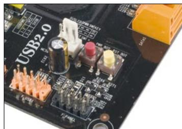
▲ 主板提供了Power开关键、Reset重启键和Clear CMOS键,方便玩家使用。
