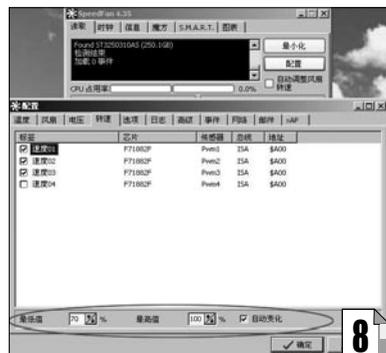
转速下调30%(图8), 而系统风扇可以将转速下调40%左右。需要注意的是, 当转速低于一定程度时, 风扇会停转, 所以必须了解风扇的实际最小转速和最大转速。MC
