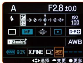
■ 主LCD的功能菜单,D700与α900都提供了主LCD的参数调节界面,不同的是Nikon的界面更像是右肩上小LCD的简单扩展,而SONY就要人性化很多——按下相机上的Fn按键后就可以用方向杆来选择对应的功能以及参数设置。
