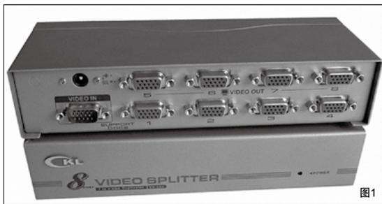
在电脑卖场里的展台上,经常会有多台LCD有序地摆放一起,每台LCD显示同一个画面,带来的大屏效果非常震撼。你知道这是怎么实现的吗?事实上,这是利用了LCD的D-Sub接口,先将电脑显卡的D-Sub接口连接到同为D-Sub接口的分屏器(图1),而后再将分屏器另一端连接多台LCD,即可实现。
