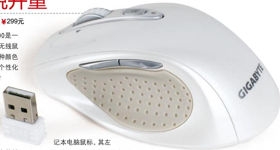
记本电脑鼠标。其左右两侧设置的防滑橡胶贴皮,在一定程度上弥补了表面材质防滑能力的不足,使得这款鼠标更加易于掌控。另外,GM-M7700的按键总体偏软,击键感不错且声音较为轻柔,适合长时间使用。但值得注意的是这款鼠标的滚轮突起较高,在左右拨动的时候手指与滚轮接触充分,不易打滑,但是在前后拨动的时候,手指从按键移动到滚轮上时显得有些不流畅,触感也有些生涩。而两侧的前进、后退键则保持了偏软的风格,击键感与鼠标的左、右键接近,使用起来比较舒适。
