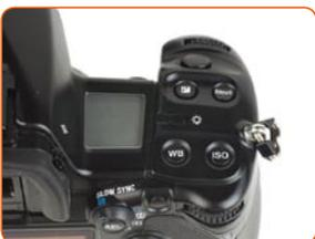
■ 相机右肩的设计:单反相机右肩上的LCD指示屏可以为用户提供当前的参数信息。Nikon的设计非常传统,提供了很完整的相机参数信息;而SONY的设计则很简洁,省下的区域放置了几个最常用的功能按钮。
