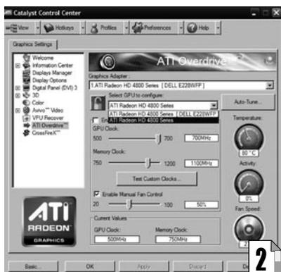
频率的上限分别限制在700MHz和2.2GHz。其实以Radeon HD 4850显卡默认1.044v核心电压来说,通过ATI OverDrive功能超频的
