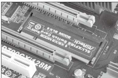
Switch Card的两边都有金手指,一端标记有“X16 MODE”,将这端接入插槽后,主板就工作在一根PCI-E x16模式下;另外一端标记有“X8/X8 MODE”,道理类似。
