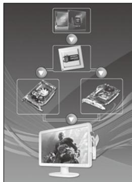
图3 直接设计在主板上上的Hydra Engine多显卡互联示意图
