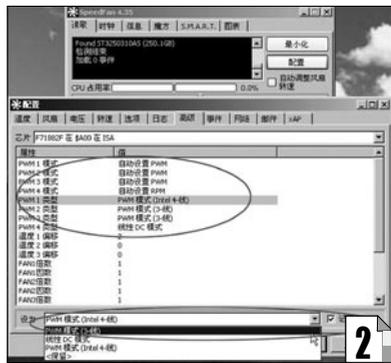
启动时, SpeedFan都能自动调速, 还需要进入“配置”中的“速度”设置风扇转速; 设置完成后勾选“记忆”保存。同时将SpeedFan的快捷方式放入“启动”文件夹中, 这样SpeedFan就能在进入系统操作界面时自动启动。
