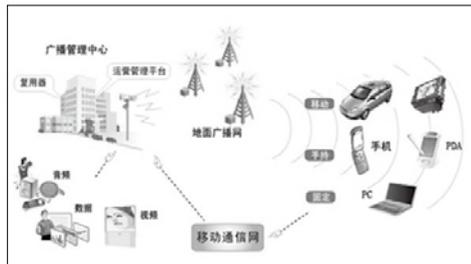
T-DMB网络系统结构图
