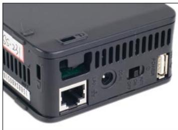
▲LinkStation Mini的背部接口,比较特别的是其Power开关有“Auto”、“On”和“Off”三档。当开关置于“Auto”时,它会随着PC同步开关机,能进一步起到节能的作用。
