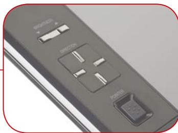
☆ SR S41最迷人的地方在于LCD屏幕两侧快捷按钮。当屏幕翻转过来时,配合指点杆以及这些按钮能够实现绝大多数操作功能(码字除外)。
