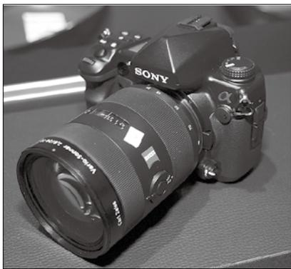
更有趣的是,索尼a900采用了机身手柄分离设计,可以很大程度降低携带重量。在取景器上alpha 900视野率达到100%,并可以选择更换其它类型的对焦屏。一直以来为人诟病的SONY alpha对焦模块也升级到了9个对焦点,中央双十字传感器结构。在取景器设计上alpha 900也相
