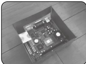
↑ 试验毛坯与主板的相适度
