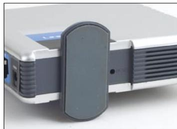
Reset(重置)孔隐藏在侧面的旋转撑脚
