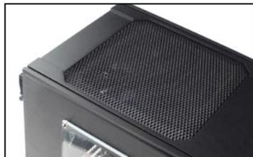
▲ 机箱顶部的18cm超大口径风扇, 转速只有700rpm, 尤为安静
