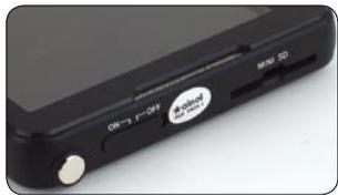
■ 左侧布局: 从左到右依次为电源开关滑键、MINI SD卡扩展插槽
