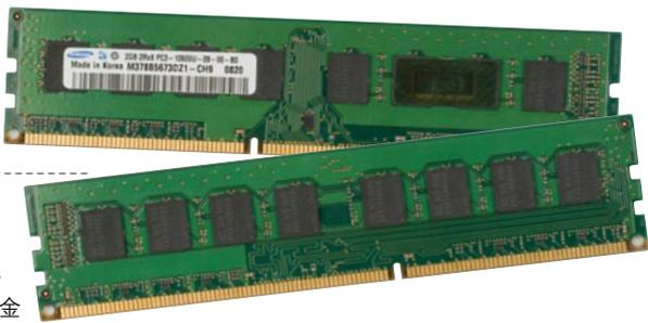
在我们的实际试用中,我们发现尽管该内存价格低廉,但以默认延迟稳定工作在DDR3 1333下毫无问题。而且值得一提的是,它还具备一定的超频能力,在对E8200处理器进行超频时,我们同时将内存工作电压提升到2V左右,并以1:4的比例同步提升内存工作频率,最后内存可以稳定工作在DDR3 1600下,处理器频率提升到3.2GHz,前端总线达到1600MHz。而从测试成绩来看,内存存在超频后,内存、实际软件性能更得到了14.9%~19.9%的提升。(马宇川) MC
