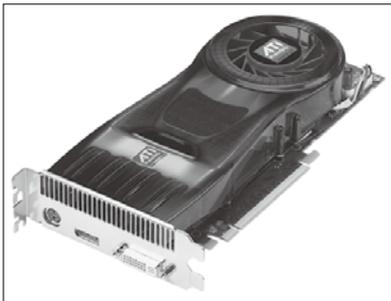
典型的双槽侧吹式散热器，由涡轮式风扇吸风，再经过散热片由侧面吹出至机箱外。
