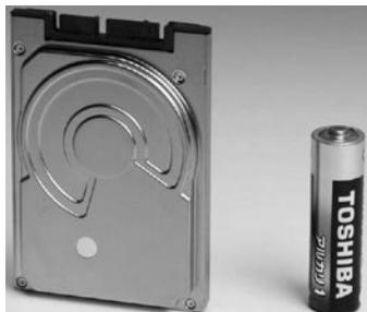
东芝公司近日发布了全球最大容量的250GB 1.8英寸硬盘产品MK2529GSG,该硬盘采用双碟设计,平均寻道时间15ms,5400rpm,重62g,还可选装防撞自由落体传感器。
