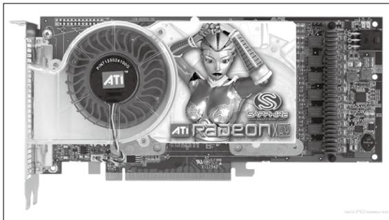
硕大的散热器覆盖了显存和核心,并且在供电部分贴上了散热片,侧吹式风道可以有效帮助供电部分降温。
