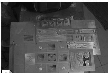
图3 板材加工成型
