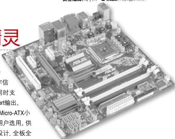
显的区别,不过在高清播放性能测试中,得益于GMA X4500HD图形核心的完全硬解能力,华硕P5Q-EM主板的处理器占用率相对于G35有十分明显的降低,其中H.264 1080p视频的占用率由G35的92%猛降至6.8%,VC-1、MPEG-2高清影片的处理占用率也有大幅下降,整体高清播放性能略好于MCP7A-U,与790GX基本持平。
