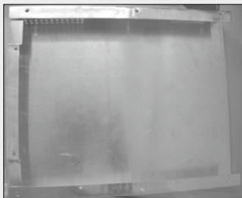
↑ 铝板打造的主机顶盖,两侧开有大量散热孔和接口孔,顶部也开有两个小风扇的进风口。
