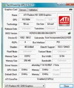
■ 用GPU-Z可以看到5530G内置的两个显示核心。
