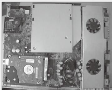
↑ 将主板固定在主机底座上,安装上2.5英寸硬盘和笔记本电脑光驱。
