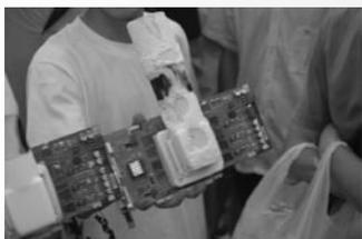
↑极限超频后的显卡“大炮”，由于相变制冷而结了厚厚的一层冰霜。
