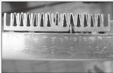
↑ 为了增强散热片的散热效果,还制作了许多“V”形铝片,插入散热片的凹槽中,扩大了散热片的面积。
