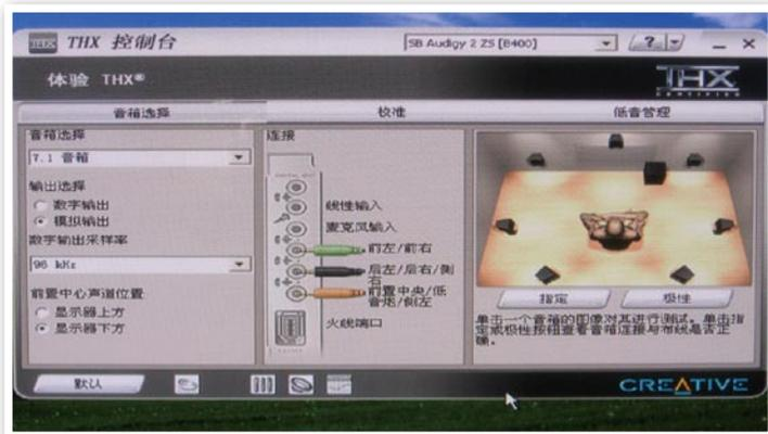
»在声卡的THX控制台中，首先要选择7.1声道和模拟输出。同时会提示音频线的连接方法，三个接口中绿色插头对应前左/前右，黑色插头对应后左/后右/侧右，红色插头对应前置中央/低音炮/侧左。
