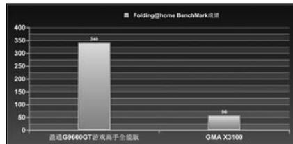
强大的实力。除了我们对比的Folding@Home外, 在PDF加速, CAD计算加速, Matlab计算加速上, 借助CUDA, GeForce 9600 GT GPU都展现了极为惊人的力量。可以看到在Matlab复杂的科学计算中, 高性能GPU平台的速度比普通PC快了将近400%。
