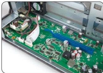
■ 取下内置显卡后的内部构造,显卡的固定方式与台式机无异
