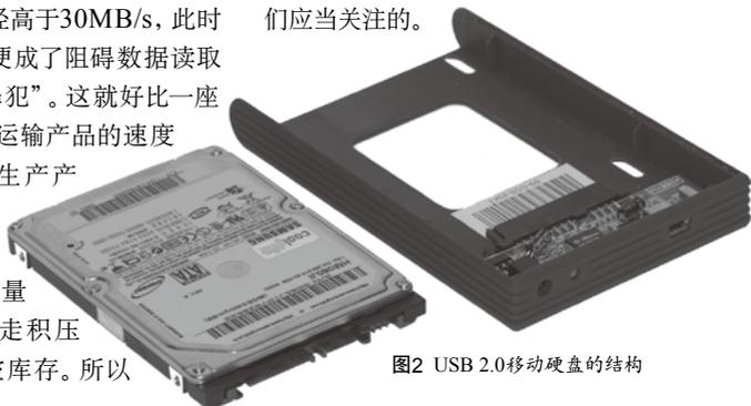
图2 USB 2.0移动硬盘的结构
