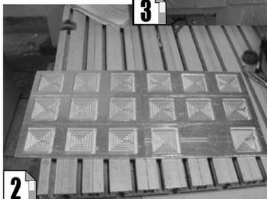
图2 所有铝板都进行挖槽处理
