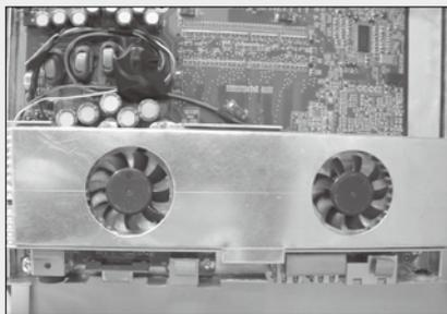
↑ 制作完成的CPU、北桥芯片散热器,盖上顶盖形成了风道。
