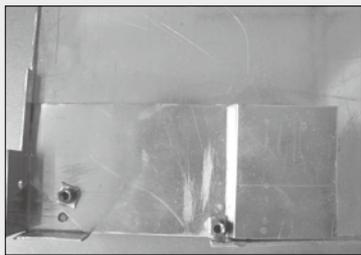
↑ 裁剪一片铝材,折成“Z”字形让它具有一定的弹性,用来连接板载显卡的顶盖和主机底座(板载显卡位于主板背面),这样就能把显卡热量传导至主机外壳,让主机外壳成为静音的显卡散热器。
