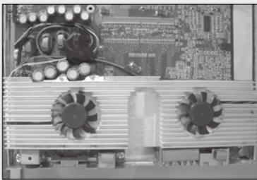
↑ CPU和北桥芯片采用一体式散热器,铝条散热器中铣出的两个圆形凹槽安装小风扇,散热器两侧及中间U型出风口直接通向主机之外。
