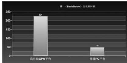
目前高清影片越来越多, 转换视频格式将成为一个热门话题。高性能GPU平台借助NVIDIA CUDA的功能和相关软件(《BadaBoom》), 带来了更高的视频转换速度, 耗时大大缩短。
