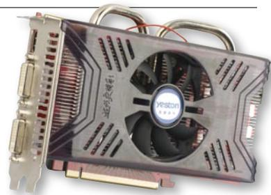
660MHz,不过其显存表现不错,尽管只是普通的奇梦达1ns显存,但在这块显卡上,该显存却能够达到2320MHz的高频率。另一方面,由于风扇转速优化较好,尽管该显卡的散热器用料并不是最好的,但在测试中可以看到,它在超频后的满载工作温度也只有60℃,让人能够放心使用。
