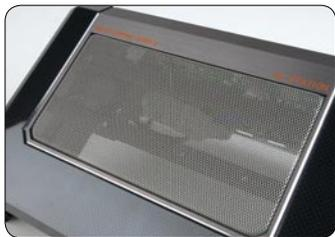
■ 硕大的网状金属罩,是XG Station的散热出口,热量将主要从这里排出
