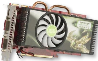
率分别稳定在660MHz/2280MHz左右。但在散热性能测试上,该显卡表现十分不错,可以看到,该显卡默认频率下核心满载工作温度仅55°C,在超频后的核心满载工作温度也只有60°C。
