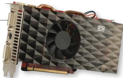
点,则认为此频率超频不成功。最后,这块耕昇HD4850赵云版显卡被我们超频到了720MHz/2260MHz,其性能有小幅提升。
