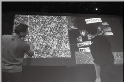
Perceptive Pixel公司展示了Touch UI(触感人机界面)技术,该技术是为用户创造可以多人同时使用的人机界面。电脑操作方面,用户无需通过鼠标和键盘,只需触动屏幕,菜单就可显现和使用。而该技术的实现,还要归功于越来越发达的图形技术和图形硬件。
