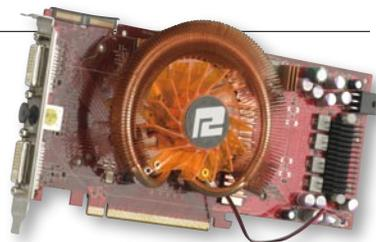
在实际测试中,该显卡由于核心显存设定频率分别为665MHz/2000MHz,因此其测试成绩高于那些按公版频率设定的非公版Radeon HD 4850显卡。但该显卡散热器的实际性能相对于其他非公版Radeon HD 4850来看略有不足,转速设置也不够优化,因此其超频后最高满载温度达71℃,最终710MHz/2260MHz的超频成绩不是十分突出。
