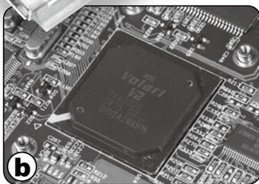
XGI(图诚科技)的V2显示芯片，有消息称此颗芯片就是SiS 315显示芯片，具备不错的3D加速和视频回放功能，但因为某些方面的原因印上XGI V2的标识。
