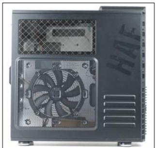
▲ 侧面板上的23cm红光风扇,在提供极致散热性能的同时,也给人以强烈的视觉冲击
