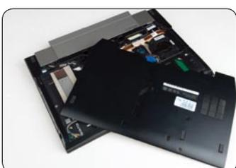
■ 取下一颗螺丝就能卸下机身底部的底板。
