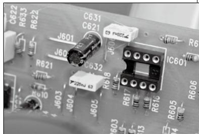
■ 将运放座焊接到电路板上
