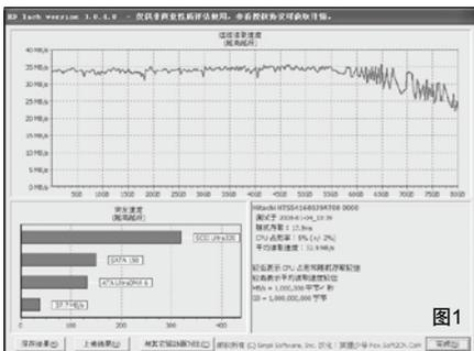
坐标系中,横轴代表硬盘磁头从盘片外侧向盘片内侧运动时的读取位置,纵轴则表示硬盘数据读取速度。一块5400rpm 2.5英寸笔记本电脑硬盘的读取速率曲线,读取速度在35~65MB/s,主流7200rpm 3.5英寸台式硬盘的读取速度一般在45~100MB/s。3.5英寸硬盘之所以比2.5英寸硬盘的读取速度更快是因为前者单碟容量更大,转速更高。但较这两者而言,菜菜的移动硬盘的读取速度曲线(图1)简直“不堪入目”,速度最高也只有35MB/s。
