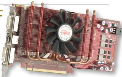
频能力,其720MHz的超频成绩并不逊色于耕昇与迪兰恒进的产品。而最激动人心的是,由于该显卡配备的散热器性能很强,可以看到,在默认待机状态下,其核心温度仅38°C,相比公版产品的80°C,其散热效能可谓惊人,而在超频满载工作状态下,尽管核心频率达到了720MHz,但显卡核心工作温度也只有56°C,显然该显卡的工作稳定性令人放心。(马宇川) MC
