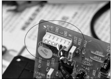
■ 音调电路板上的供电连线
