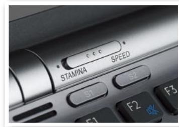
■ 我们测试的首款采用迅驰2可切换显卡技术的机型SONY VAIO Z,这是它位于转轴上的切换开关
