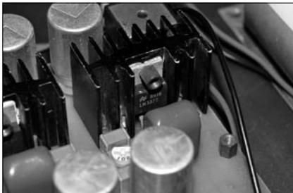
■ 采用LM337制作的可调稳压电源板
