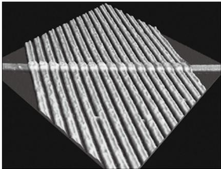
由17个惠普忆阻器组成的简单电路的电子显微镜照片
