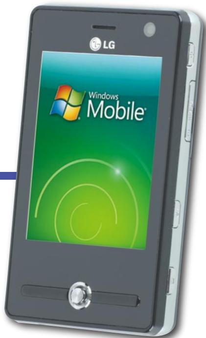
经过测试发现,KS200可以拍摄最大1600×1200像素的照片和320×240像素的视频短片。此外还支持自拍定时器、连拍、多种白平衡设置(自动、日光、阴天、明亮、室内)和三种滤镜效果,整体来看设置较为丰富。
