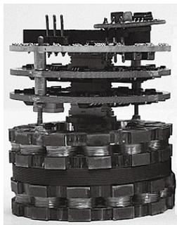
图9 IDF上新型材料“Catom”的展示, 左边为Catom的微型智能部件。
