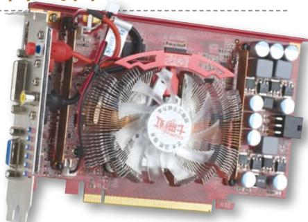
处理器)的最佳超频成绩。同时配合高效的散热器,显卡核心超频后的满载温度也只有51°C,总体来看,该显卡是目前GeForce 9500 GT显卡里整体表现最好的一款产品。
