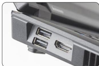
■ SL400在机身左侧提供了HDMI接口,2个USB接口上下重叠比较拥挤。
