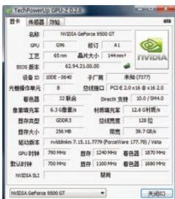
在本文截稿时为止,目前最新版本的GPU-Z还暂时无法侦测GeForce 9500 GT核心的具体制程。从这两款显卡的GPU-Z侦测图中可以看到,它们均被识别为65nm的A1版本,所以对核心制程比较关心的读者在购买GeForce 9500 GT时,最好跟商家商量一下,看能否拿掉散热器以便观察核心的编号。
