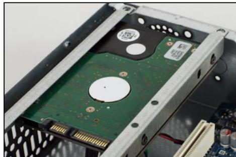
» 硬盘是通过两根横梁悬挂在机箱顶部的，横梁的位置可以调节，取决于你安装的是3.5英寸硬盘，还是2.5英寸笔记本硬盘。光驱的安装相对比较简单，按照位置固定好就行。
