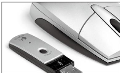
◎新出的RF无线鼠标所搭配的无线接收器纷纷改用类似闪存的设计,体积更小且没有连线。不过,和真正采用2.4GHz的接收器相比,后者的“个头”要小一些
