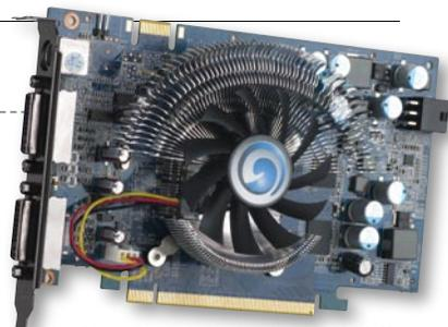
大。而从温度测试来看,该显卡的散热器性能较好,不论超频前后,核心满载温度始终维持在53°C左右。
