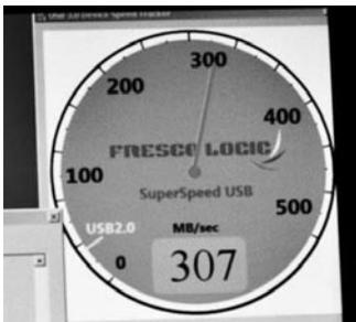
Intel近日在旧金山IDF 2008上展示了SuperSpeed USB 3.0技术,其理论传输速度为600MB/s,现场实测速度达到了307MB/s。
