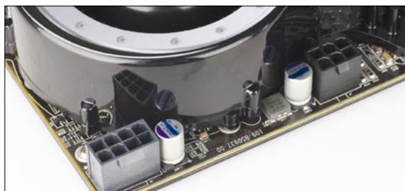
>> 与GeForce GTX 280相同,同时外接6pin和8pin电源接口之后Radeon HD 4870 X2才能正常工作。
