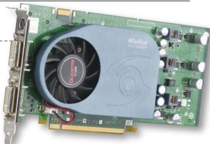
是,该显卡配备的1ns显存在超频中未能达到标称2000MHz的工作频率,此外,显卡散热器性能一般,超频后要注意加强散热。
