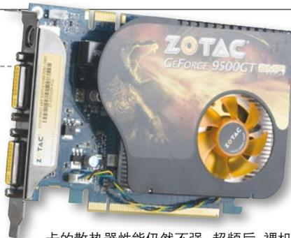
卡的散热器性能仍然不强,超频后,裸机状态下的核心满载温度甚至达到了70°C,显然使用该显卡进行超频的话也需注意散热问题。
