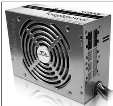
Tt ToughPower 1500w电源采用20cm超长机身设计,提供额定1500W输出功率和峰值1600W输出功率。为了将大功率负载时产生的热量及时带走,电源顶部设置有14cm的大口径温控散热风扇。该电源由双路750W独立供电模块组成,整个电源提供了四路+12V输出,具备两个8pin的CPU供电接头和两组6pin+8pin的PCI-E辅助供电接头,其市场售价为2780元。
