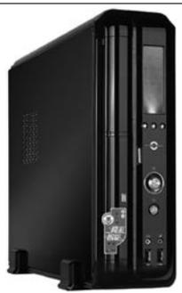
容Micro主板和Micro电源,提供了5.25英寸、3.25英寸和3.5英寸驱动位各一个,其市场售价为499元(含Micro电源一个)。
