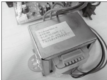
图8 广泛应用于有源音箱中的E型变压器
