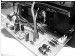
■将金字音频专用滤波电容的引脚插入电路板时应注意正负极的区别。
