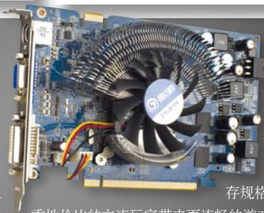
重性价比的主流玩家带来更流畅的游戏体验。Radeon HD3850在价格上的就随之下调到599元。该显卡的流处理器频率为1375MHz,默认核心/显存频率达到了500/1600MHz。显然,它会给注重性价比的主流玩家带来更流畅的游戏体验。
