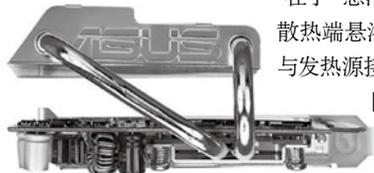
热管悬浮术散热器的设计非常巧妙，整个散热鳍片都悬挂在空中。
