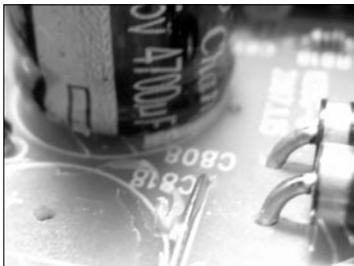
■一定要先将原配滤波电容和电路板之间的热熔胶清理掉。
