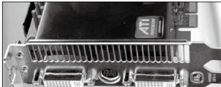
公版AMD Radeon HD 3870×2使用的散热器，则占据了两个PCI插槽，热空气可以更好地从DVI接口旁边的I/O挡板排出机箱。
