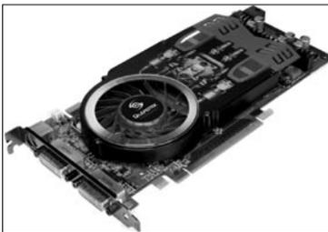
丽台WinFast PX9800 GT 512MB显卡于近日上市。它采用了NVIDIA GeForce 9800GT显示芯片,搭载512MB/256-bit GDDR3显存,默认核心/显存频率为600MHz/1800MHz,具备双DVI+S-Video显示接口组合。
