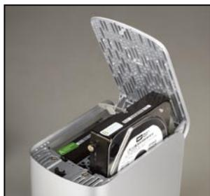
▲ 它的内部采用金属框架,硬盘装卸简单,但硬盘卡得比较紧,不易拔出来。
