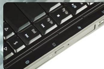
■ 键盘右侧的硬件和软件开关键,可以开关无线网卡、蓝牙、IE浏览器和收发邮件。
