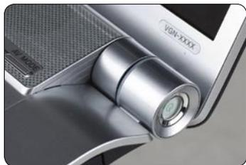
圆形的电源开关键位于转轴处,与线条流畅的弧形转角相得益彰。
