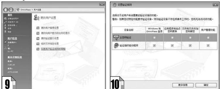
Omnipass控制中心,选择“更改用户设置”→“设置用户验证规则和策略”,相应选项勾选“验证指纹驱动程序”,开启指纹验证。选择对应最高级别的指纹安全保护,必须经过指纹验证才可登录,而若勾选主密码验证,只要输入的密码正确,即可登录系统。
