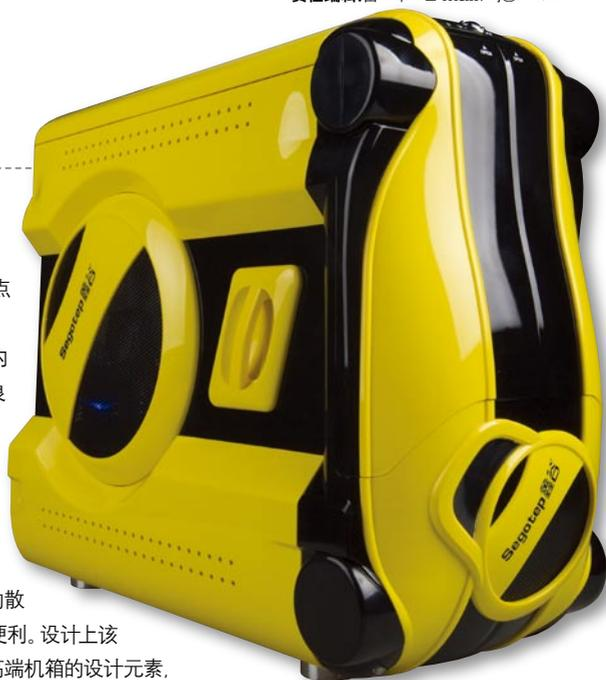
的散热风扇,同时机箱后部也预留8cm风扇位,再加上前面板下部的镂空网设计以及侧面25cm的大口径风扇,打造了一个立体的散热环境。
