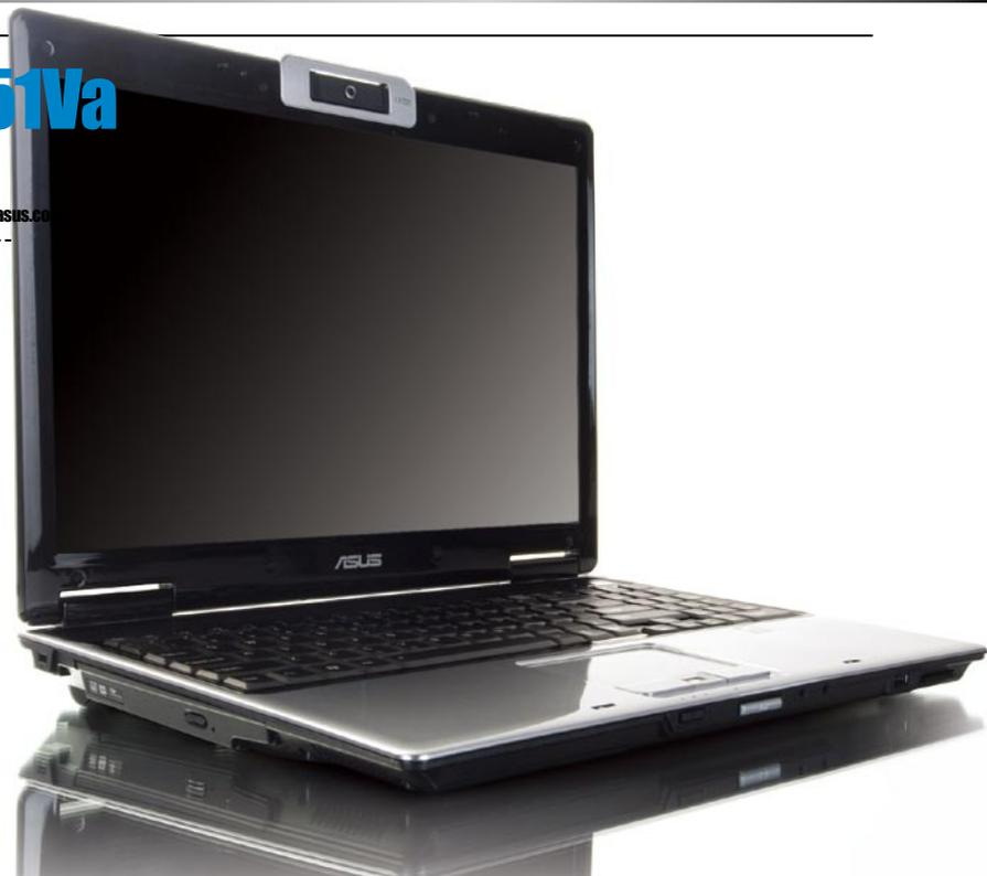
好成绩。性能测试的亮点来自于高清解码测试, 我们安装了PowerDVD, 选择了一段TS封装的VC-1编码1080P高清视频进行播放, 在性能监视器下观察到半个小时的播放过程当中, 处理器占用率一直维持在2%以下, 平均占用率仅为1.8%, 这意味着我们一边看高清电影, 一边还可以解压缩、安装程序、对视频编码……并保证整个系统的反应快速流畅, 而这一切都要归功于ATI Mobility Radeon HD3650显卡强悍的高清硬解码能力。
