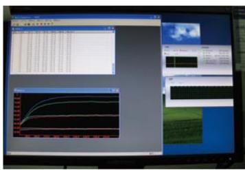
↑ 由于巨手实验机内部采用了多个传感器连接待测显卡, 因此工作人员可实时观察到显卡各部位的工作温度。
