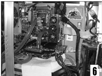
一般来说串联水路都是先经过CPU,再到北桥,最后经过显卡。至于为什么这样做,通过图6我们已经很清楚地看到了这种连接方式能够得到最短的机箱内部水路。不过此处需要注意:为了避免从北桥出来的水管要绕过显卡PCB板才能连接到水冷头,尽可能选择水嘴可以正反两面安装的水冷头。
