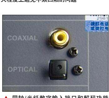
▲ 同轴/光纤数字输入接口和解码功能可让用户直接连接影碟机和Xbox360、PS2、PS3等游戏机。
