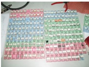
↑ 此外，研究所里有丰富的显卡原材料供设计师们进行选择、试用。如上图那些分门别类、排列工整的电容、电阻、保险丝等各种显卡所需材料。
