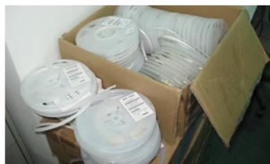
↑ 电阻卷，这个类似电影胶片的卷带里装有贴片电阻与贴片电容，可以通过SMT贴片机在显卡上进行安装。
