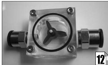
它的工作原理是水流推动其内部的水轮转动,使得原本不容易目测的水流变得更容易量化。这样一旦水泵罢工,水流指示器就会停转来警告用户(部分产品还有声音报警系统)。而且这个小东西还有另外一个作用,就是估测水冷系统中液体的流速。将它接在热排后面,就可以看出系统中水阻是否过大导致循环液流速偏慢,如果是那样的话就要换强力的水泵了。
