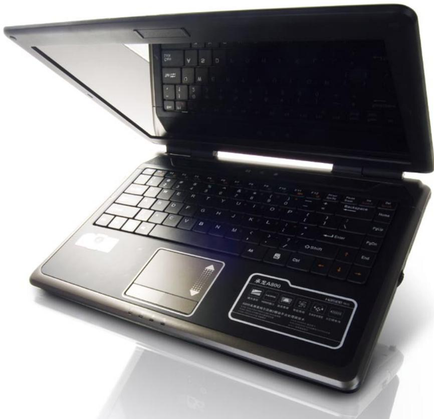
沾染指纹,膜内漾印技术的好处多多,既能提供类似钢琴烤漆工艺的镜面效果,又可以让顶盖更加耐磨,而且还能印出各种图案和花纹,像承龙A800的顶盖上就印上了莲花状的发散式暗纹,比较漂亮而且不会显得太张扬。除此之外,承龙A800的机身材质也处理得当,腕托和机身边框的手感相当细腻,而且质感也不错,塑料感在承龙A800上基本不见踪影,整体外观做工让人满意。
