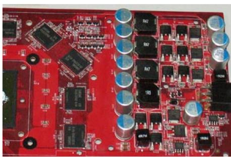
的固态电容大多是购买第三方专利生产的,自己并没有投入多少研发力量。不过三洋SEPC固态电容由于缺货,存在交货周期长的问题,因此目前不少高品质显卡仍主要选择日本化工PS系列固态电容。
