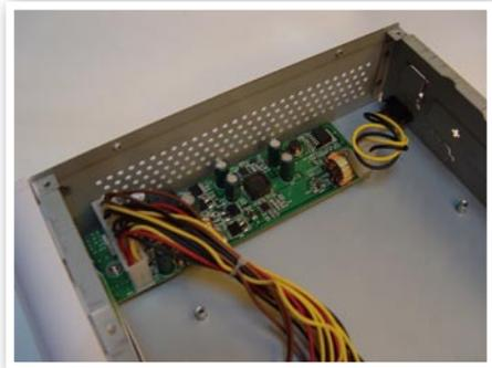
» 电源部分安装在机箱内部,但是不具有通用性,需要特定的机箱支持,能安装下电源PCB和接口。
