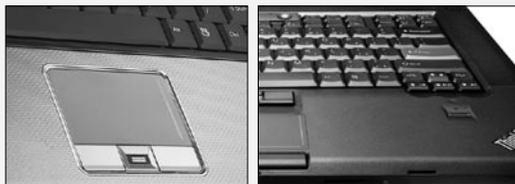
指纹识别器凹槽较深,不便于操作 右侧的指纹识别器操作方便
