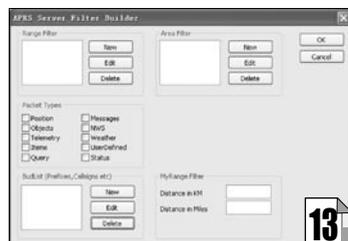
Range Filter是指定经纬度为中心指定半径的圆形区域内的过滤器,按New增加一个,按Edit编辑选中的Range Filter,按Delete删除选中的Range Filter,下同。Area Filter可以指定左上和右下经纬度的方形区域。Packet Types按照数据类型过滤,不选则接收所有类型。Budlist本意是友台列表,可以使用通配符指定固定前缀的台,比如B\*,表示B字打头的所有台,B是中国的业余电台前缀,因此可以接收到所有中国的台。MyRange Filter则是指定我台为中心,指定半径内的区域。请至少设置一个过滤器,否则有的端口(如14580)将不送任何数据过来。设置完成后点OK退出,你会发现外面的Filter框内自动产生了一句类似于我们上面指定的Filter r/30/120/2000这样的语句。这样,每次连接服务器的时候,软件自动发送这个Filter设置给服务器,服务器就会按照设置,只发送你需要的数据。
