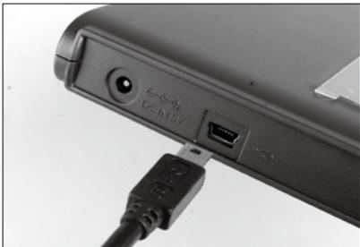
外置刻录机随机都会附送USB数据线、电源适配器。而外置刻录机机身一般为MINI USB接口, 附送的USB数据线一端为MINI USB接口, 另一端则为USB接口。正常使用的方法则是, 将USB数据线的MINI USB接口端连接到外置刻录机上, USB接口端则连接到电脑的USB接口上。
