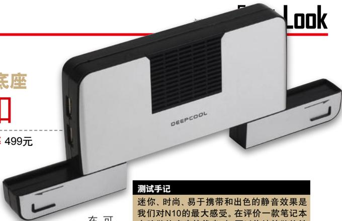
**初**看N10,难以想象它是一款笔记本电脑散热底座,因为它的尺寸只有153mm×93mm×23mm,这和一个普通的移动硬盘大小相仿,非常小巧。为了有效散热,它通过顶部的一个5cm涡轮风扇抽风,然后往底部排风,但N10四周并无散热孔,吸收的风量将如何排除呢?由于N10底部为可抽拉设计,将底部向两边抽拉后,可看到许多散热孔,涡轮风扇吸进的风正是从此处排出,并沿着底部向两端散开,最终为笔记本电脑散热。需要说明的九州风神N10测试成绩表(环境温度 $30^{\circ}\text{C}$ 摄氏度,表中温度为摄氏度,采用了某品牌的13英寸笔记本电脑作为测试基准)
