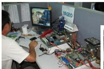
↑ 显卡在完成设计后，还需要专业的硬件调试工程师对iGAME显卡进行调试，如使用示波器等专业仪器来确定显卡电源部分的信号是否正常。
