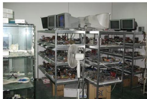
↑ 在兼容性实验室，大量七彩虹显卡、主板正在进行测试，为了模拟真实工作状态，在这间实验室里，只采用风扇对环境进行降温。
