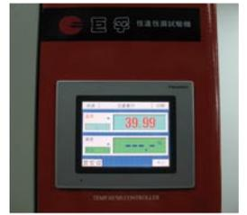
↑ 然后根据实验的需求, 设定一定的温度与湿度, 这样就可以让系统在各种不同的环境下进行工作, 考察系统的工作稳定性。
