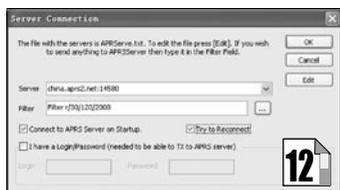
按照图示输入服务器为“china.aprs.net:14580”,这是中国的二层APRS服务器,
