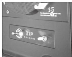
←机箱内大大小小的风扇运行起来噪音不小,因此我们在机箱前面板上自制了两个开关,大开关控制12cm风扇,小开关控制9cm风扇。夜间气温下降时可以关闭一些风扇以降低噪音。
