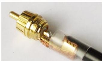
**图13:** 将弯曲后的铜芯插入内芯的接头头, 屏蔽铜丝向两边分开, 由SYV线压在接头头上。夹紧固定线缆的“抓片”, 并将铜丝反方向捻聚在“抓片”的下方。用电烙铁焊好铜芯和内芯接头头, 注意焊接点要饱满。套上塑料管套以固定住屏蔽网, 并保证屏蔽铜丝不会和内铜芯接触, 扭上外管套即告完成。
