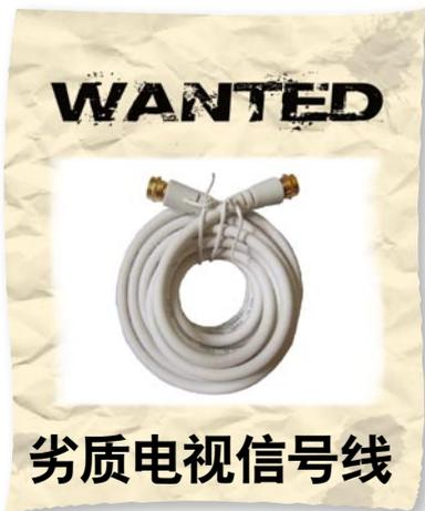
理发泡聚乙烯仅含有20%聚乙烯(实心聚乙烯含有100%聚乙烯材料),剩下的则是80%氮气泡。如此一来,线缆的介电常数 $\epsilon$ 值由实心聚乙烯的2.2~2.4变成了物理发泡聚乙烯的1.4,从而降低了同轴电缆的介电损耗,提高了SYWV线的传输性能。此外,以“-75-5”的同轴电缆为例,SYV线的内芯直径为0.78~0.8mm,SYWV线的为1.0mm,内芯直径的变大直接致使两种电缆在材质和长度相同的情况下,SYWV线内芯的直流电阻比SYV线的小。因此,带4屏蔽(屏蔽层分别为“铝镁丝、铝塑复合薄膜、铝镁丝和铝塑复合薄膜”)、64编(屏蔽网的密度,编数越高密度越大)的SYWV-75-5线更适合家用。当然,如果买不到这类线,可以选择正规厂商生产的有线电视专用线。
