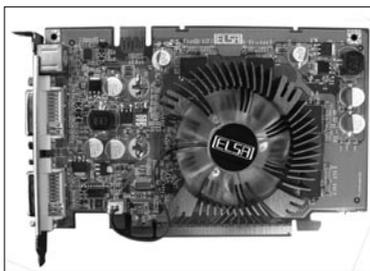
近日上市的艾尔莎影雷850GT钛金进化版860GT钛金进化版两款显卡均搭载了奇梦达1.0ns 256MB/128-bit GDDR3显存，默认核心/显存频率分别为580MHz/1800MHz和560MHz/1800MHz。在散热设计上，艾尔莎影雷者钛金进化版系列采用了日本NMB轴承设计和铝制鳍片超静音风扇散热系统，加上玫瑰金色的风扇，使它们拥有更长的使用寿命、更安静的作业环境及更强的性能。
