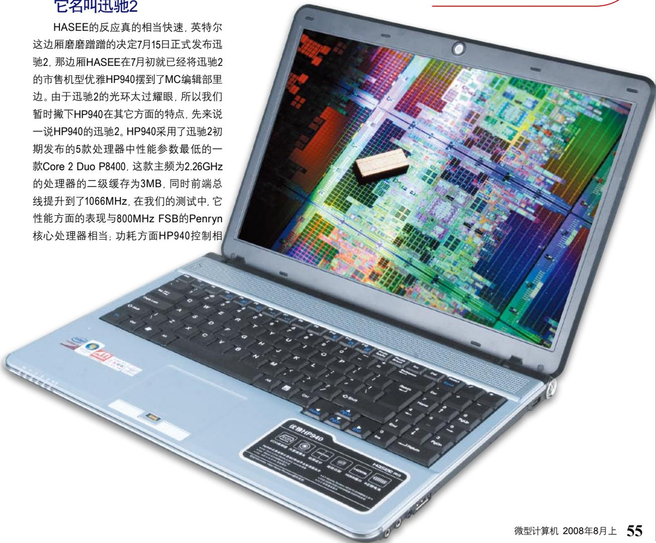
当得力, Core 2 Duo P8400的C6休眠, 据英特尔描述, 能够节电95%以上, 同时, 其25W的TDP也保持在较低的水平, 而在续航能力的测试当中, 我们也从侧面验证了这一点, 搭载了独立显卡并且散热并不出色的HP940在MobileMark2007测试中取得了203分钟的好成绩。此外, 在无线网卡测试中, HP940表现也相当优秀, 网络吞吐量达到了85Mbps以上, 是采用上代产品Intel Pro/Wireless 3965ABG无线网卡的三倍有余。
