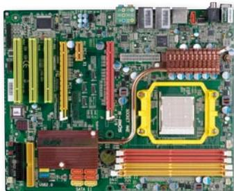
Nichicon LF系列及台系立隆OCR系列固态电容,并采用五相供电设计,为超频提供充分保证。不过我们认为取消视频接口会导致混合节能功能无法启用,这将给组建SLI的用户带来电能上的浪费。
