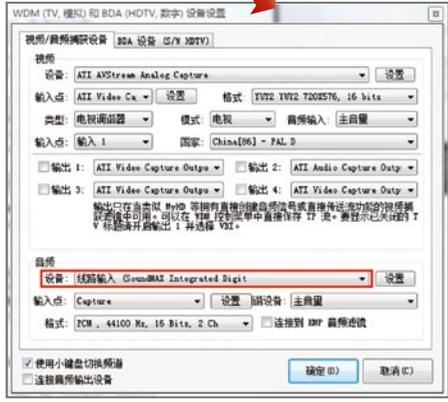
图15: 接着在音频部分,如果是兼容Media Center的电视卡由于其支持内建音频DMA通道峨峨峨峨峨峨峨峨阿,因此应该设置为电视卡的音频输出。而如果不兼容Media Center的电视卡同时又是通过电视卡输出模拟音频到声卡的Line-in接口的,应该在此处选择“线路输入”。
