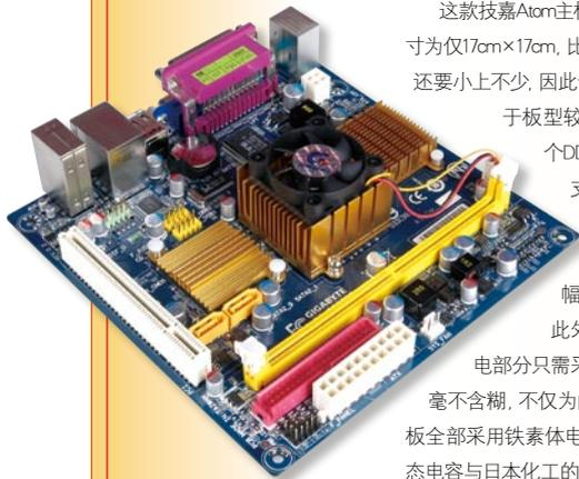
这款技嘉Atom主板GA-GC230D采用Mini ITX板型设计,其尺寸为仅17cm×17cm,比普通采用Micro ATX板型设计的整合主板还要小上不少,因此十分适合用户采用Mini机箱进行搭载。由于板型较小,主板只提供了一个PCI插槽,以及一个DDR2 533内存插槽。因此,尽管Intel 945GC支持组建双通道DDR2-533,但由于主板只有一个内存插槽,因此也只能组建单通道内存系统,对系统性能会造成小幅度的影响。
