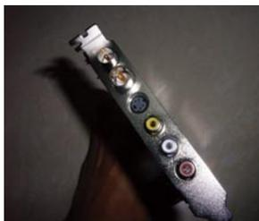
我们知道, 普通模拟电视信号是通过同轴电缆输入到电视机和电视卡的。而加装了高清机顶盒后连接方式发生了变化, 同轴电缆先连接到机顶盒, 然后由机顶盒将MPEG-2编码的高清信号进行解码, 通过S端子或者AV端子(复合视频端子)输入到电视机或者电视卡。这里笔者推荐使用红白黄的AV端子, 这也是目前电视卡和机顶盒配置最普遍的端口, 只需要将对应颜色的线插入电视卡和机顶盒两端就可以正常使用了(图5)。
