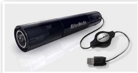
» 圆刚A850双模高清数字TV棒, 支持国标DMB-T/H及欧规DVB-T(该模式在我国部分地区仍有采用)两种模式的数字讯号。圆刚A850支持Vista操作系统, 可以实现H.264和MPEG-2格式的实时录像。该TV棒采用北京凌讯双模芯片, 针对内地用户。
