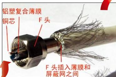
**图9:** 先把F头线缆固定环套入电缆中,再把铜芯、发泡绝缘体和铝塑复合薄膜穿过F头的圆孔,让其内壁套在发泡材料的铝塑复合膜上,而外壁用第一层屏蔽网包裹住。
