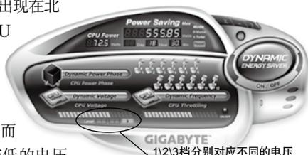
技嘉的DES技术在Windows里面就可以直接调节CPU电压
