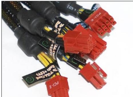
▲拥有3组PCI-E专用供电接头,每个接头都设计有磁环。
