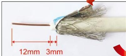
**图8:** 接下来是连接F头。把线缆另一端的长度约15mm的PVC护套剥开,将两层屏蔽网后翻并沿着PVC护套的边剪去最外层的铝塑复合薄膜。拨开最内层的铝塑复合薄膜(注意不要剪掉),除物理发泡聚乙烯材料留下3mm外,剪去剩余的部分。
