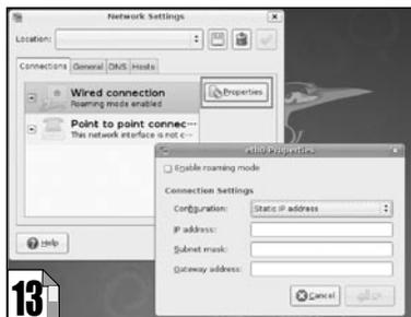
IP地址、子网掩码和默认网关,主机名在“General”选项卡中设置, DNS服务器地址在DNS选项卡中设置,最后点击“Close”就可以立即更新网络地址了(图13)。
