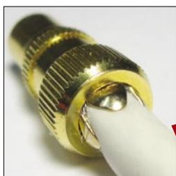
**图7:** 把线头插入管套,用手指从管套尾部用力,使线头转动拧入管套。
