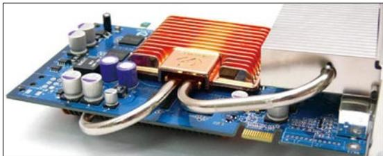
这种方案以技嘉的Silent Pipe为典型代表,强调的是卓越的静音效果,整体散热器以热管技术辅助散热鳍片进行,实现无风扇设计。不过,需要注意,这种设计虽然可以完美解决显卡噪音问题,但是前提是你的机箱内必须要有一个性能优越的冷却风道,一旦机箱内冷却风道不通畅,就容易导致热量的堆积而死机或者损坏显卡。
