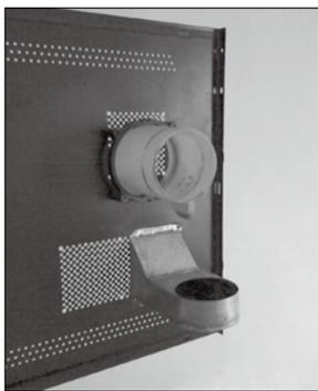
↑机箱盖没有38°C导风罩,我用塑料水杯和12cm风扇的支架做一个。为了加强显卡散热,也用铁皮一个显卡导风罩,完成后机箱侧面板上就有了两个导风罩。
