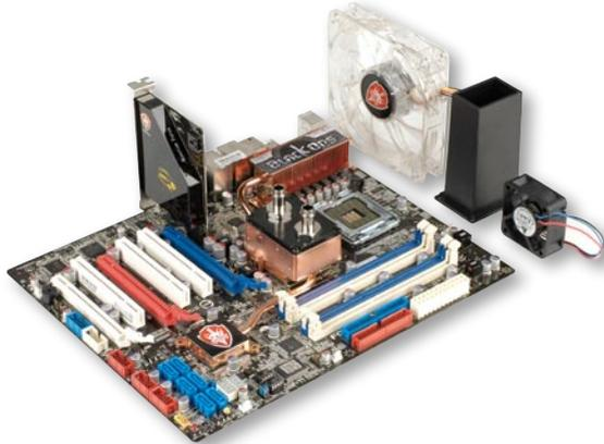
这款为超频设计的富士康BLACKOPS主板采用Intel X48芯片组。处理器供电部分采用8相数字供电设计,可避免出现大幅压降及漂移现象的发生。此外,主板采用一体式纯铜热管散热器覆盖主板南北桥、供电模块,并通过纯铜热管连接,组成高效的循环散热系统。特别的是,其北桥散热器提供了水冷、风冷、液氮等多种散热方式,并相应地附送了台达暴力风扇(转速近7000rpm)、液氮蒸发器等附件。
