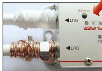
**图11:** 把两层屏蔽网翻转,再用铜丝捆绑后连接到信号放大器的接头上,最后把制作好的线缆插入放大器的接头,旋紧螺帽即可。有条件的朋友,还可在接头处缠上生料带,以免接头因氧化而致使信号电平衰减增大。
