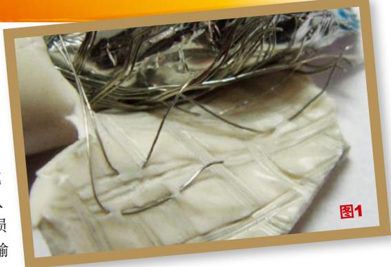
**● 线索分析:**如今有线电视模拟信号基本都是采用同轴电缆传送的,而家用常见的电视信号线多为SYV-75-5和SYWV-75-5同轴电缆。“-75”表示电缆的阻抗为75 $\Omega$ ,-5”表示线径为5mm。SYV线和SYWV线的统称为射频同轴电缆,有所区别的是,SYV线内芯的绝缘层使用的是实心聚乙烯,而SYWV采用的是物理发泡聚乙烯。物
