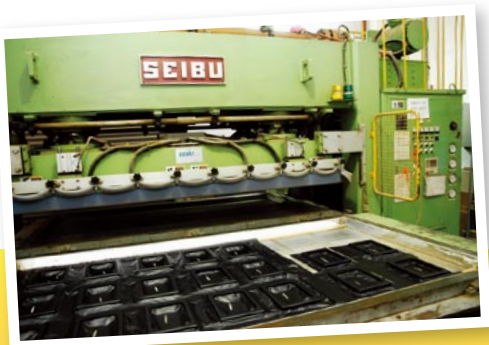
■ 经过初步加工的木料送进真空贴皮机,经过1分30秒加压加热抽真空后,就完成贴皮工序了。
