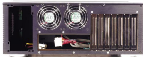
» 机箱后面的两个80mm风扇可以有效地加强整个机箱的内部散热,但运行时噪音较大。
