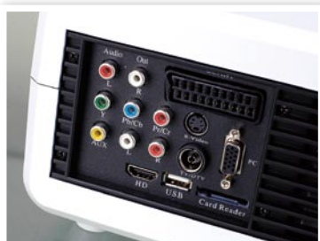
» SVIC S700HDC的视频接口非常丰富,拥有色差、HDMI、S-Video、D-Sub、CATV、复合视频等。它还拥有SD读卡器,支持存储卡的媒体播放。
