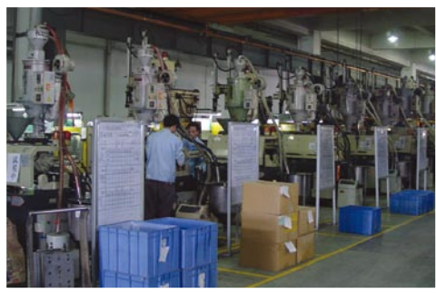
■ 规模的大型注塑成型机。塑胶原材料被送入并加热融化,最终在机器的精密控制下注入模具中成型。
