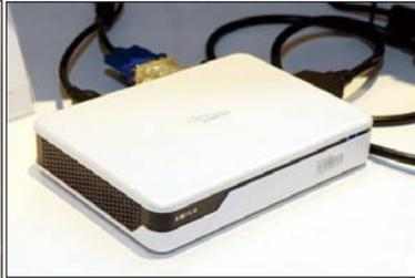
ATI XGP外接图形平台技术,全名叫eXternal Graphic Platform,原本用集成显卡的PUMA NB只要一接上这个装置,就能有桌面PC般的图形性能。图中这台是Fujitsu Siemens的XGP产品,名字叫AMILO GraphicBooster,内建ATI HD3870图形芯片(512MB GDDR3),有独立的电源跟散热系统。
