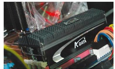
↑ 被动散热模组,适合我这种追求静音的用户。
