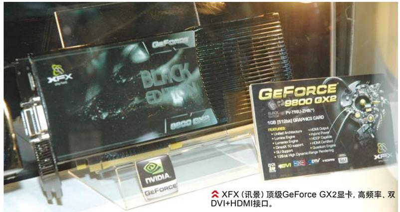
XFX (讯景) 顶级GeForce GX2显卡, 高频率, 双DVI+HDMI接口。
