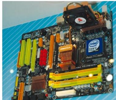
映泰全新TPower系列P45主板, 采用混合式散热技术。
