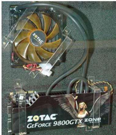
ZOTAC (索泰) 带来水冷散热的GeForce 9800GTX显卡, 更有利于超频。
