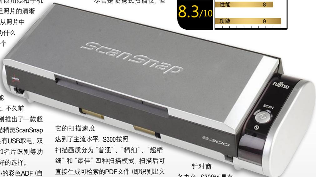
它的扫描速度达到了主流水平。S300按照扫描画质分为“普通”、“精细”、“超精细”和“最佳”四种扫描模式,扫描后可直接生成可检索的PDF文件 (即识别出文字,可供复制或JPG图片。在“普通”画质下 (即高速扫描模式),我们使用电源适配器时,它最快每分钟可以扫描8张A4文档。然后我们换用USB取电,它的扫描速度就降低了一半,最快每分钟可扫描4张A4文档。而在“最佳”画质下,扫描时间达到了“普通”画质的3倍,生成的PDF文件容量是后者的10倍左右,但扫描画面的细腻度和清晰度都有较大提升,更加接近原始文档。此外,S300具有自动彩色/单色识别、文字清晰处理、跳过空白页、方向调整、倾斜校正和压缩比调节等功能,都非常实用。
