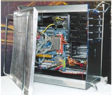
T的极品水冷机箱, 侧盖像空调的散热排一般。谁能用到这么High的机器?
