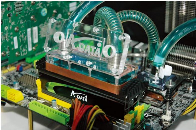
↑ A-DATA最新X系列极品超频内存,最大特点除了超频以外,散热模组可以自由选择更换,图中为水冷散热模组。
