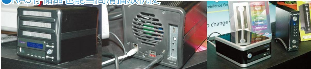
这台由Thecus (色卡司) 公司推出的NAS网络存储器除了能装4台3.5英寸硬盘组成RAID外, 还有一个最大的不同: 竟然带有HDMI视频和SPDIF音频接口。它的型号是M3800。
