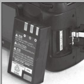
图7 数码相机上使用的锂电池
