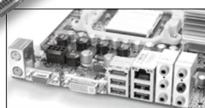
凭借板载128MB三星显存、附送DVI转HDMI转接头、高保真耳机、可支持双卡交火、混合交火、全板全富士通固态电容以及优秀的处理器超频能力, 悍马HA06目前应是780G主板中最有知名度的一款产品。然而在我们的实际测试中发现, 当主板在UMA+SidePort模式下对处理器与显示核心同时超频后, 该板也会出现明显的花屏现象, 即便在仅250MHz的外频, 花屏也十分明显, 而且其北桥电压最大只能调节在1.2V左右, 因此GPU工作频率只能超频到750MHz左右, 所以目前的悍马主板还无法同时将处理器、图形核心的最大效能都发挥出来。它更适用于偏向处理器超频、注重默认性能以及做工、功能的用户考虑。
