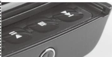
↑ 音乐快捷键的表面微微凸起 (N95的表面很平), 已被滑盖的底部磨花。
