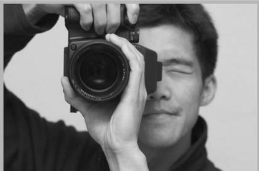
图4 由CONTAX 645机身+已被改造的Megavision FB4040数码后背组成的光场相机。
