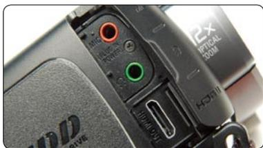
■ MIC、耳机以及HDMI输出接口,通过HDMI接口,可以直接将拍摄的视频在支持FULL HD的显示设备上回放。
