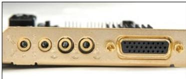
❖ X-Fi XtremeGamer FPS最上面的一个接口是Line in, MIC in, Digital Out的三合一接口, 这种接口是创新特别设计的, 要进行数字输出, 就得购买数字I/O模块。
