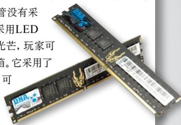
总的来说,2GB DDR2 800内存由于采用了16颗内存颗粒,颗粒之间的协同工作难度更大,超频能力普遍不如1GB DDR2 800内存,在普通超频条件下无法超频到DDR2 1066下稳定运行。因此我们建议游戏玩家在装机时采用2GB DDR2 800内存,用更大的内存容量让游戏运行更加顺畅,而硬件发烧友则最好购买1GB DDR2 800内存,配合更好的超频环境冲击最佳内存频率和时序。
