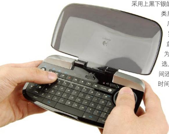
把后部的切换开关扳动到PS3选项。diNovo迷你提供了一个USB接口的蓝牙接收器，在拥有蓝牙适配器的电脑和PS3上使用时，就不需要使用接收器了。
