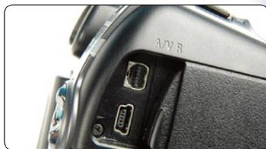
■ A/V视频输出接口,可以输出到支持A/V视频接口的显示设备上。同时,通过MiniUSB接口可以将SR12E当作移动存储设备使用,也可以直接将拍摄的高清视频复制到电脑上。
