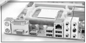
这款主板的最大特点是除了处理器供电部分采用富士通固态电容外, 在主板其他部位, 如内存供电部分、PCI插槽供电部分等也全面使用富士通固态电容, 构成全板全固态电容的精良配置, 进一步增加主板工作的稳定性。此外该板具备普通780G主板所没有的两根PCI-E x16插槽, 通过附送的Switch Card, 它不仅可组建混合交火, 还可以组建双卡交火, 为用户提供更好的升级保证。接口上, DVI与HDMI一个都不少。不过该板的整合GPU超频能力较差, 在1.25V下只能最高超频到700MHz, 此外南北桥散热片的性能一般, 在满载情况下比较烫手。
