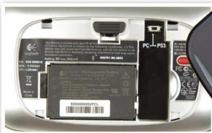
后部的电池安装位，右上角有PC和PS3的切换开关。
