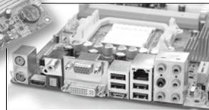
与前面的780G主板相比, 磐正这款产品的最大特点是同时具备光纤与同轴两种数字音频接口, 让音频发烧友能更方便地连接各种功放。此外, 该板具备较好的做工与用料, 处理器供电部分采用日本化工PS固态电容, 拥有较强的处理器超频能力, 而像eSATA硬盘接口、HDMI、DVI视频接口也都完全具备。缺点则是GPU超频能力有限, BIOS里最大可调GPU频率只有700MHz。
