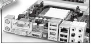
该板是一款整体功能与性能均不错的产品, HDMI、DVI、VGA、SPDIF、eSATA一应俱全, 它还集成了德州TSB43AB23控制芯片, 为主板提供两个IEEE 1394接口。此外, 该主板对CPU与GPU都有较好的超频性能, 其GPU频率也达到了无显存780G主板里900MHz的最高水准。此外, 该板也配有PI3HDMI412FT高清晰视频信号切换IC, 为用户提供更好的视频输出质量。当然, 它也有较明显的缺点, 其北桥散热片散热性能较差, 超频时, 最好加装其他辅助散热设备。
