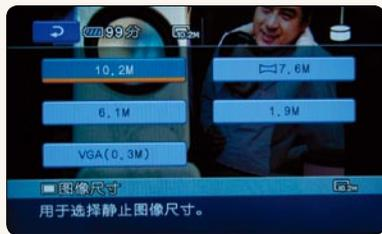
■ 静态照片拍摄,共有五种模式供选择。其中10.2M模式达到了3680×2760的超高分辨率,而最低的VGA模式则只有640×480的分辨率。
