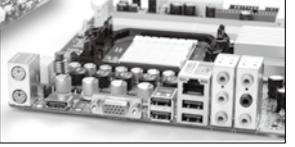
盈通A78G主板采用小板设计, 具备D-Sub、HDMI、DVI (通过附送的HDMI转DVI转接头实现) 三种接口, 适合HTPC玩家选用。处理器供电部分采用五相供电设计, 并搭配富士通固态电容, 增强主板工作的稳定性。超频性能上, 该板对处理器具备较好的超频能力, 可轻松将双核闪龙送上2.88GHz的高频, 此外比较有特色的是, 主板板载debug灯, 方便用户了解掌握运行情况。不过该板整合的GPU超频能力较差, 在1.2V下只能最高超频到700MHz, 无法充分借助2.88GHz双核闪龙处理器的威力, 获得更好的游戏性能。
