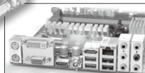
该板是一款综合性能比较好的产品, 除了具备较好的用料与做工, 像HDMI、DVI、VGA视频接口, SPDIF音频输出它都一一具备, 而且利用SB700南桥可以连接eSATA存储设备的能力, 该板拥有780G主板中少见的eSATA接口。超频方面, 它对处理器与整合GPU都具备较好的超频能力, 此外, 在主板HDMI接口附近还配有PI3HDMI412FT高清晰视频信号切换IC, 理论上将具备更好的EMI性能, 为用户提供更好的视频质量。唯一不足的是, 其南桥散热片发热量较高。
