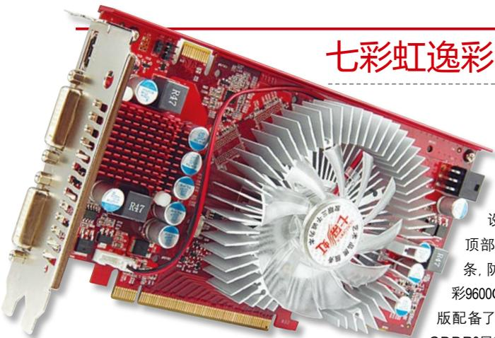
这款显卡采用非公版设计,是在PCB板顶部加装了一根金属条,防止PCB弯曲。逸彩9600GSO-GD3 CF黄金版配备了6颗1.4ns的三星GDDR3显存,组成384MB容量。由于是面向主流用户的产品,所以它
