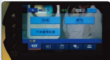
■ 3.2英寸的触控式LCD显示屏。与SR8E一样,几乎所有的相关操作与设置都可以通过这个触控式的显示屏完成。
