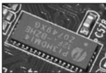
PI3HDMI412FT这颗HDMI应用视频信号开关，PERICOM官方数据看，1.65Gbps数据带宽正好符合1080P输出要求，可完整满足高清和图形输出，其他不具备该芯片的780G主板，由于输出的数据带宽不够，只勉强将1080P片源以720P大小来输出，画面损失毋庸质疑。
