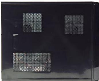
» 侧面板和机箱顶盖上的镂空网设计,增加了散热
