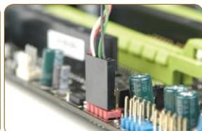
同样,在tagan BZ 1100电源上也能看到普通电源没有的USB连接线
