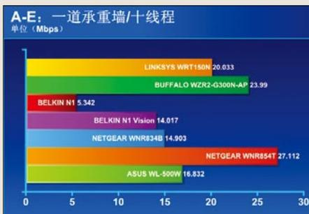
» 与单线程的情况类似, NETGEAR WNR854T的速度下降幅度较小, 无线传输速度比其它产品更高。
