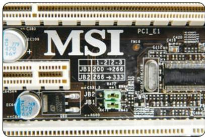
▲ 比较特别的是,这款主板具备一个外频跳线,通过它,玩家可直接设定CPU最低外频,方便超频。不过如图所示,其最高频率只能设定在333MHz,对于目前购买Intel E8XXX系列CPU的用户来说用处不大。
