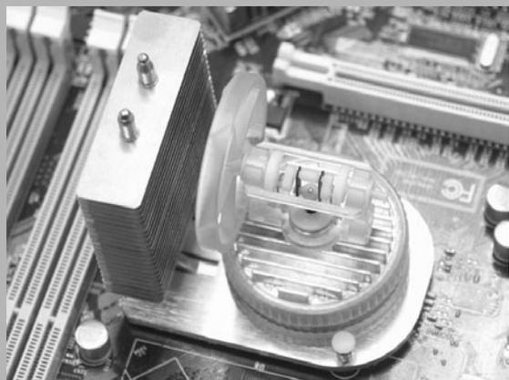
图4 外观和传统风冷差不多的ECOlution散热器,在动力上另辟新路。
