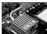
狙击手DEG53-GA玩家限量版采用Silent-COOL热管，在用户超频时能及时将芯片组及MOS管热量由CPU风扇带走，并有效降低运行噪音，同时避免因风扇故障而过热导致主板损坏!
