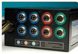
采用模块化接口,以颜色进行区分,同时每个接口还配有同色LED灯,工作时所有灯同时亮起,营造出绚丽、科幻的气氛
