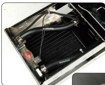
❖ 采用全铝高密度散热排,大幅增加散热面积,并采用Dimple Tube技术将冷却液以旋转方式流过散热排,增加散热效率。
