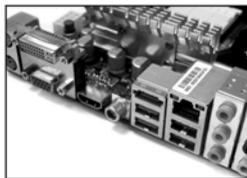
780G采用VGA+DVI+HDMI全接口配置，输出方面给用户多种选择，不过DVI和HDMI都采用同一组数字接口，由于市售780G在切换开关上缩减成本，一般780G在经过信号转换后，只能输出720P分辨率的视频信号。
