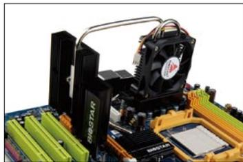
▲ 比较特别的是,利用MOSFET散热片上的两个螺丝孔,在映泰TF8200 A2+主板上居然还能再安装一套由显卡散热片加排气式风扇组成的混合散热系统。
