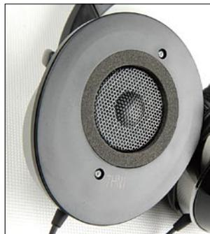
▲ 拆下耳罩, 通过塑料外壳的透声孔就能隐约看到Aurvana Live! 的驱动单元。
