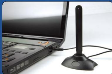
■ Y710内置电视卡,通过连接线缆或者无线电视信号接收器,可以收看有线或者无线电视节目。
