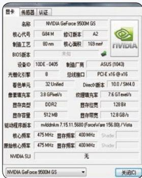
■ GeForce 9500M GS显卡GPU-Z截图,采用G84M核心,流处理器为32个。GPU-Z未测知流处理器频率,NVIDIA官方数据流处理器频率为950MHz。
