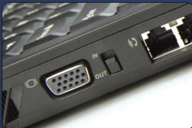
■ VGA接口旁边设计了一个小开关,开关设为“OUT”时将Y710的画面输出到其它显示设备,设为“IN”时把其它电脑的画面输出到Y710显示屏上。
