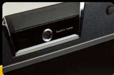
蓝宝石表面材质的130万像素摄像头,其上方采用了橡胶材质,可以让打开显示屏时的手感更为舒适。
