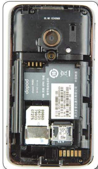
取下电池后, 才能看到SIM卡和MicroSD存储卡插槽
