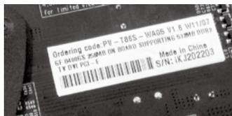
XFX讯景PV-T86S-WAG5显卡的标签上清楚说明板载显存容量只有256MB
