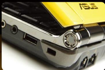
转轴顶端设计与汽车轮毂相似的造型,而且下方的凸起可以起到类似汽车保险杠的作用。
