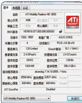
■ Mobility Radeon HD 3650显卡GPU-Z截图,流处理器数为120个,采用M88核心,不过GPU-Z并未正确识别出这款显卡的核心频率和显存频率。
