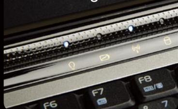
圆柱形转轴的中央位置设计了状态指示灯,白色的LED背光很醒目,不过在光线较暗的情况下比较刺眼。
