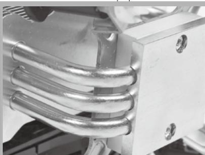
图2 热管散热器是目前市场的主流
