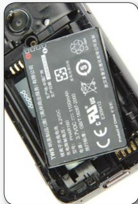
1100mAh的电池, 实际待机时间在50小时左右
