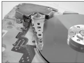
传统硬盘读取数据的方式(飞速旋转的盘片,磁头带着磁头“低空飞行”)
