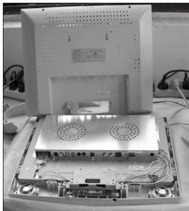
LCD显示器内部用于预防电磁干扰的金属屏蔽罩,大家在购买时可以通过显示器背部的散热孔检查该设计是否“缩水”。
