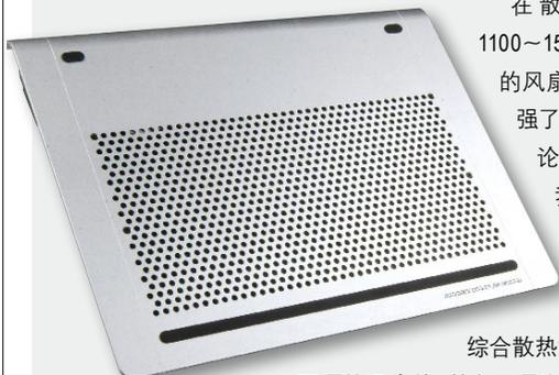
在散热设计上,它采用了两个转速为1100~1500rpm(提供转速调节功能)、直径7cm的风扇。表面高达928个的通风孔也有效地加强了散热性能。此外,ZM-NC2000的风扇无论是全速或降速状态,噪音都非常低,在我们这次所有的参测产品中都算是非常安静的,这无疑是在追求极致静音用户的福音。
