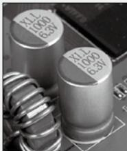
上为中低端显卡上常见的所谓“固态电解电容”,其顶部有明显的防爆纹,中为质量较好的三洋SVP固态电解电容(顶部无防爆纹),下为“XLL”牌液态电解电容,外部用铝皮包裹,且顶部无防爆纹,让人误以为是固态电解电容。
