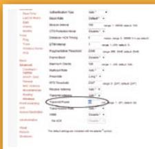
» 部分无线路由器在刷写番茄固件后,也能调整信号的发射功率。
