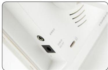
❖ 右侧除了电源接口外,还有一个音频输出接口
