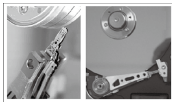
传统硬盘的磁头停靠方式(左)与零磁头接触硬盘的停靠方式(右)
