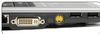
■ HP900的左侧机身接口,USB接口之间以及S端子的距离过近,体积稍大的设备安装时可能产生冲突。
