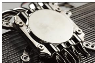
▲底座平整如镜,能保证与显示核心紧密接触
