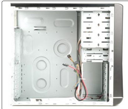
▲ 清爽的内部空间和免工具的3.5英寸硬盘安装位
