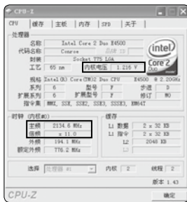
关闭节能技术(左),与开启后(右) Intel处理器的主频、电压以及倍频的对比。
