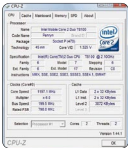
■ CPU-Z截图清楚显示出这款机器采用了最新的45nm处理器,支持SSE4.1,在性能上比上一代产品更好。
