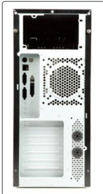
▶ 背部的12cm风扇位和水冷进出孔
