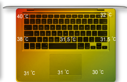
MBA的散热孔，散热孔附近温度较高，但尚在可接受的范围之内，散热孔的做工非常精致。右图为MBA的温度分布示意图，红色为高温，绿色为低温。
