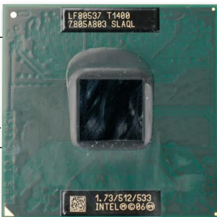
■ Celeron T1400处理器,采用Merom核心,Socket P (478针)接口。
