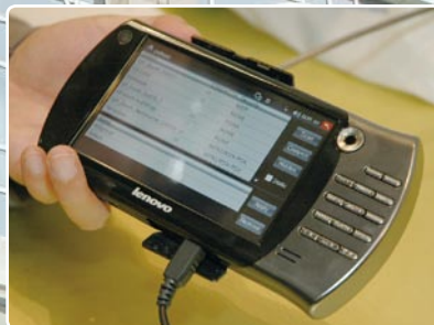
联想展示的MID样机,可以上网、聊天、GPS定位,MP3、MP4,收发电子邮件。基于Intel“凌动”(Atom)处理器,界面很像苹果的iPhone,可以用手指在屏幕上拨来拨去进行操作。
