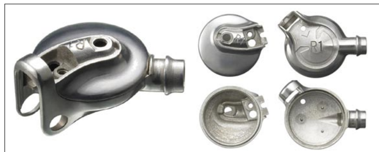
在耳塞本体的设计上,EX700SL采用了镁合金。相比铝材质,镁合金更为轻盈,同时EX700SL的机身和驱动单元结合在一起,可以减少很多不必要的振动,对音质提升有一定帮助。
