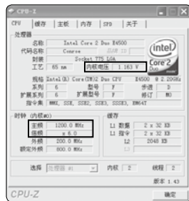
关闭节能技术(左),与开启后(右) Intel处理器的主频、电压以及倍频的对比。
