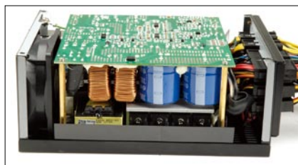
▲ 双层PCB设计使得元件密度大大降低
