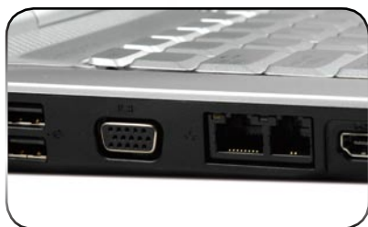
■ 这款机器还配备了HDMI接口,方便用户接驳大屏幕显示设备。
