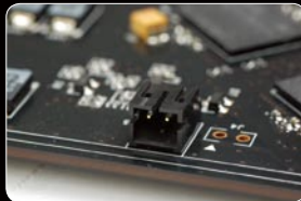
❖ 同轴/SPDIF音频接口, 可以从声卡中输入音频, GeForce 9800 GTX将其转换为HDMI音频信号, 再通过DVI转HDMI接口输出音视频混合HDMI信号
