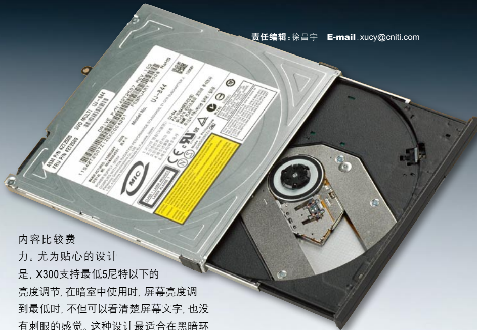
■ 7mm厚度的超薄光驱,支持DVD Super Multi,开合距离明显比普通光驱要短。
