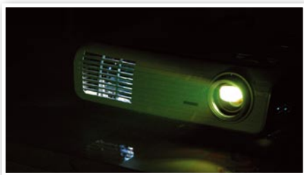
» 散热孔在镜头前方,也是主要的漏光点。
