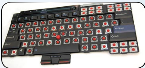
■ 拆下键帽的键盘图片，弹性极佳的“胶皮碗”带给这款键盘极为优秀的使用手感。
