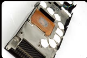
❖ 铜底热管散热系统, 与GeForce 8800 GTS使用的散热系统相同
