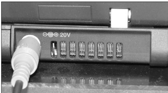
进出风口也是灰尘集聚的地方,最好打扫干净保持散热通畅。
