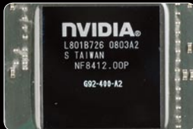
❖ G92核心, 65nm制程, 核心面积为330mm 2
