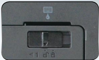
■ X300改用了长条形的排水口,排水能力更胜一筹。
