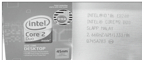
Core 2 Duo E8200拥有2.66GHz的主频、6MB的二级缓存、333MHz外频, 前端总线为1333MHz。
