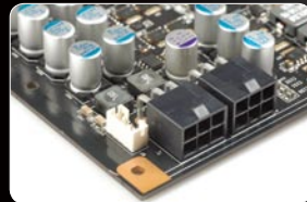
❖ 两个6-pin电源接口, 旁边是散热风扇的3-pin电源接口
