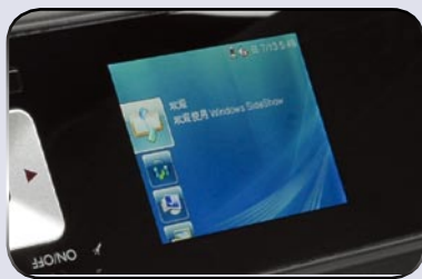
■ 位于显示屏顶盖下方的2.5英寸显示屏就是SideShow的关键,显示屏上方有亚克力材质透明挡板,可以提供足够的保护。
