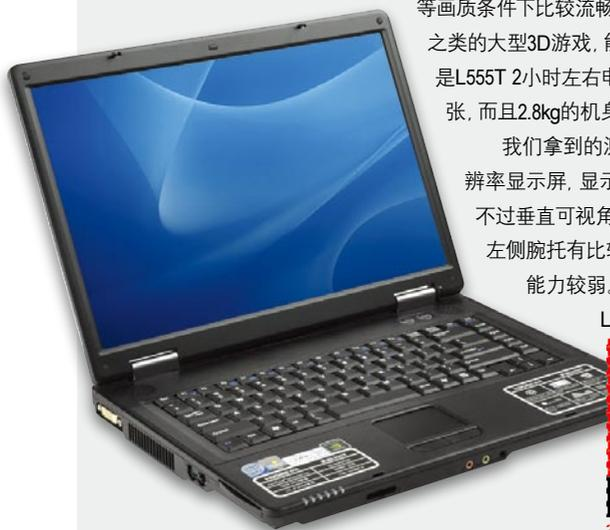
我们拿到的测试样机采用了1680×1050的高分辨率显示屏,显示效果精细,水平可视角度一般,不过垂直可视角度较小。烤机半小时之后,L555T左侧腕托有比较明显的温度升高,相比之下散热能力较弱。另外,我们可以比较方便地对
