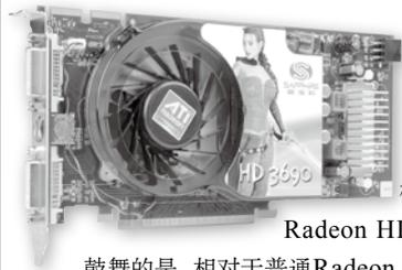
价格在89元左右的蓝宝石Radeon HD 3690显卡采用与Radeon HD 3850相同的RV670核心,拥有320个流处理器及完整的UVD通用视频解码器,唯一的缩水只是将显存位宽由Radeon HD 3850的256-bit减为128-bit,这种配置令千元内显卡的性价比达到了一个新的高度。更让人鼓舞的是,相对于普通Radeon HD 3690,该卡独家采用千元级显卡HD 3850的PCB,其核心与显存工作频率由普通Radeon HD 3690的670MHz/1660MHz提升到702MHz/1692MHz,具备更好的游戏性能。总体来看,蓝宝石Radeon HD 3690是一款注重品质的高性价比产品,适合主流游戏玩家选用。
