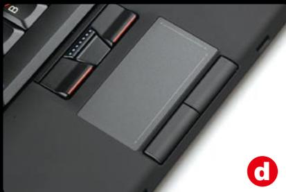
■ X300的掌托稳固而坚实,也采用了全新配置的涂料,手感出色。触控板面积稍小,但操作感极佳,移动顺滑流畅。触摸板上方的按键恢复了原来的红蓝两色设计。
