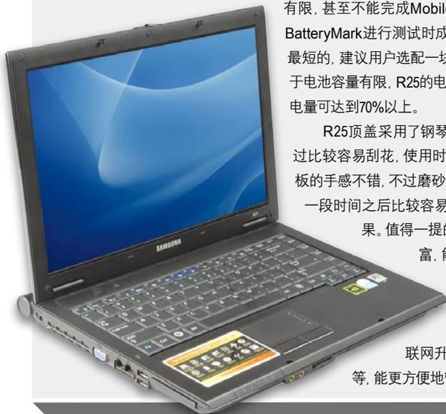
R25顶盖采用了钢琴烤漆处理,比较显档次,不过比较容易刮花,使用时需要小心保护。键盘和触摸板的手感不错,不过磨砂质感的键盘和触摸板在使用一段时间之后比较容易变得油亮,影响整体外观效果。值得一提的是,R25的附加功能非常丰富,能轻松进行操作系统备份和还原的Recovery Solution II、管理和播放音/视频文件的Play AVStation和自动联网升级驱动程序的Update Plus等,能更方便地管理和使用R25。
