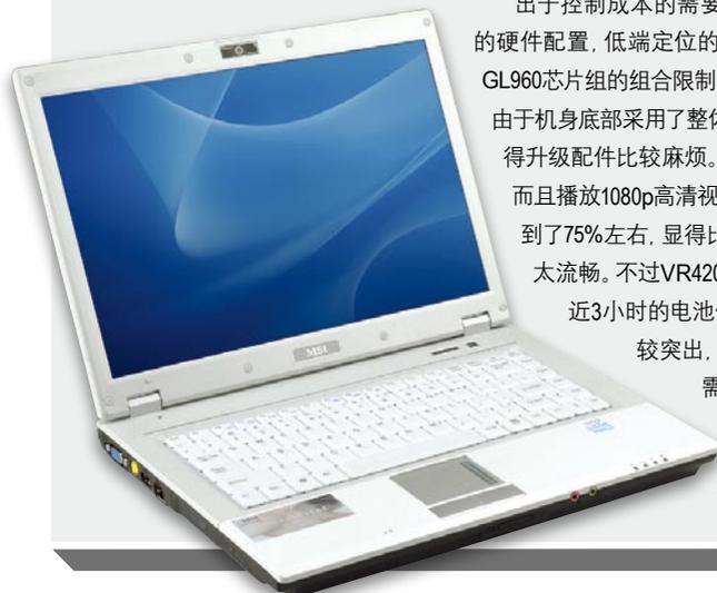
出于控制成本的需要,VR420采用了比较低端的硬件配置,低端定位的Celeron M 540处理器和GL960芯片组的组合限制了VR420的性能发挥,而且由于机身底部采用了整体设计,没有单独的模块使得升级配件比较麻烦。VR420的测试成绩偏低,而且播放1080p高清视频时处理器占用率基本达到了75%左右,显得比较吃力,而且画面有些不太流畅。不过VR420的电池续航能力不错,接近3小时的电池使用时间在参测机型中比较突出,较好地保证了外出使用的需要。另外,VR420的散热表现较好,烤机半小时后机身温度变化不大,不会对操作产生影响。
