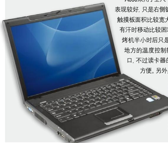
A650采用了全尺寸键盘,键程键距和按键弹性都表现较好,只是右侧键盘的底部支撑稍稍有些松动。触摸板面积比较宽大,不过表面有些过于光滑,手指有汗时移动比较困难。A650的散热能力中规中矩,烤机半小时后只是触摸板处有些温度升高,其它地方的温度控制较好。A650提供了常用的扩展接口,不过读卡器的位置设计不佳,使用起来不太方便。另外,A650能比较方便地升级硬盘、
