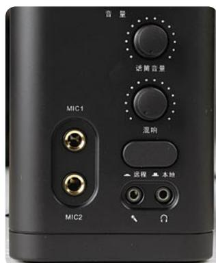
▲ “音效处理中心”盒子上具备两个6.35mm麦克风输入接口, 并且还对话筒音量和混响进行调节。
