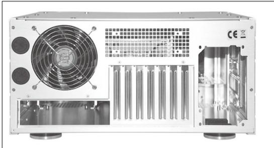
图4 采用9cm×2+12cm风扇的散热设计
