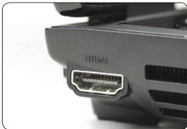
■ 机身左侧的HDMI接口,可以方便地外接显示设备
