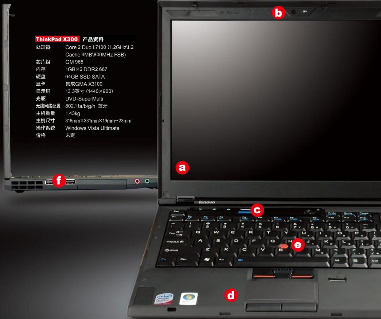
轻薄机型往往代表脆弱,这已几乎成为业界的共识,不过这一点可能要在X300身上改写。曾经有测试表明某款ThinkPad机器从两米高处落下,机壳摔裂,但仍可以正常开机使用,很大程度上就是依靠坚固的防滚架。X300没有为了轻薄而对安全性能有所减省,相反,它第一次在X系列机型上布置了加强型复合材料防滚架,而且在重要部位,如脆弱的超薄光驱处,设计了类似于“蛛网”的结构,尽可能地保护重要部件不被重物砸中时产生的强大冲击力破坏。而掌托处的设计也更为牢固。一些笔记本电脑掌托处采用大面积塑料材质,下部仅用类似于方格的结构来承受重量,或者干脆就是一块整板,无任何结构上的加强。这种设计虽能节约成本,但手感不佳,掌托处稍加力按压即出现轻微变形。如果说键盘处被砸尚有键帽可以作为缓冲外,那么掌托处就是“硬碰硬”,重物砸下甚至会直接“破洞”。X300的加强型防滚架也布置在掌托之下,可以有效保护掌托下的设备。使用中时感到掌托稳固,大力按下也不会变形。由于改进了防滚架的设计,根据联想提供的数据, X300
