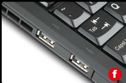
■ X300提供了3个USB接口,不过左侧两个接口过于靠近散热孔。好在距离较远,同时使用也不会出现设备“打架”的情况。
