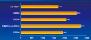
升到标准的266MHz时,它的频率就可以达到2.93GHz,当外频提升到300MHz时,加压至1.4V后,它的频率甚至可以达到3.3GHz,综合性能大幅度提升。
