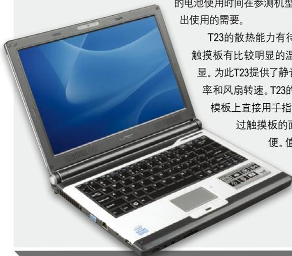
T23的散热能力有待加强,烤机半小时之后腕托和触摸板有比较明显的温度升高,而且风扇噪音比较明显。为此T23提供了静音模式快捷键,能降低处理器频率和风扇转速。T23的触摸板支持“魔法手指”,在触摸板上直接用手指写汉字便可以完成输入操作,不过触摸板的面积有限,使用起来并不会很方便。值得一提的是,T23的显示屏可视角度出色,亮度和对比度表现不俗,很适合观看大片。
