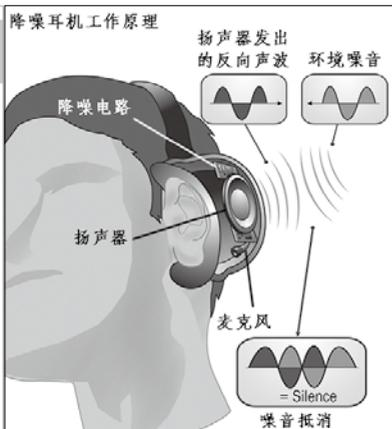
图1 降噪耳机的系统构成
