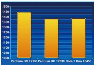
■ 由于3DMARK 06对频率更为敏感,因此高频的T2130获得测试的最高分
