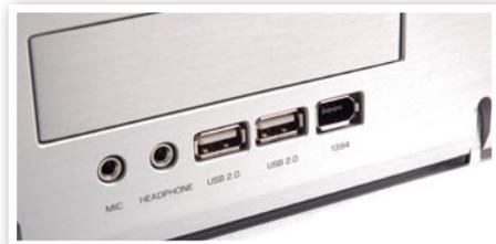
» 前置接口，包括两个USB 2.0、1个IEEE 1394、麦克风、耳机插孔
