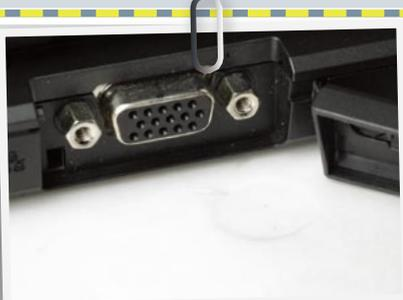
■ VGA输出接口处设计了橡胶挡板,既能保持外观整体性,又能起到防尘和保护的作用。
