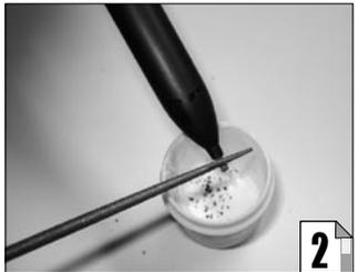
匀。如果在搅拌的过程中发现有比较明显颗粒状的石墨及杂质(如木屑),要将其剔出以免产生不良影响。小颗粒的石墨可以不用管,石墨质软,在散热器扣具的压力下这些颗粒就会变成粉了。搅拌均匀后的硅脂呈灰色,石墨与硅脂的量的比例可以任意,当搅拌到你自己认为满意的程度就可以算完成了。
