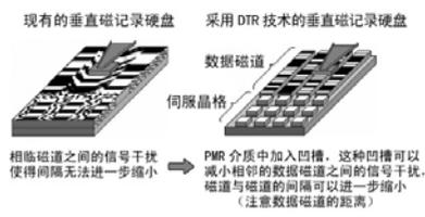
图3 离散磁道记录技术细节
