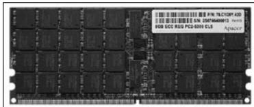
继4GB DDR2-667 ECC Registered DIMM后，Apacer宇瞻又推出了一款高端服务器内存产品——8GB DDR2-667 ECC Registered DIMM。这款产品采用70nm制程工艺，默认工作电压为1.8V±0.1V，CL=5，是宇瞻继4GB产品后进一步针对AMD Opteron架构服务器开发出的超高容量专用内存。
