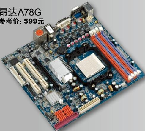
780G芯片组采用了最新的55nm工艺制造,FCBGA封装。芯片的面积非常小,大小为21mm×21mm。780G芯片组拥有非常低的功耗,在保证性能最优的情况下,极大地提高了电脑的能耗比。其中,RS780北桥和SB700南桥的TDP (Thermal Design Power) 功耗分别为15W和4.5W,待机功耗小于1W。
