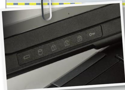
■ 显示屏边框上设计了丰富的状态指示灯,可以方便的掌握机器运行状态。
