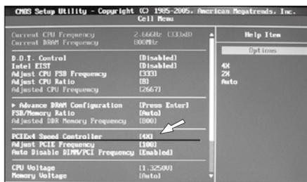
BIOS中关于第二根PCI-E显卡插槽的设置选项
