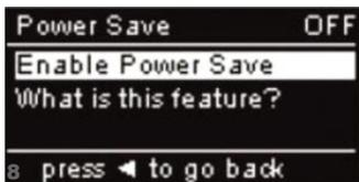
6.功能菜单:无线加密、帮助与提示、节能。7.无线加密功能包括来宾访问和WPS一键加密。其中WPS功能使用起来很方便,首先选择“Push Button Security”,然后在2分钟内按下客户端的WPS按钮,大约10秒钟客户端就与N1 Vision建立起了的无线安全连接。8.打开节能选项后,2分钟内无任何操作N1 Vision将自动关闭显示屏。
