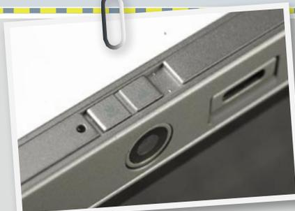
■ 2710p内置了130万像素摄像头, 不仅可以进行拍照、视频沟通, 同时配合内置软件, 可以实现对名片信息进行提取。
