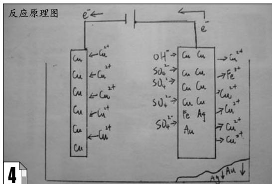
电极反应一: 阳极  $\text{Cu} - 2\text{e}^- == \text{Cu}^{2+}$
