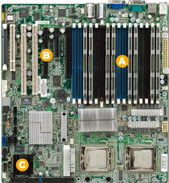
Tempest i5400PW (S5397)主板采用Intel 5400芯片组,包括Seaburg北桥和6321ESB南桥。其最大的特点是支持1066/1333/1600MHz FSB的最新英特尔Xeon处理器,并且内置了FB-DIMM内存控制器。值得注意的是,该主板的供电部分设计有24Pin+8Pin+4Pin+4Pin的电源接口,少接一个都无法正常启动,用户选择电源时一定要注意。
