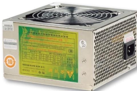
劲霸ATX-S410静音版是金河田最早上市的几款ATX12V 2.3版电源之一,额定功率为270W+30W,最大功率为400W。从功率来看,该电源应付中低端双核平台绰绰有余。但和其它ATX12V 2.3版电源不同的是,它只采用了单路+12V输
