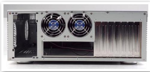
» 机箱后面的两个80mm风扇可以有效地加强整个机箱的内部散热,但全速时噪音较大,因此思民附送了一个减速线,可以有效降低噪音。
