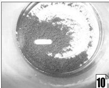
此时的铜很细,加热很容易与空气中的氧气发生反应(图9)。如果杂质氧化铜过多,自然是要影响导热效率。
