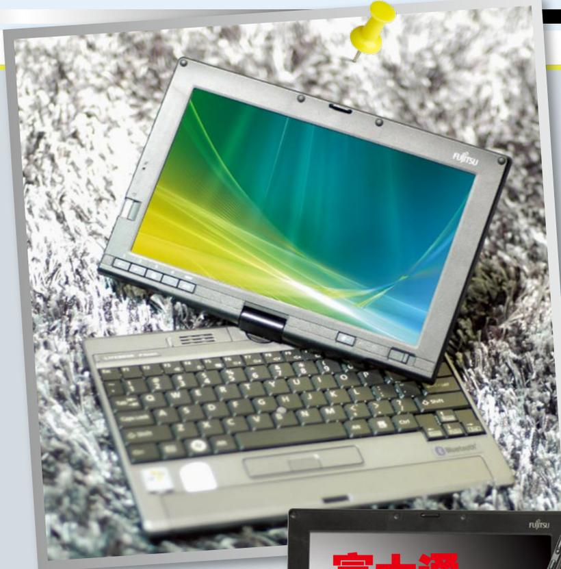
示屏的机型明显更加方便, 特别是需要为客户演示画面时更有优势。同时, P1610还在显示屏边框上设计了众多快捷功能键, 我们可以在平板电脑模式时方便地进行调整显示屏角度、调整显示屏亮度等操作, 并且由于电源开关键、状态指示灯和指纹识别器都集成在此, 进行开关机、登录系统等操作也很方便。
