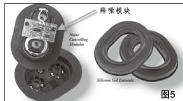
集和处理部分)。而降噪系统的实现方案一般有两种: 直接内置于耳机的耳罩当中和外置降噪系统。第一种方案, 降噪模块被直接放到了耳机的耳罩当中(图5), 通过电池进行工作(图6)。一般来说, 降噪耳机都设计了电源开关, 当安静环境下不需要使用降噪功能时, 直接关闭电源即可。但这样的设计有时稍欠灵活, 佩戴起来会让用户觉得头部有一定负担。而外置降噪系统的方案则相对比较灵活, 如图7所示, 降噪模块被设计到了线控装置中。这样用户就可以使用轻便的耳塞, 不仅减轻了头部负担, 而且佩戴也比较方便, 搭配MP3、MP4等便携设备非常理想。
