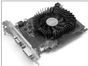
铭瑄狂猛HD2600PRO高清版显卡基于RV630显示核心，由4颗奇梦达1.4ns GDDR3显存颗粒组成256MB/128-bit显存规格，默认核心/显存频率为600MHz/1200MHz。该卡内置有5.1声道数字声卡，通过集成的HDCP密钥芯片，对HDMI/HDCP提供了支持，其市场售价为399元。
