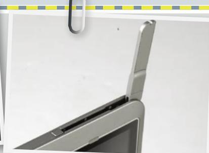
■ 可以从显示屏边框弹出的WWAN天线, 有助于更好地接受3G无线网络信号移动上网。
