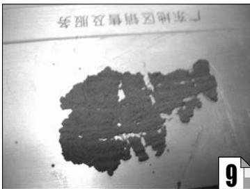
都失败了。可以将溶液倒出来,再加入大量水,溶解掉不溶物中的胆矾晶体。因为此时的不溶物是铜粉、金、银,都是导热效率好的金属。其中混合有未溶解的晶体,加入大量水溶解后再倒出,再加大量水,倒出。屡次反复,将不溶物洗干净。注意此时的水要用冷开水。取出铜,就可以进行下一步了。
