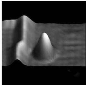
图7 STM拍摄的氮化铜表面上的单个铁原子
