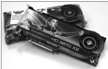
AMD在单块PCB上集成了2颗RV670显示核心的Radeon HD 3870 X2图形处理器一经发布，蓝宝石也随即推出了采用该显示芯片的旗舰级产品——HD3870 X2 1GB GDDR3双核心显卡。该卡搭载了1.0ns 三星GDDR3 1GB/512-bit显存，默认核心/显存频率825MHz/1800MHz，提供了双DVI+S-Video输出接口，其市场售价为3999元。
