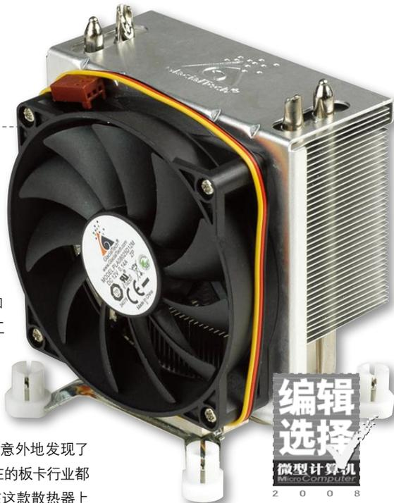
同样,在性能测试上,我们请出了发热大户——Pentium 4 Extreme Edition 3.73GHz。在不超频的状态下(室温21摄氏度),5610 Silent能够将满负荷运行的处理器温度控制在51°C左右,而使用作为对比的原装散热器时,其温度为61°C,作为一款两根热管的散热器来说,我们认为这个成绩算是相当不错的了,结果让我们基本满意。更重要的是,此时风扇的噪音非常小,静音的表现异常优异。
