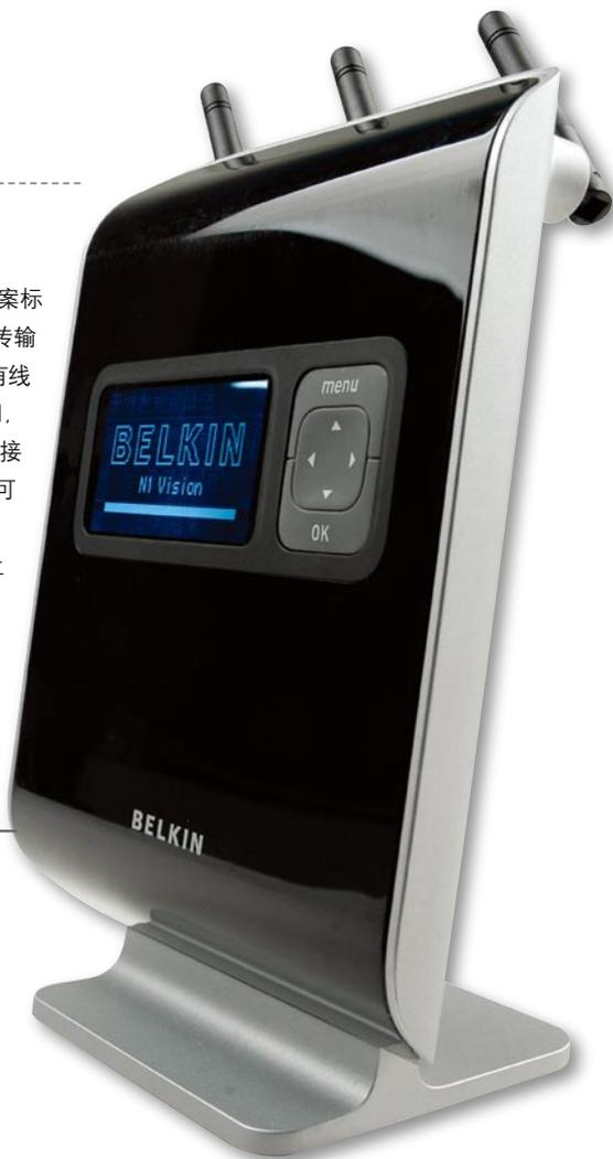
N1 Vision的显示屏能够显示多种网络信息,用户按无线路由器上的“左”、“右”键可以切换显示内容。
