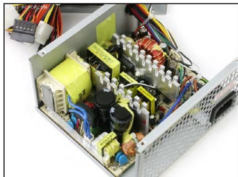
台稳定运行以及后期升级的顾虑。新款电源的额定功率仍然为300W,双路+12V输出可以分别达到18A,足以满足组建磁盘阵列的双核平台的供电需求,应付普通家用绰绰有余。作为一款静音版产品,该电源使用了噪音更小的12cm静音风扇,再加上智能温控电路,有效地降低了电源运行的噪音。但相对
