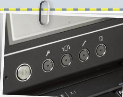
■ 显示屏下方设计了4个快捷功能键,能在平板电脑模式下更方便地进行设置和操作。
