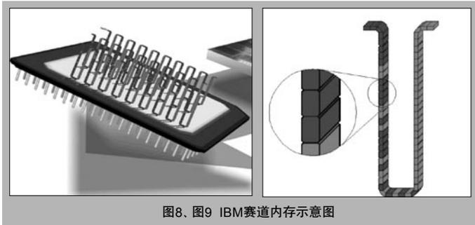
图8、图9 IBM赛道内存示意图
