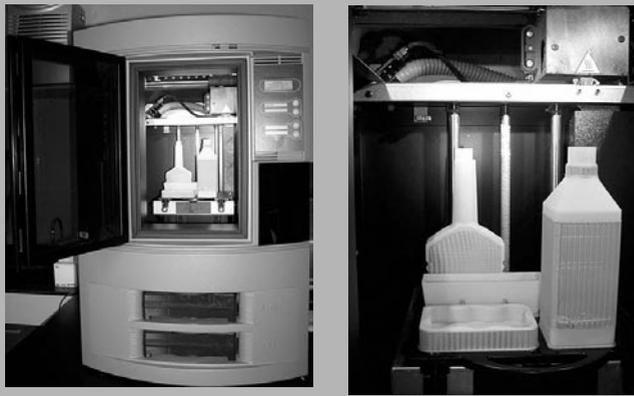
图4 Strataysys公司Dimension 3D打印机工作时的情景
