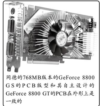
同德的768MB版本的GeForce 8800 GS的PCB版型和其自主设计的GeForce 8800 GT的PCB在外形上是一致的
