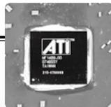
是Radeon HD 2600系列(RV630)的升级版。因此Radeon HD 3650与Radeon HD 2600系列一样,都具有120个流处理器、8个纹理单元、4个光栅单元。但由于Radeon HD 3650的核心制程升级为55nm,因此核心频率提高至725MHz,比Radeon HD 2600 Pro提高了20%。Radeon HD 3650标配128-bit GDDR3显存,频率为1600MHz,比Radeon HD 2600 Pro标准版提高60%,性能提升将相当明显,这也是目前Radeon HD 2600 Pro火速降价为其让路的原因。Radeon HD 3650的上市价格为599元,它将迎接数次降价后的GeForce 8600 GT的挑战。
