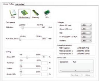
在驱动面板对处理器、GPU的频率,内存的SPD进行调节。
