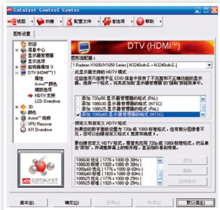
打开ATI催化剂驱动程序控制中心，进入DTV属性设置的“HDTV支持”，勾选“添加1080p60显示器管理器的格式(NTSC)”。然后从下方选中1080p标准格式，点击“应用格式”按钮就实现了1080p输出。
