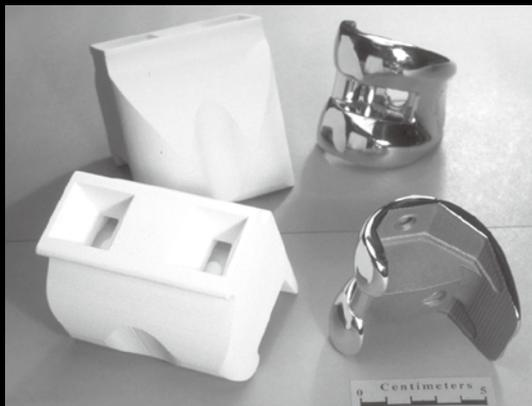
3D打印在医学上的应用。例如图中用3D打印机制作的陶瓷模具,右侧是用此模具灌铸然后抛光的整形外科用合金膝盖部件。
