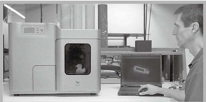
图3 将电脑中的3D设计输出至3D打印机
