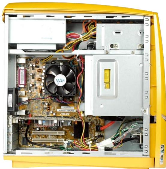
▲内部结构图: 打开侧板, 我们可以看到火影N3000的内部。尽管它的机箱尺寸并不大, 但内部空间也不拥挤, 走线和布局十分整齐。这款机型采用了华硕为同方OEM的ASUS M2N61-TVM/P/S主板、航嘉出品的大风车300W电源、ATI Radeon HD 2600 PRO显卡, 机箱上还配备了一个风扇协助散热。
