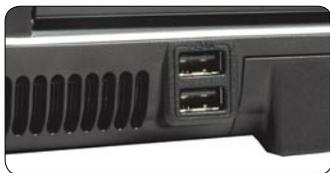
■ 后部的散热孔离USB接口较近, 可能会由于高热而影响到USB设备, 并且USB接口上下重叠, 使用不方便。
