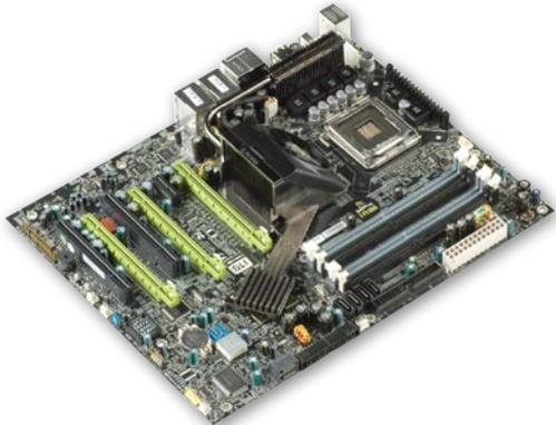
采用公板设计的nForce 780i SLI主板,它的布局和nForce 680i SLI类似,在北桥散热片下面同时覆盖了SPP和nForce 200芯片。根据我们以往的经验判断,今后市场上的nForce 780i SLI主板大多数都是采用“Design by NVIDIA”的公板方案。
