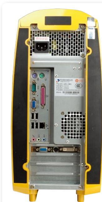
▲背部接口图: 火影N3000提供了齐全的接口, 包括常规的PS/2鼠标键盘接口, 6个USB 2.0接口、网卡接口及5.1声道音频输入输出接口以及独立显卡所提供的D-Sub接口以及DVI接口等。
