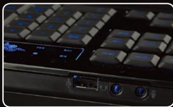
黑腹狼蛛键盘后部提供了耳机插孔、麦克风插孔和USB接口
