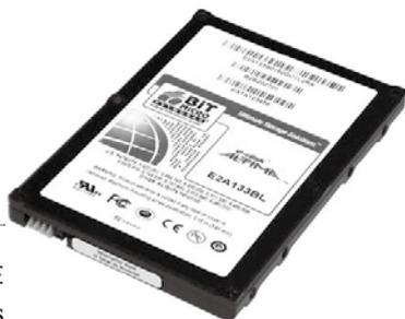
3 后起之秀的BiTMICRO公司则在展会上展出了采用SATA 3Gbps接口的2.5英寸固态硬盘。这款容量高达832GB的固态硬盘型号为E-Disk Altima E2A3GM,使用了多层存储单元(MLC)的NAND闪存,可带来比单层存储单元(SLC)更大的容量和更高的密度。新硬盘的稳定数据传输率可达100MB/s,每秒I/O操作20000次,各项特性都非常值得期待。
