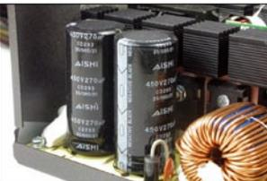
▲两个450V/270μF电容组成的高压滤波电路
