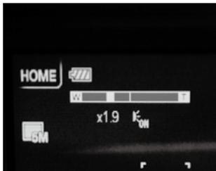
图1 W-T进度条中间的那根竖线实际上就是光学变焦与数码变焦的分界线
