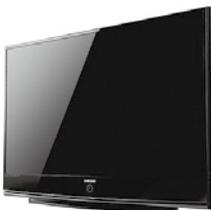
**2** 三星展出了自己的DLP光显背投电视。例如61英寸/67英寸采用LED光学引擎的HL67A750A,其寿命可以达到30000小时,可以实现1080p的Full HD以及3D视觉效果。
