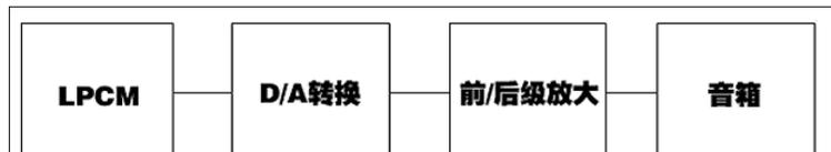
图16 LPCM音频输出示意图
