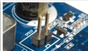
»从SPDIF In接入外部音频才能实现HDMI影音混合输出
