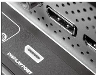
图2 Dell 3008WFP显示器的DisplayPort接口
