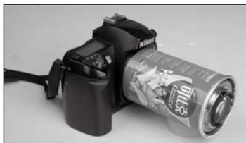
通过镜头盖,可以把改造完成的镜头套在机器上
