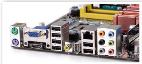
HDMI/HDCP:这是搭建HTPC的关键,英特尔整合图形核心的HDMI接口在安装好GMA驱动后,就可以实现音画同时传输,而且也可以调节过扫描。
