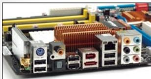
提供最全面的功能, 采用10相供电加全固态电容设计, 用料奢华。芯片组采用全静音的热管散热方式, 并特别为内存配备了专用散热模块。
