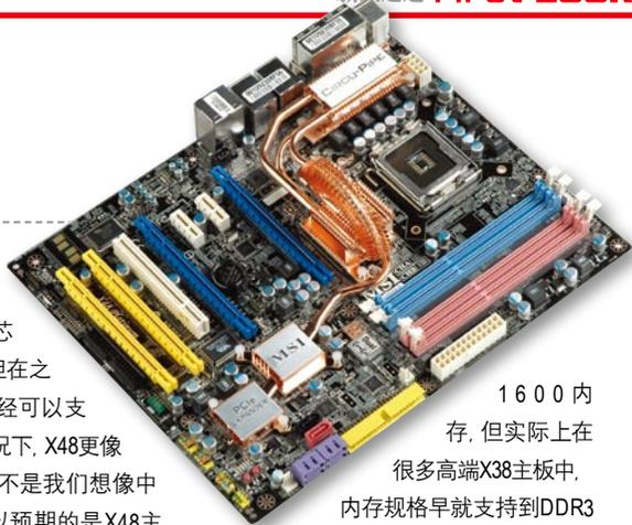
1600内存,但实际上在很多高端X38主板中,内存规格早就支持到DDR3 1600了,这就造成了两款产品的表现几乎完全一样。可能会有人说X48可以支持1600MHz前端总线,但实际上X38主板通过超频也能稳定运行在1600MHz前端总线下,而且实现并不困难。因此对于用户来说,他们将很难区分X38和X48。
