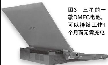
图3 三星的一款DMFC电池,可以持续工作1个月而无需充电
