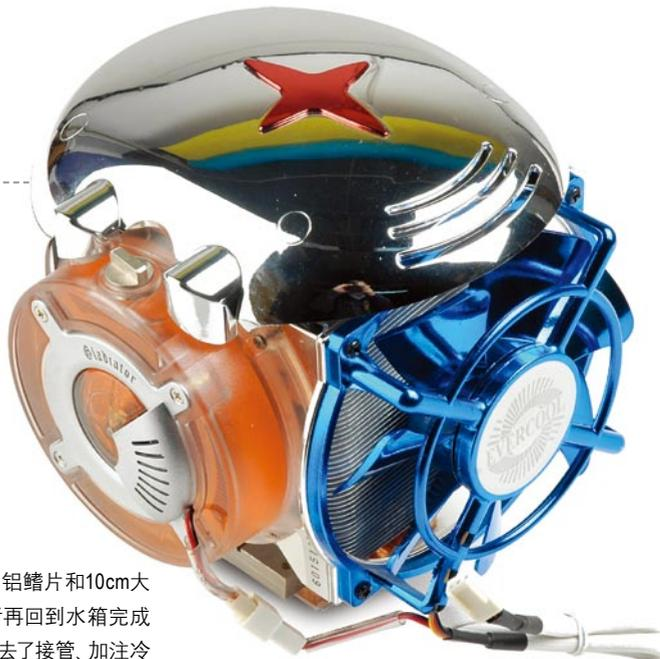
在评测中我们发现,银骑士2的重量和体积问题或许会给不少用户带来困扰。建议Micro-ATX板型主板的用户决定使用这款散热器时最好实际测量一下,因为很可能会和主板周边电子元件产生冲突。另外,建议用户使用时,最好用绳子通过悬挂的方式将散热器的部分重量分担到电源或者机箱上,以减小主板的压力。(夏松)
