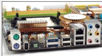
采用5相供电加全固态电容设计, 散热片采用全静音热管散热设计, 用料豪华, 做工优秀。
