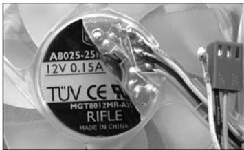
图15 对于风扇的改造,可以让风扇电机和LED分开供电。LED只用12V电压,永远发光。风扇电机可以随便调节电压,在制冷效果和噪音之间取得平衡。
