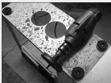
图3 为了简单,我只使用开孔器开了圆孔,速度很快,大概一分钟完成一个,而且还特别圆。手工开方形孔是非常费时间的。同样效果的散热透光,我选择了前者。大家也可以根据自己喜好,按照既定方案开孔。注意,开孔前最好把开孔器放在水里浸湿,这样可以降低在开孔器在高速转动过程中产生大量的热量带来负面影响。
