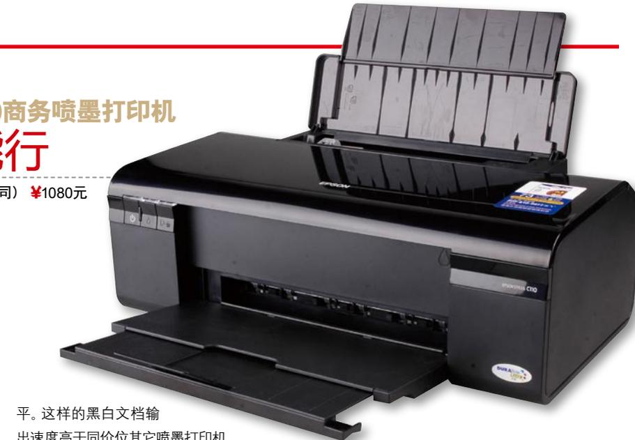
平。这样的黑白文档输出速度高于同价位其它喷墨打印机，甚至要快于部分激打产品，就速度来看已经足以取代黑白激打。之所以能够以千元价位的喷打产品实现如此高的黑白文档输出，全赖C110配备的“Bi-ink双黑墨打印头”技术，拥有两排共360个黑色喷嘴同时工作。这一技术实现了黑白打印速度近乎倍增的效果，需要两支黑色墨盒同时供墨，因此C110采用了2黑3彩共5支墨盒。
