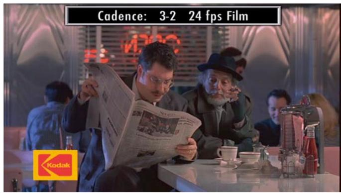
▲ 两款产品均通过3:2 PullDown测试,报纸和杯缘显示正常
