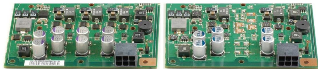
▲GeForce 8800 GTS的核心供电在GeForce 8800 GT的基础上增加了1相,达到3相。
