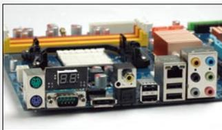
采用四相供电加全固态电容设计, 通路品牌中的高端产品, 接口丰富, 设计了两根PCI-E x16插槽。
