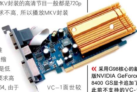
采用G98核心的新版NVIDIA GeForce 8400 GS显卡追加了此前不支持的VC-1高清视频全程硬解码,高清爱好者请密切关注下期高清实验室的相关报道。
