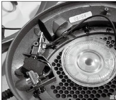
图1 动圈式耳机的内部构造
