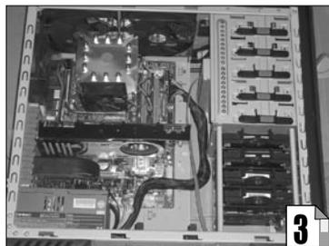
线。不使用底部风扇的话也可以直接采用电源和硬盘架之间的空间(如图2)。对于普通布局的机箱+大风车电源的配置来说,我建议利用电源和光驱之间的空位。但如果使用了8cm风扇的电源、超长电源,或者机箱顶部有风扇排风的机箱,为了不影响风道,建议把光驱安排在第三个5寸设备安装槽,使用光驱上方的空间进行藏线。
