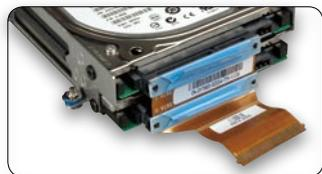
■ 两块硬盘重叠设计,已经接好RAID 0排线。
