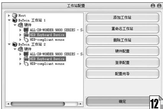
在主机上打开BeTwin,点击“工作站配置”,在弹出的窗口中可以看到当前分配给各个子系统的硬件状态,并可以修改配置(图12)。如果需要终止工作站电脑或增删硬件,可以选择“选项”中的“设置配置”,选择“禁用BeTwin”并重启系统即可。选择“用户”下的“统计信息”可以看到当前系统状态和硬件资源的分配情况(图13)。
