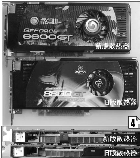
新旧公版散热器尺寸对比,改进后的散热器结构设计更为合理。
