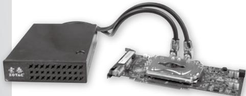
GeForce 8800 GT公版散热器的散热能力不强为玩家所诟病。索泰冰铠士水冷版GeForce 8800 GT采用水冷散热的形式,相对风冷散热器,无论是散热能力还是静音都非常不错。由于用了一体化设计,水泵、水箱以及散热模块被集合在一个塑料外壳,大小刚好为5.25英寸,可以安装在机箱的光驱槽位置,不仅方便还不占用过多空间。该卡依然采用了公版设计,预设频率较公版更高,其核心频率、显存频率达到了700/2000MHz,采用512MB/256-bit/GDDR3显存。目前该显卡售价为2499元,追求极致散热的朋友不妨考虑。
