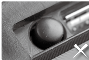
正品的Power键采用铝合金材质,而假货的Power键为劣质塑料。
