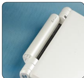
■ 大容量电池的体积较大, EeePC将电池上部设计成屏幕转轴的一部分, 巧妙地利用了空间。
