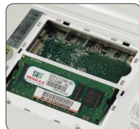
■ EeePC采用了常见的SO-DIMM内存, 不过只有一个内存插槽。另外, EeePC还预留了一个PCI-E插槽以扩充功能。
