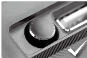
正品的Power键采用铝合金材质,而假货的Power键为劣质塑料。
