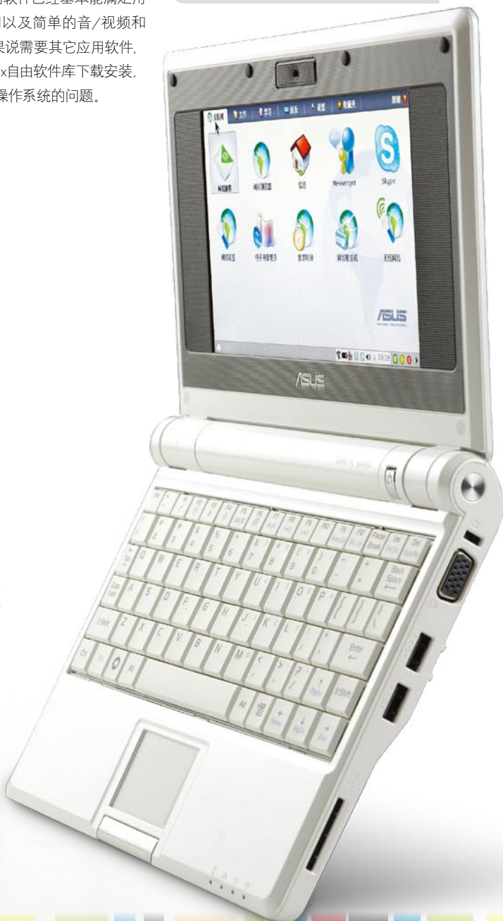
■ 显示屏上方内置了30万像素摄像头, 搭配位于机身前端的内置麦克风, 可以实现网络视频聊天。
