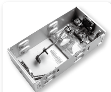
▲网牛PDD-LAN的内部结构,蓝色橡胶垫圈可以为硬盘减震。
