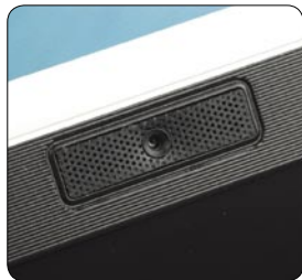
■ 显示屏上方内置了30万像素摄像头, 搭配位于机身前端的内置麦克风, 可以实现网络视频聊天。
