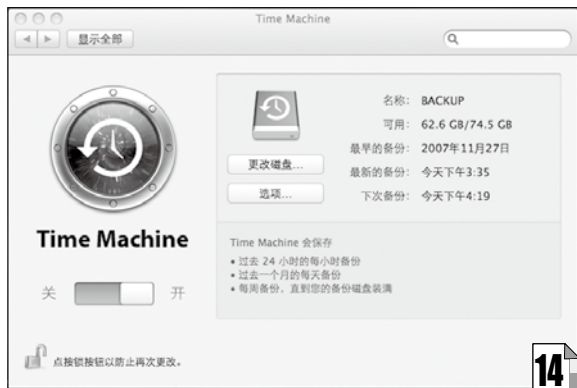
图14 必须要检测到外接硬盘或者额外的磁盘分区时,TimeMachine才会启动工作。
