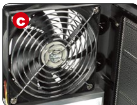
▲机箱后方预留16cm大直径静音风扇
