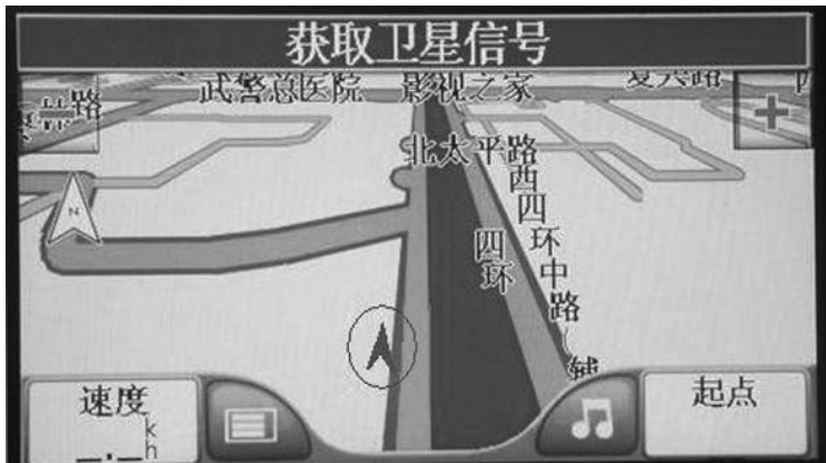
图11 GPS设备上的“漂移”现象
