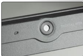
■ HP620内置了130万像素摄像头和双麦克风 (位于显示屏边框右上方和右下方), 为网络视频聊天提供了方便。
