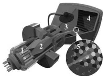
CRT显示器结构(1.电子发射阴极; 2.磁片线圈; 3.偏转电场; 4.荫罩; 5.像素点), CRT的成像原理决定了它没有“物理分辨率”, 所能支持的图像只取决于电子枪和带宽。
