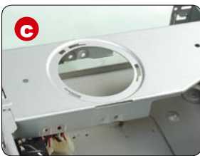
▲用于加强整体结构的支撑架
