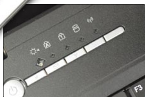
■ 位于键盘左上方的功能快捷键使用方便, 状态指示灯左边是光线感应器, 它能根据外部光线的强弱自动调整显示屏亮度。
