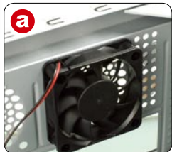
▲确保散热的8cm风扇及风扇位
