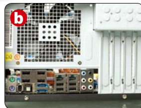
▲主板接口上方预装静音散热风扇
