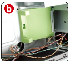
▲此处的塑料支撑架有利于形成散热风道
