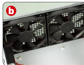
▲侧面预装可调速散热风扇
