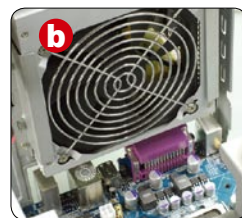
▲电源风扇正对处理器位吹风,有利于散热
