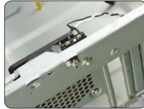
▲留意此处的防盗设计,在主板进行相应设置后,打开机箱会自动报警
