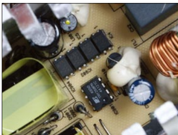
▲型号为K650 TNY268PN的IC芯片,可以令电源的待机功耗小于1W
