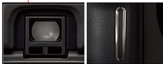
■ 握持传感器和取景框上的眼控感应器一起组成了α系统独有的眼启动系统。
