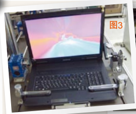
图3: 这是正在进行的开合测试, 测试笔记本电脑的转轴是否合格, 开合次数要达到6万次, 需时11天。
