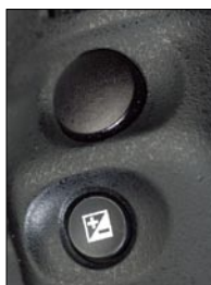
■ 握柄食指位上的前拨轮、快门键和曝光补偿键。快门键的键程较长,二段式触感并不理想。
