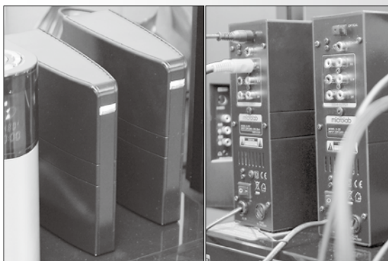
↑麦博即将推出的硬件纯解码器D-150,其背板上提供了光纤和同轴数字输入接口,当数字音频信号通过解码器硬件解码转换为模拟信号后,会从模拟信号输出口传输到多声道音箱上。
