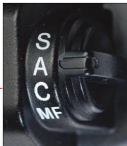
■ 对焦模式旋钮。手动对焦(MF)、单步自动对焦(AF-S)、连续自动对焦(AF-C)和自动对焦自动选择(AF-A)4种对焦模式。
