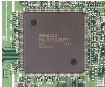
▲ 使用的瑞萨R8J32702SFPV主控芯片实现了多种格式的解码和纠错。
