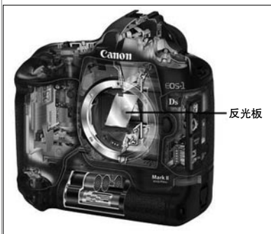
单反相机中的反光板
