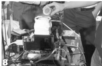
图8 往容器里倒液氮的时候可得小心了,这东西洒一点点在手上会让你知道什么叫做“霜寒刺骨”。
