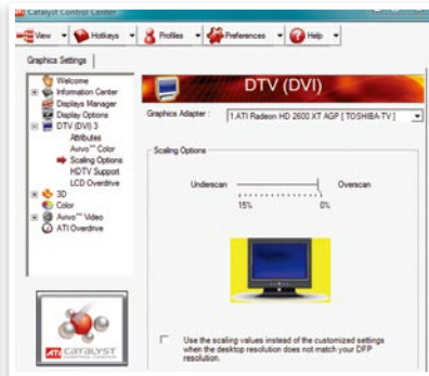
▲ 驱动程序面板中的Scaling Options缩放选项功能可以使用户轻松解决欠扫描和过扫描问题
