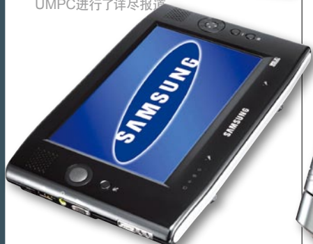
2006年8月上市的三星Q1搭配了7英寸显示屏、超低压版Celeron M处理器、512MB内存、40GB硬盘和Windows XP Tablet Edition操作系统,采用指点杆加虚拟键盘的输入方式,是第一代UMPC的典型代表。
