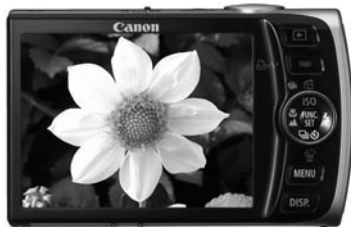
液晶屏取景其实是用液晶屏回放感光元件所搜集到的图像
