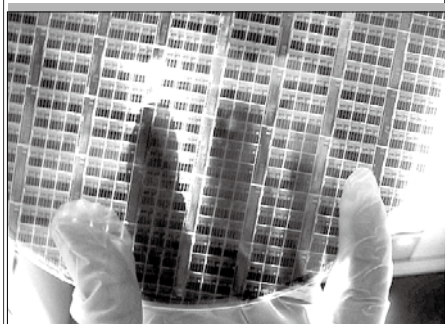
图8 IBM采用TSV技术制成的超薄型晶圆样品
