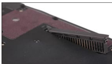
》S6410特色的皮革隔热垫以及散热过滤器
