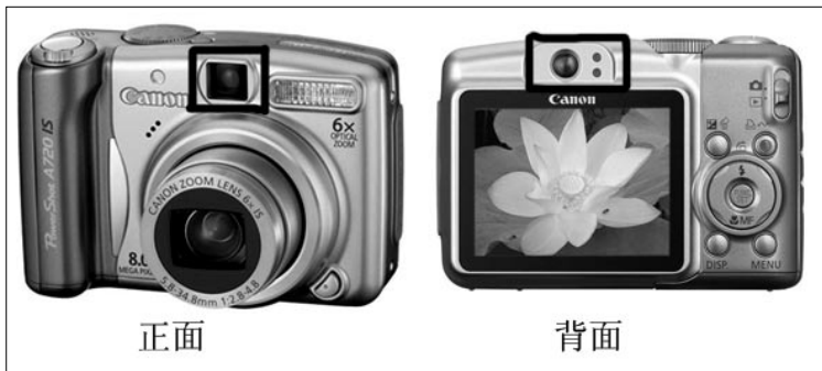
数码相机的光学旁轴取景器
