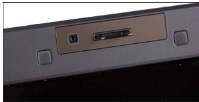
▶▶S6410的130W像素的摄像头,支持面部追踪技术。旁边的卡榫较高,可以起到稳定和牢固锁位的作用
