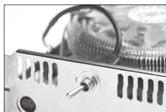
▲只需简单地将开关拨向Turbo即可享受极致的超频效果
