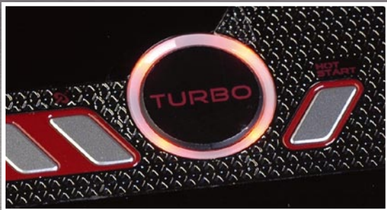
桔黄色的圆形LED灯可以直观地显示超频状态。
