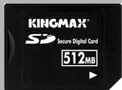
图3 KingMax采用PiP封装的SD存储卡
