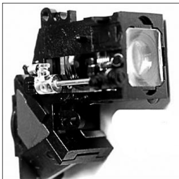
数码相机光学旁轴取景器的结构
