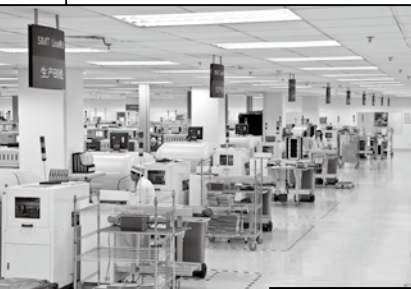
内存模组表面贴片-SMT生产线
