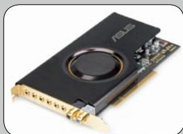
▲ 装上屏蔽罩的Xonar D2, 看起来颇像一块显卡。
