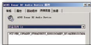
▲注意设备驱动信息中我们用方框标记出的字段, 这表明AV200就是C-Media出品的CMI8788多声道音频处理器。
