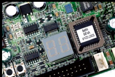
板载DEBUG灯和开关按钮, 操作起来十分方便。
