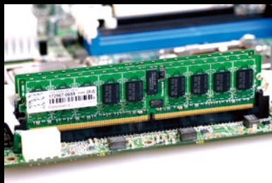
双通道DDR2 667 Registered DIMMs内存, 最大16GB。
