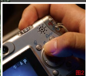
图2 佳能A系列机型上的曝光补偿按钮,这个按钮在中高端DC和数码单反上很常见。
