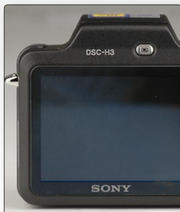
▶ 11.5万像素的2.5英寸液晶屏, 液晶屏上方是照片回放按钮
