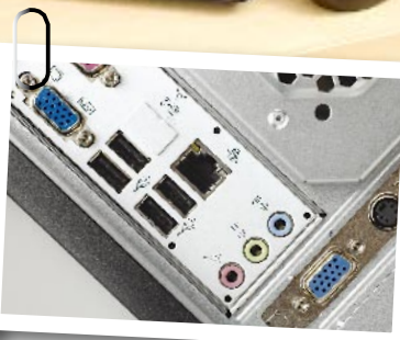
▲整合主板搭配独立显卡,所以可以看到两个D-Sub接口,很多品牌都如此搭配。
