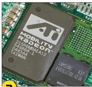
a 龙芯产品使用的是Radeon 7000-M显卡,与之搭配的是一颗三星K4D263238E-GC36显存颗粒(16MB DDR显存颗粒/275MHz),出于控制成本的考虑只搭配了一颗。
