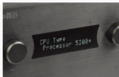
▲iMON VFD显示屏除了能够显示硬件信息, 以及CPU、内存占用率外, 还可以显示播放视频、浏览新闻、收听广播等系统当前状态。
