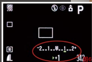
图6 图中红圈中的游标处在+1档的位置,这样画面的曝光量就增加1EV值。
