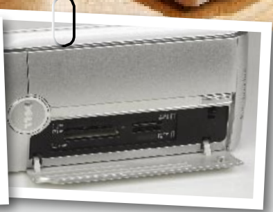
▲两个挡板下分别是DVD COMBO和读卡器, 平时可以挡起来避免灰尘侵入。
