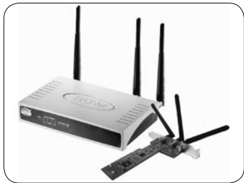
使用MIMO(多路输入输出)设计的路由器, 往往不止一根天线; 有的天线用于接收, 而有的则用于发射。
