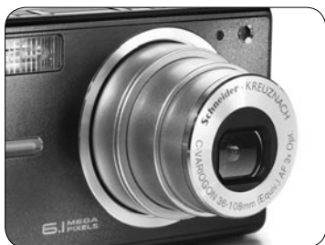
注意检查镜片上是否有划痕、指纹印以及灰尘,选择多级变焦相机的朋友还要注意检查镜头是否有机械故障。
