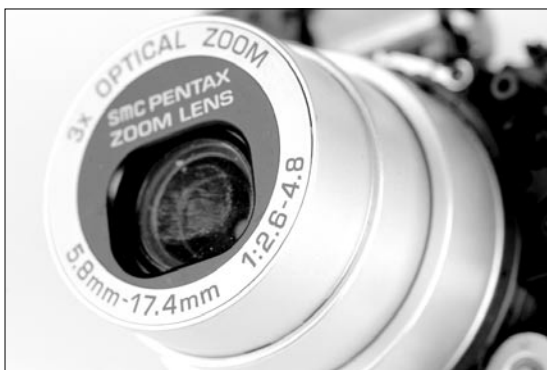
图13 此镜头上标注的“1:2.6-4.8”就表示了其镜头在广角端的最大光圈为2.6，望远端(或称长焦端)为4.8。
