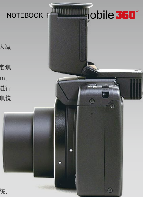
▲ VF-1可进行90度垂直取景
