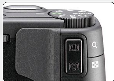
▲ GX100的变焦按钮为垂直方向设计, 旁边还留有一块树脂材料覆盖的区域供拍摄时拇指摆放, 增加握持稳定性。
