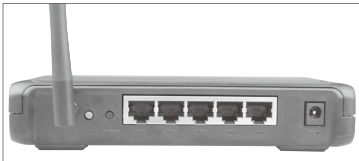
▲WL-520gC的背面板,具有一个WAN口、四个LAN口、reset按键和电源接口,标配2dBi可拆卸天线一根,还有华硕独有的EZsetup按键(红色),帮助新用户快速安装和加密无线网络。
