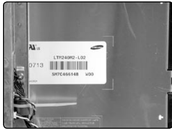
长城V247确实采用的是三星产S-PVA面板
