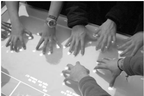
图8 Surface电脑可以对多达52个触摸点作出反应
