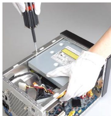
▲ Step 8.以同样的方法将光驱固定在驱动器托架顶部
