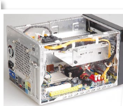
▲ Step 2.松开机箱尾部螺丝,卸下外壳。
