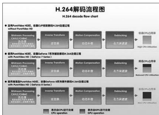
图8 流程图当中的四个方块基本就是H.264解码的四个最重要步骤,也是资源耗费最为严重的四步。
