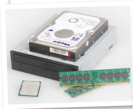
▲ Step 1.准备好处理器、内存、硬盘和光驱(黑色面板的光驱与机身最匹配)。
