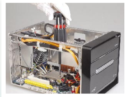
▲ Step 4.松开散热底座四角的螺丝,取出整个散热模块。
