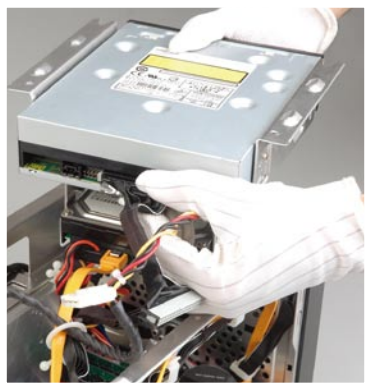
▲ Step 9.为硬盘和光驱接上数据线和电源线
