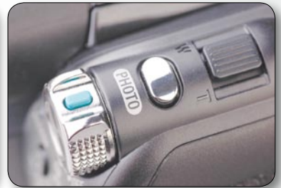
▲手拨式电源开关, 比较正统的SONY化模式。顶部的两个按钮就是静态拍摄时的快门开关和距离调节旋钮, 这样的设计可以方便你在录像的同时轻松地拍摄照片。
