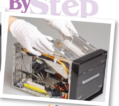
▲ Step 3.卸下驱动器托架固定螺丝,取出驱动器托架。
