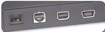
▲ 底座上包含了各种接口,其中就有与电脑连接的USB接口,此外还有输出到显示设备的分量输出与AV输出接口。
