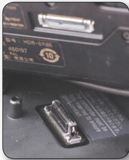
▲ 底座与机身的连接十分简单,三个定位柱+一个数据接口,注意在使用的时候确保数据插座与机身结合紧密,否则可能出现各种读取错误。
