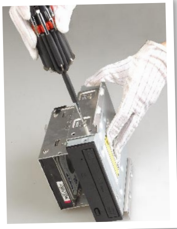
▲ Step 8.以同样的方法将光驱固定在驱动器托架顶部
