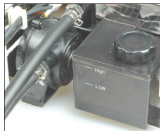
▲水箱和水泵,注意水箱的液面指使线,水箱中的最终液面位置不要超过“High”。
