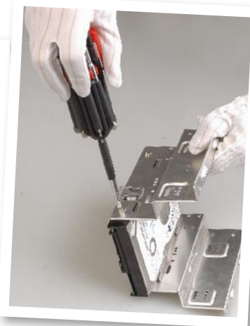
▲ Step 7.用螺丝将硬盘固定在驱动器托架底部
