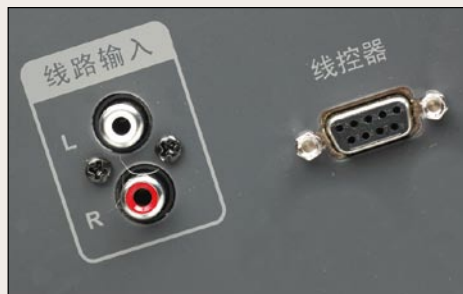
▲低音炮背部提供了一组RCA输入接口, 一个DB9线控器接口
