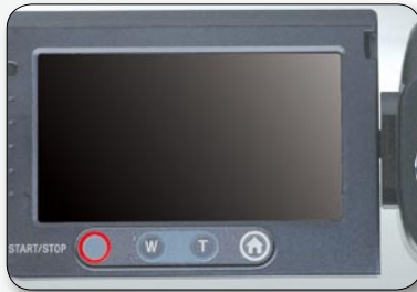
▲2.7英寸的混合宽屏液晶显示屏, 主要操作和各项设定都要在这个屏幕上完成。当然, 它是触摸控制的, 十分方便。另外, 你还可以将屏幕随意旋转特定的角度, 以方便不同的拍摄需要。
