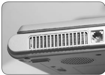
铜质的散热排位于笔记本电脑内部,不打开计算机很难翻新;同样的,只要用过的散热排,绝对不会是原始的亮铜色。
