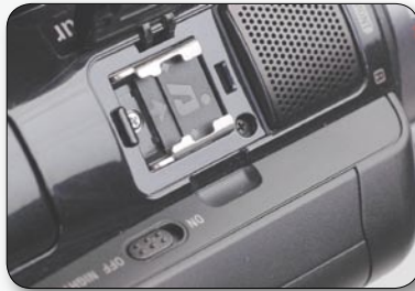
▲Active Interface Shoe多功能接口可外接闪光灯等各种附件。当某些时候想将SR8E当作DC使用时, 就可以在这儿挂上一个准专业闪光灯, 以达到更好的拍摄效果。
