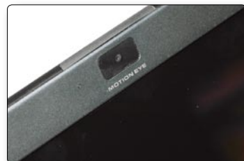
新增的30万像素摄像头, 由于采用了Chip ON Board封装工艺, 最终TZ的顶盖厚度保持在4.7mm, 仅比TX厚0.2mm。
