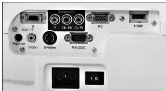
图6 家用级投影机上的外围接口与传统的商用机有很大区别,如HDMI接口。
