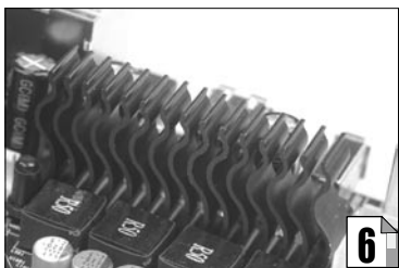
6 不只是南北桥芯片,CPU插座左边电子元件的散热也非常重要。比如MOSFET管,往往高端主板都会给其加上散热片以提高稳定性。
