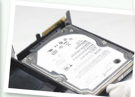
▲ 硬盘位就在光驱位下方, 可以一起固定在金属顶盖上的。
