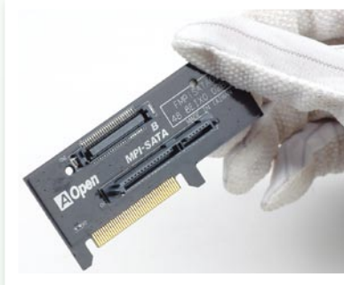
▲ 硬盘怎么会是这种接口? 当然不是, AOpen非常巧妙地设计了一个MPI-SATA硬盘转接卡, 转接卡本身带有SATA接口和供电接口。
