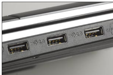
▶▶华硕X50R机身左侧的3个USB接口间距较大,不会造成冲突。
