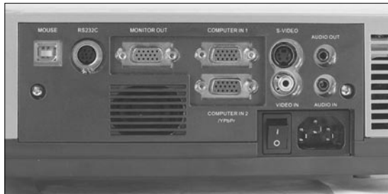
图3 专业级产品背后的接口,而普通民用级产品往往只有一组VGA和色差输入端口。
