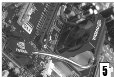
5 这款主板的北桥风扇出风口正对CPU,正好可以配合CPU散热器和机箱风扇在机箱内形成良好的风道,从而提高散热效率。
