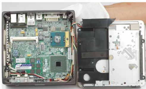
◀ miniPC Duo机箱内部的左边是需要自己添加设备插槽。这里我们已经插上了两条笔记本电脑内存, 上方是笔记本电脑用的Mini-PCI插槽, 可以选配笔记本电脑用无线网卡或者电视卡, 最上方的接口则是为硬盘准备的。
