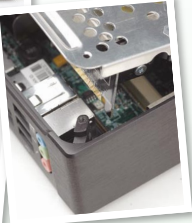
▲ 所有配件安装完毕后, 盖上金属顶盖部分, 将MPI-SATA硬盘转接卡插入插槽。
