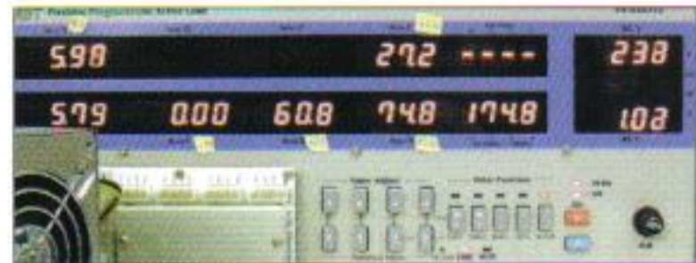
STEP1 将电源的各个接头连接到负载接口面板(此产品的+5V、+12V、+3.3V、-12V、+5VSB的标称输出电流分别为：20A、10A、14A、0.8A、2A)
