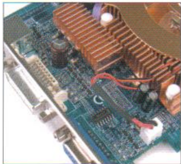
用于提高 2D 显示画质的低通滤波电容一应俱全
