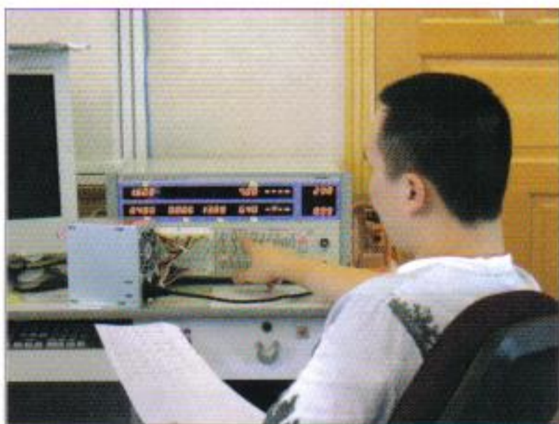
STEP2 进行60%负载状态的测试，将输出电流调节到基础标称值的60%
