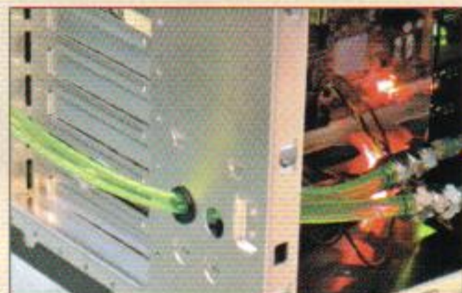
机箱的液冷管穿出孔： 机箱上预留了液冷管的插接孔，无论是安装“Bigwater”还是安装其他液冷系统都十分方便。
