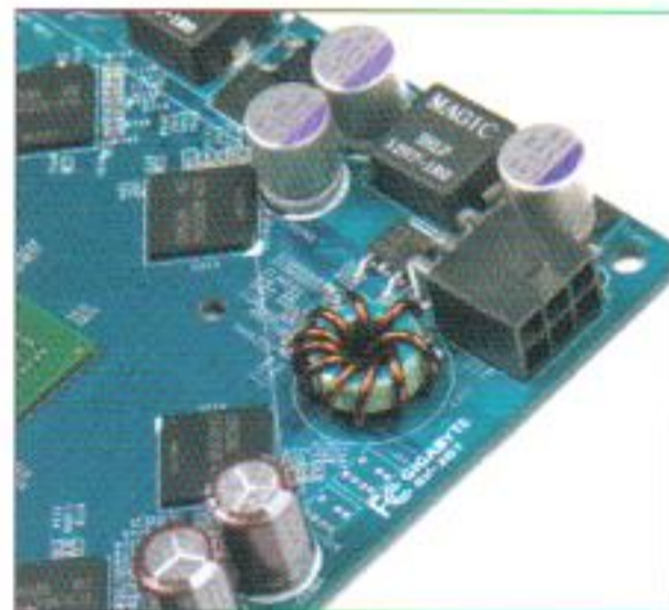
6 Pin 的显卡额外供电接口和为显存供电的相关电路模块
