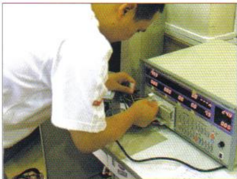
STEP1 将电源的各个接头连接到负载接口面板(此产品的+5V、+12V、+3.3V、-12V、+5VSB的标称输出电流分别为：20A、10A、14A、0.8A、2A)
