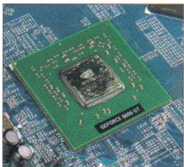
内部的确是 NVIDIA GeForce 6600 GT 核心
