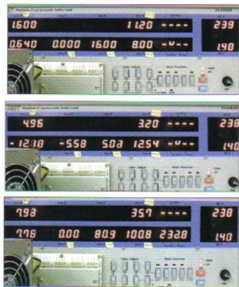
● 被测电源通过了80%负载状态测试，测试员正在增加负载电流值，准备向100%冲击。
