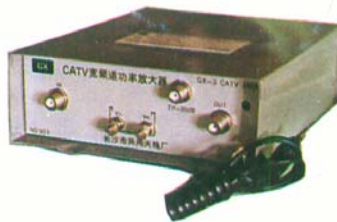
GX-1, GX-3 型 550MC 放大器:增益 40dB,作线路放大和用户放大,最大输出电平 115dB,价格为 400 元和 340 元。
