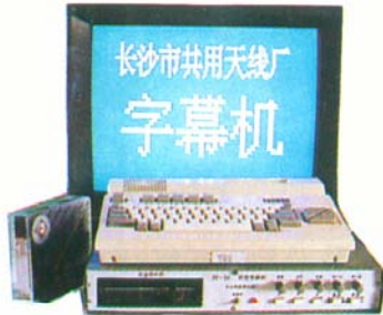
GX-54 字幕机:有播放台标,时标,飞字,走字字幕特技,字色、底色可变更等多种功能,有 70 多个程序。价格:4800 元。
