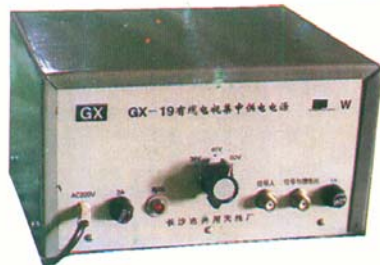
GX-19 有线电视集中供电电源:能将 220V 电压转换成 36-60V 低压,和电视信号混合后送入电缆线对各线路放大器供电,电压可调,功率 200W,价格 380 元。
