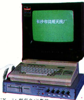
GX-54 型彩色字幕机, 用于闭路电视自编自办节目
