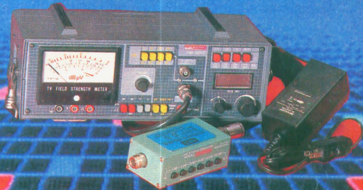
9C2组合式电视、广播FM、通信V、U段数字测频率多用场强仪(进口主机)。
