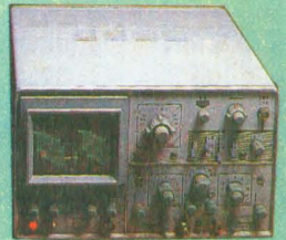
● SR-8 双踪示波器 DC-15MHz 特点: 本仪器系 PAL 彩色电视制式的专用测量仪器。
