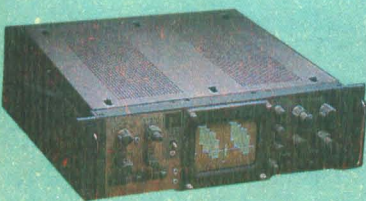
● DC5440 波形监视器 特点: 具有测量精度、亮度显示, 双通道测量, 场行高倍扩展, 精密选场选行波形叠加等功能。
