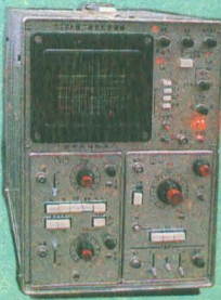
特点: 具备记忆、可变余辉及常规显示三种功能。 带宽: \text{DC} - 5\text{MHz} - 3\text{dB} 灵敏度: 10\text{mv}/\text{div} - 20\text{v}/\text{div} \times 2
