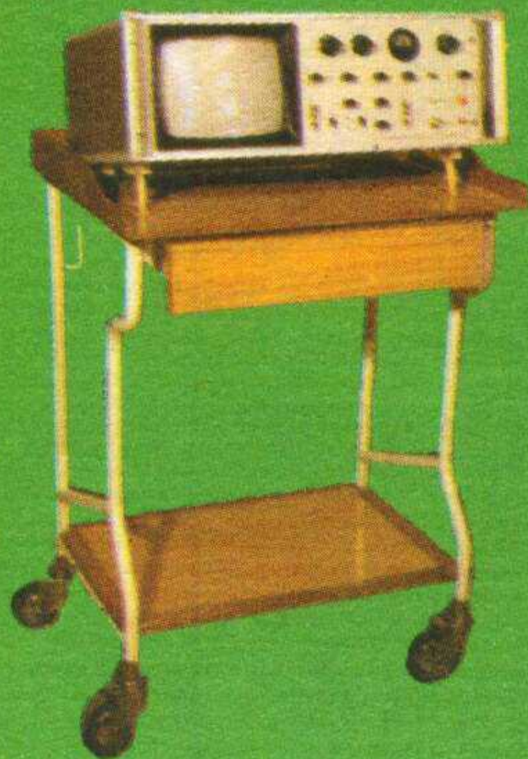
(上) QH473型话路频率特性图示仪
